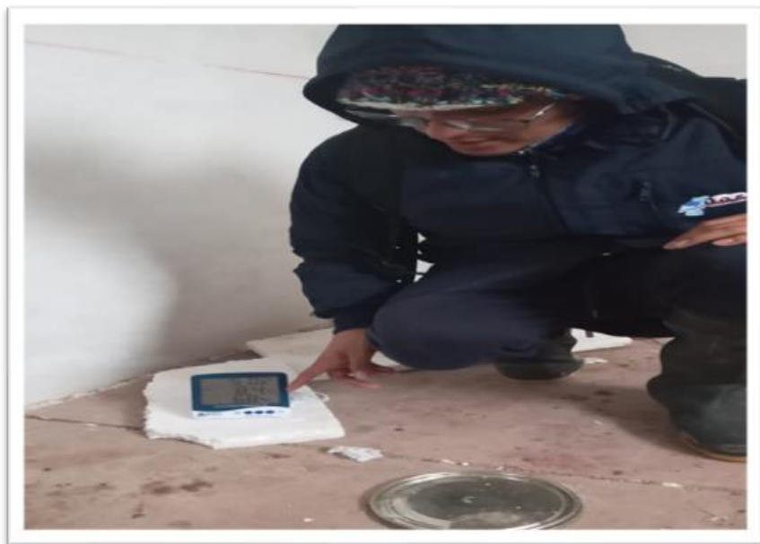
Imagen 16: Medición de la temperatura interna de la vivienda con incorporación del poliestireno
