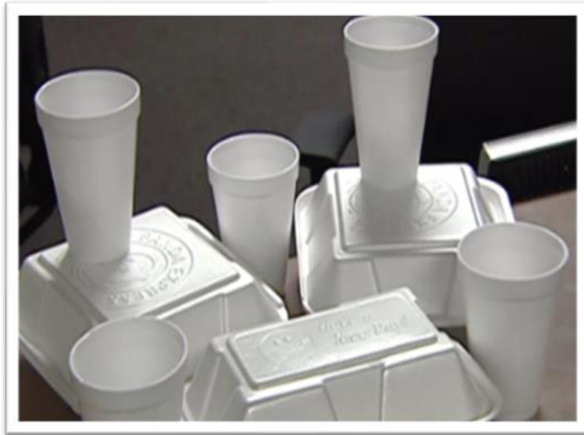
Imagen 5 el poliestireno es usado para el almacenamiento de alimentos o recipientes de comida.
