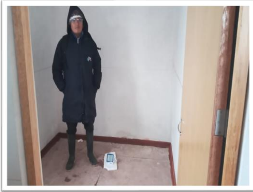
Imagen 16: Medición de la temperatura interna de la vivienda con incorporación del poliestireno
