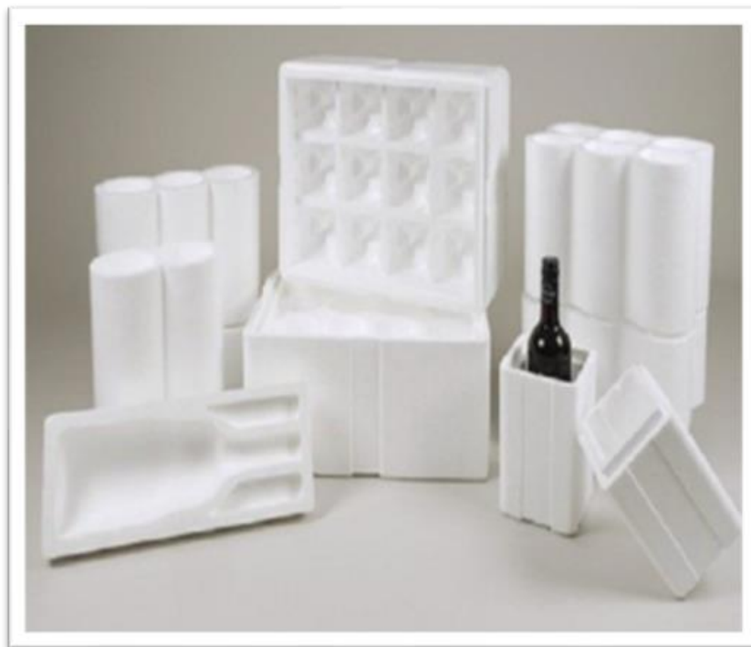
Imagen 6: el poliestireno es también usado embalajes de productos frágiles como electrodomésticos y aparatos eléctricos.
