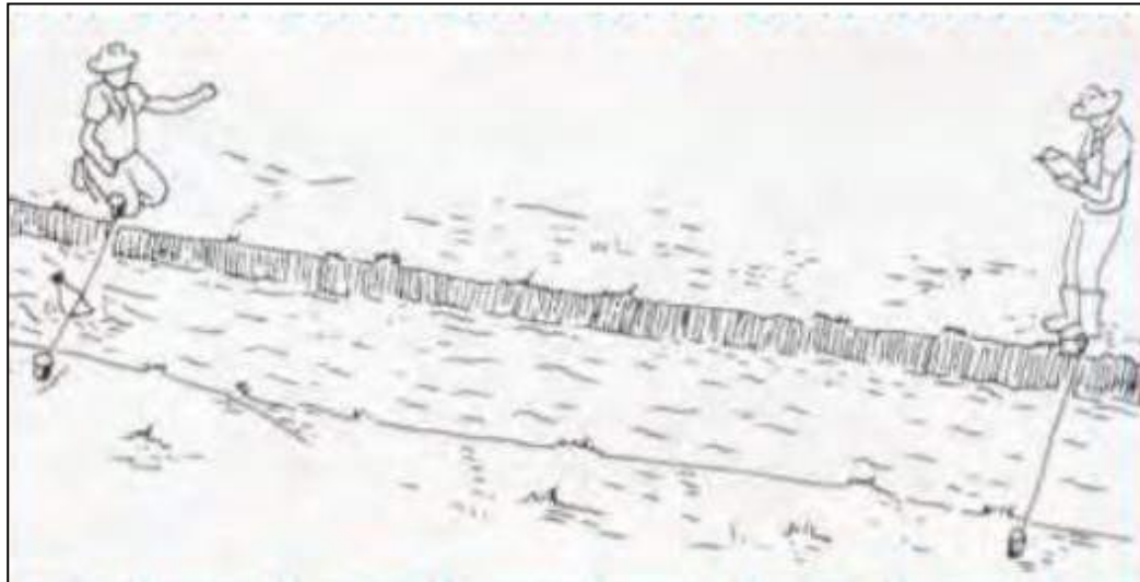
Figura 13. Método del flotador Fuente: (Ministerio de Agricultura y Riego, 2015)
