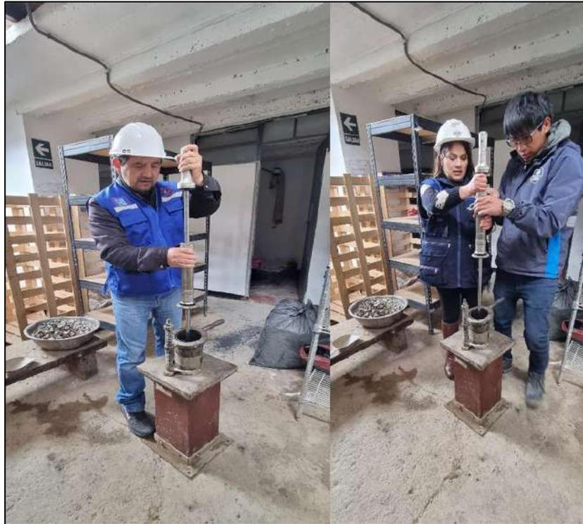
*Figura 24: Ejecución del ensayo Marshall*
