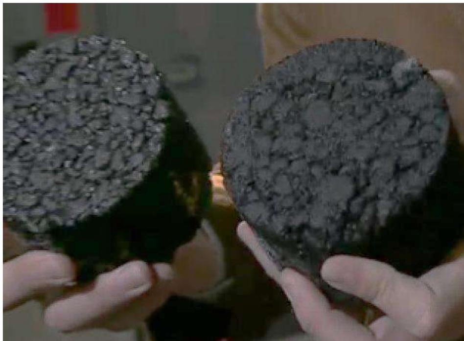
*Figura 4: Mezcla caliente con asfalto*
