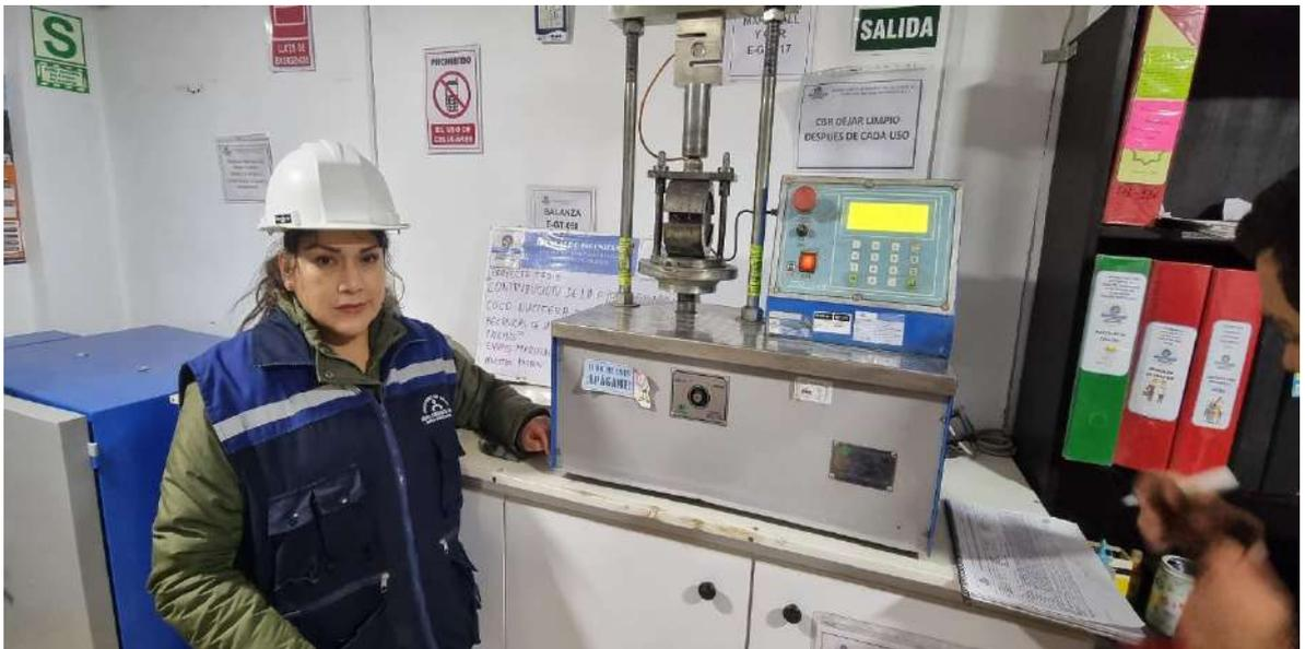
Prueba de rotura de las muestras Patrón
