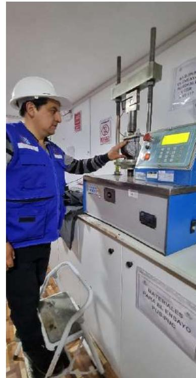
ROTURA DE ENSAYO LOTTMAN SOMETIDO A 60 GRADOS
