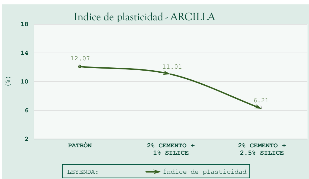
Figura 9: Índice de plasticidad de la arcilla, muestra patrón y muestra con cemento y sílice.
