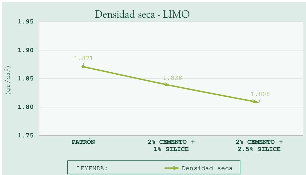
Figura 26: Densidad seca del limo, muestra patrón y muestra con cemento y sílice.
