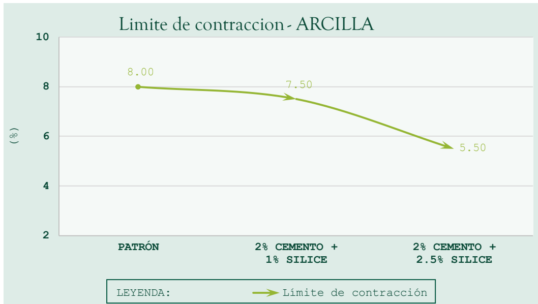
Figura 17: Límite de contracción de la arcilla, muestra patrón y muestra con cemento y sílice.
