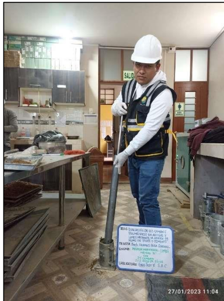
Fotografía N° 5: Compactación del material, dentro del molde en 5 capas, con 25 golpes, referencia de la norma MTC E 115.
