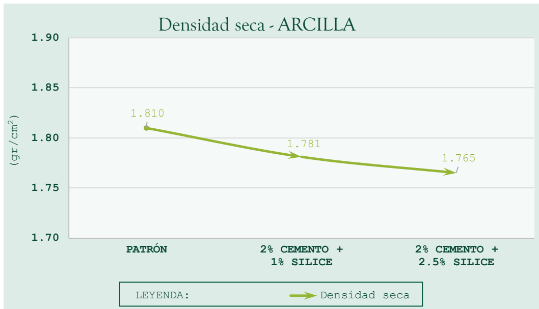
Figura 25: Densidad seca de la arcilla, muestra patrón y muestra con cemento y sílice.
