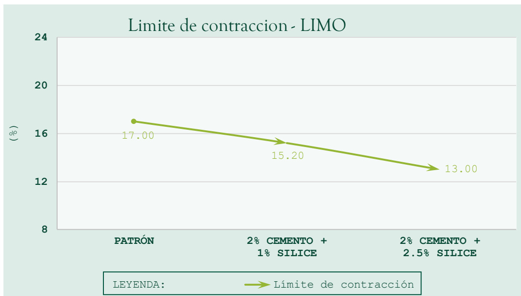
Figura 18: Límite de contracción del limo, muestra patrón y muestra con cemento y sílice.
