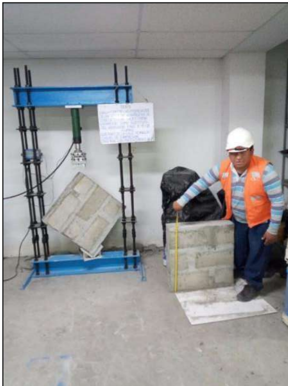
Fotografía 40. Ejecución del ensayo de compresión diagonal de muretes con 30 % de poliestireno expandido.
