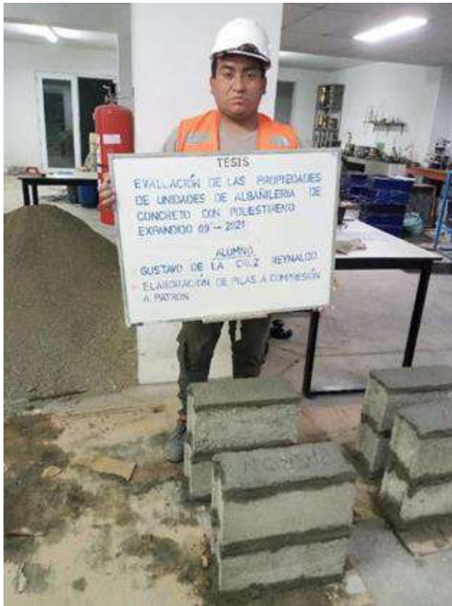
Fotografía 31. Elaboración de pilas con concreto patrón.
