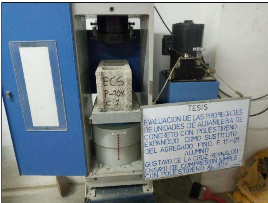
Fotografía 28. Ensayo de compresión simple en la unidad de albañilería con 10 % de poliestireno expandido.
