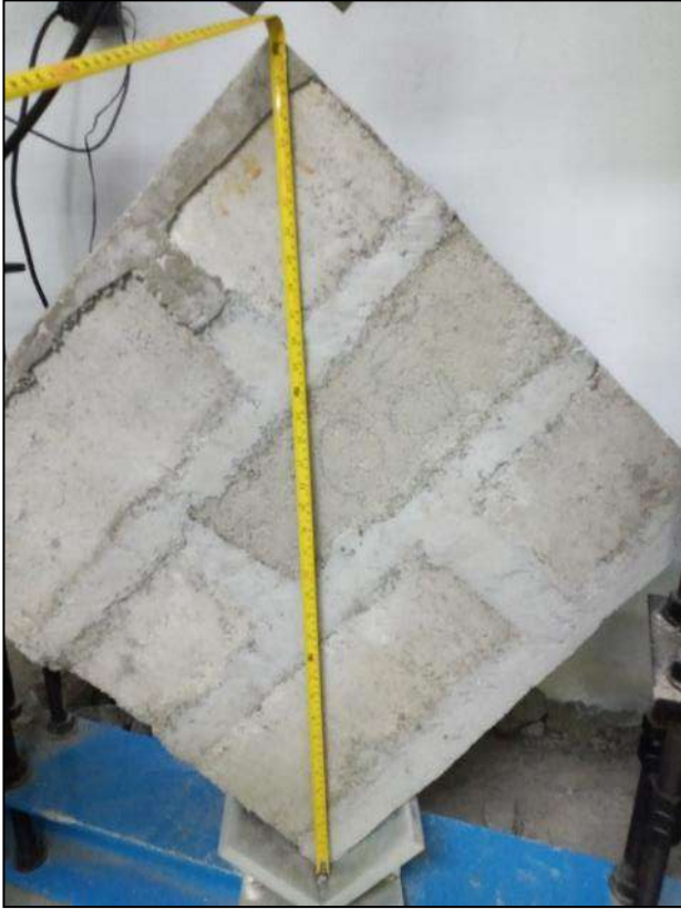
Fotografía 37. Determinación de medidas de los muretes.
