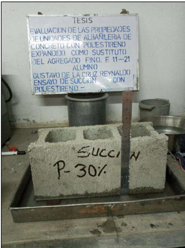
Fotografía 22. Ensayo de succión de unidad de albañilería con 30 % de poliestireno expandido.
