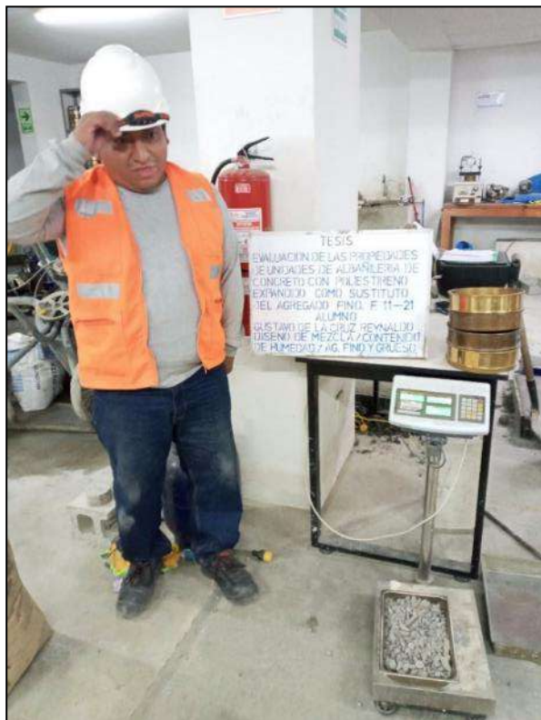
Fotografía 2. Ensayo de contenido de humedad del agregado grueso.
