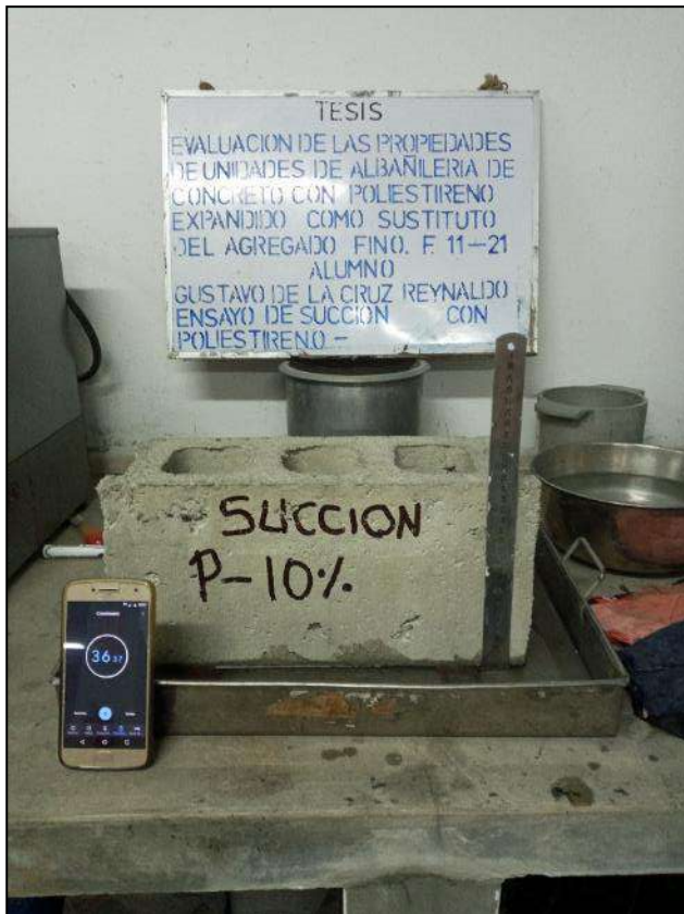
Fotografía 20. Ensayo de succión de unidad de albañilería con 10 % de poliestireno expandido.
