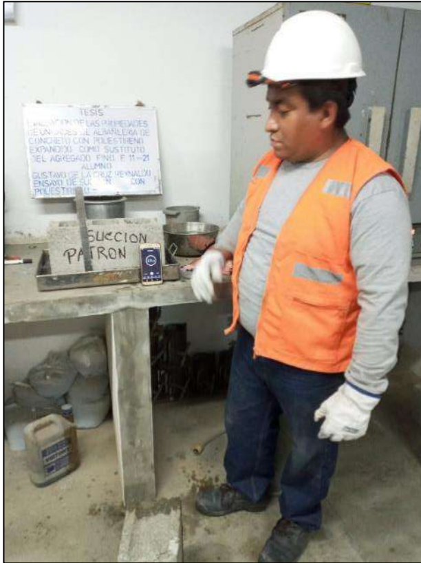
Fotografía 19. Ensayo de succión de unidad de albañilería patrón.
