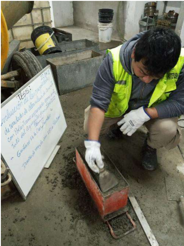
Fotografía 12. Elaboración de las unidades de albañilería con 10 % de poliestireno expandido.
