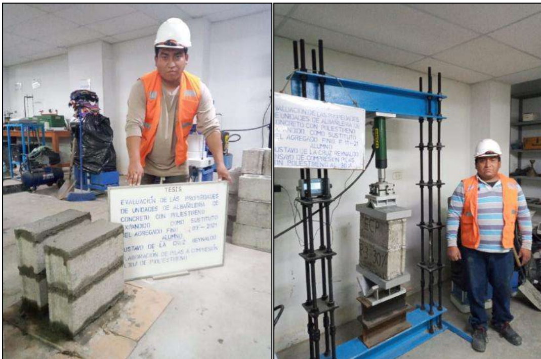
Fotografía 36. Elaboración de pilas con 30 % de poliestireno expandido y su ensayo correspondiente.
