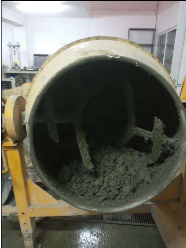
Fotografía 9. Preparación de las mezclas de concreto.
