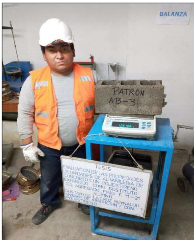
Fotografía 18. Pesado de unidad de albañilería patrón después de estar sumergida para determinar la absorción.
