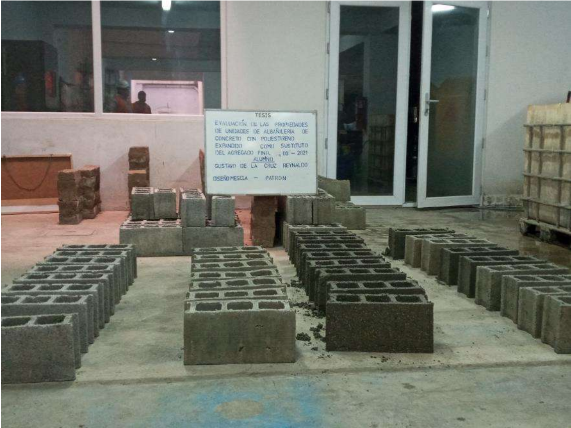
Fotografía 14. Vista de las unidades de albañilería con concreto patrón.
