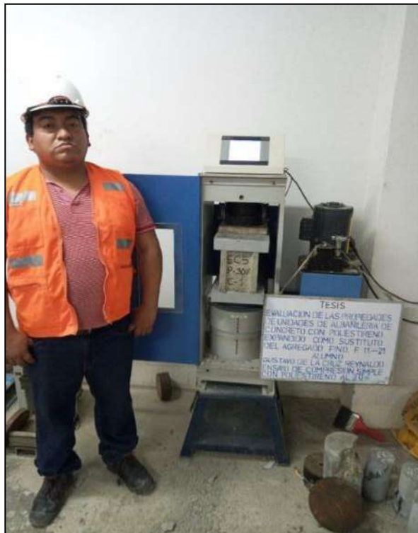
Fotografía 30. Ensayo de compresión simple en la unidad de albañilería con 30 % de poliestireno expandido.
