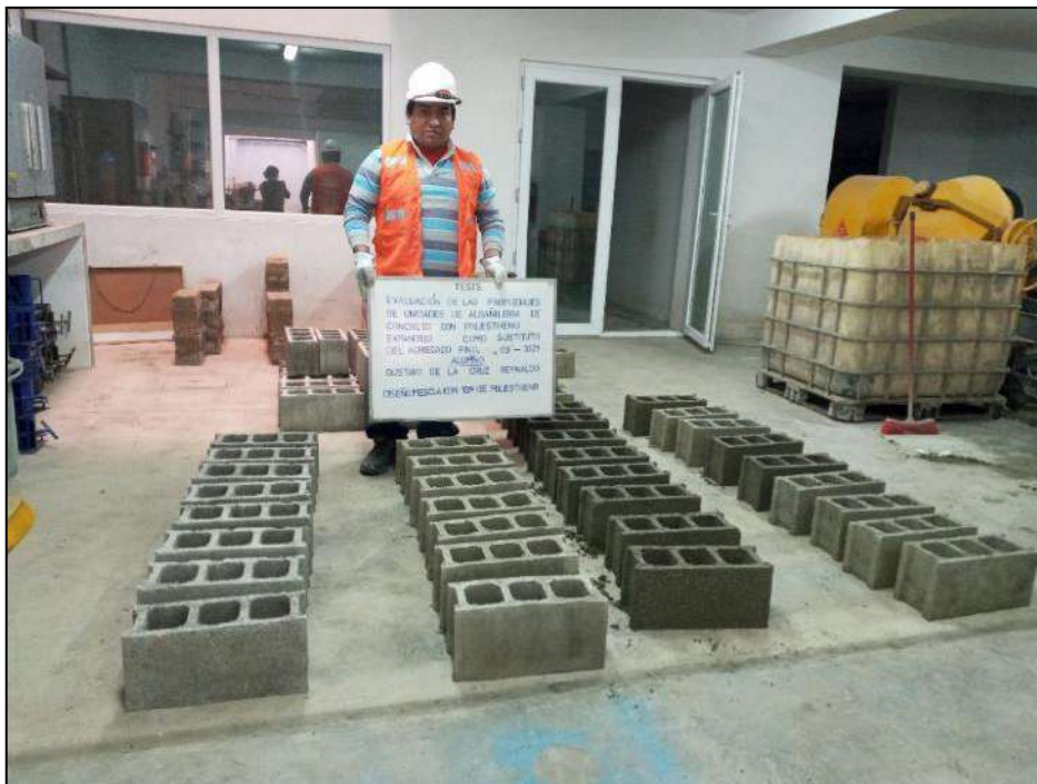
Fotografía 24. Vista de las unidades de albañilería con 10 % de poliestireno expandido.
