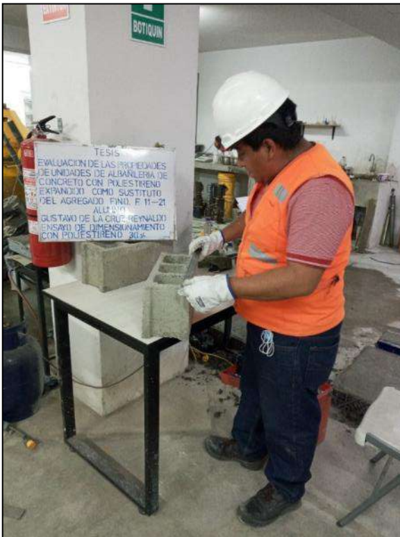
Fotografía 26. Dimensionamiento de las unidades de albañilería con concreto con 30 % de poliestireno expandido.
