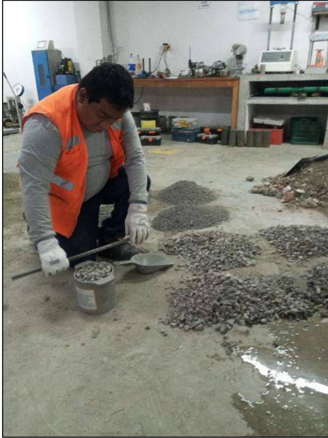
Fotografía 1. Cuarteo de agregados.
