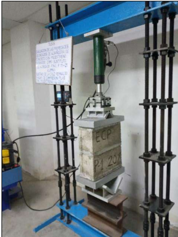
Fotografía 35. Ejecución de compresión axial en pilas con 20 % de poliestireno expandido.
