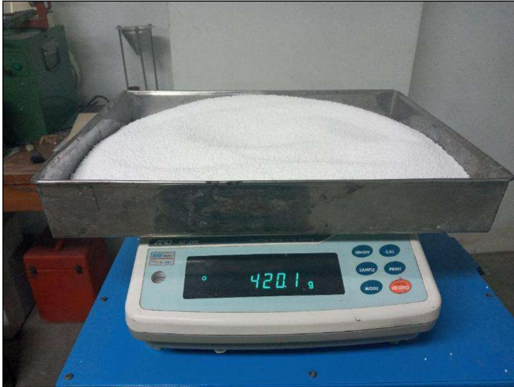
Fotografía 7. Pesado del poliestireno expandido para la elaboración del concreto para unidades de albañilería.
