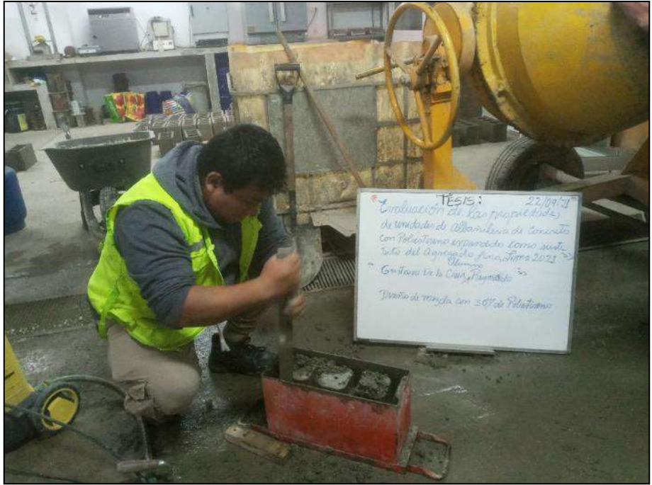
Fotografía 13. Elaboración de las unidades de albañilería con 30 % de poliestireno expandido.
