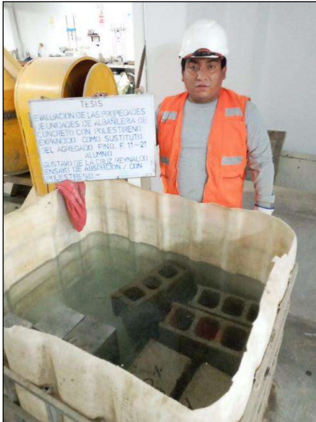
Fotografía 17. Sumergido de unidades de albañilería para ensayo de absorción.
