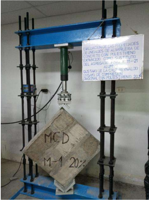
Fotografía 39. Ejecución del ensayo de compresión diagonal de muretes con 20 % de poliestireno expandido.
