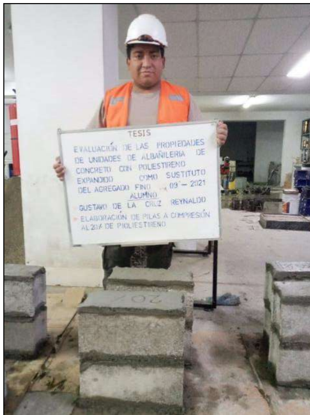
Fotografía 34. Elaboración de pilas con 20 % de poliestireno expandido.
