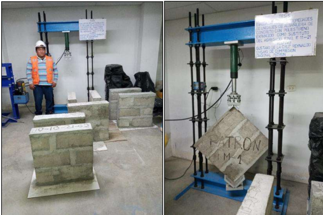
Fotografía 38. Vista de muretes con concreto patrón y el ensayo a compresión diagonal.
