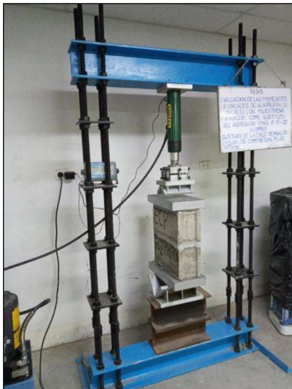
Fotografía 32. Ejecución del ensayo de compresión axial en pilas con el concreto patrón.
