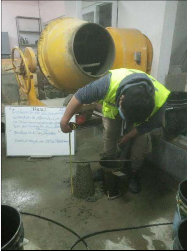
Fotografía 11. Medición del asentamiento del concreto con 20 % de poliestireno expandido.
