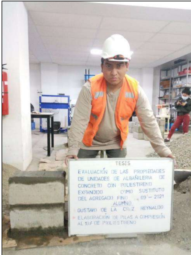
Fotografía 33. Elaboración de pilas con 10 % de poliestireno expandido.
