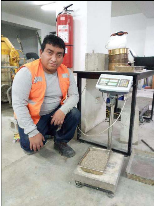
Fotografía 3. Ensayo de contenido de humedad del agregado fino.
