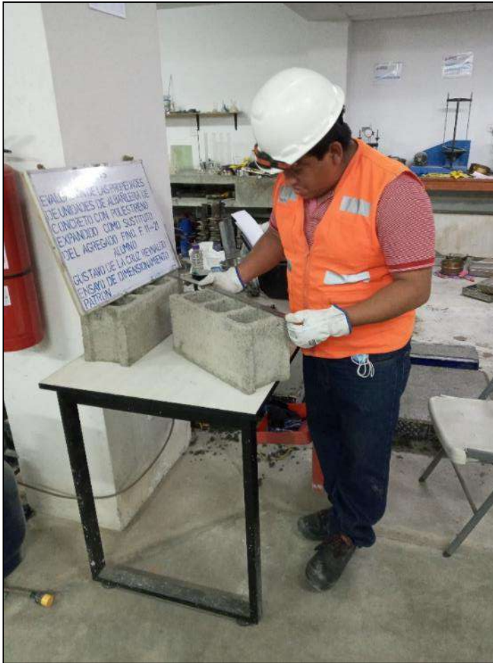
Fotografía 23. Dimensionamiento de las unidades de albañilería con concreto patrón.
