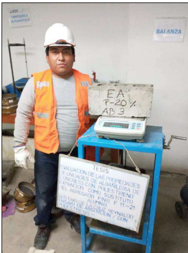
Fotografía 16. Pesado de unidad de albañilería seca con 20 % de poliestireno expandido.
