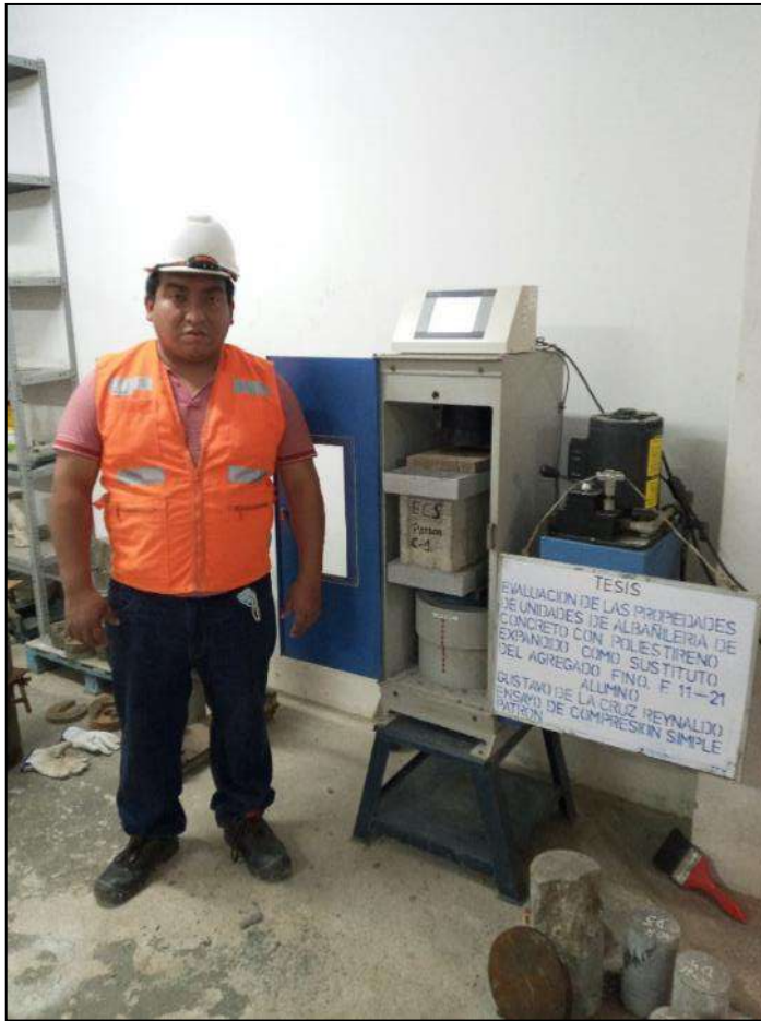
Fotografía 27. Ensayo de compresión simple en la unidad de albañilería patrón.
