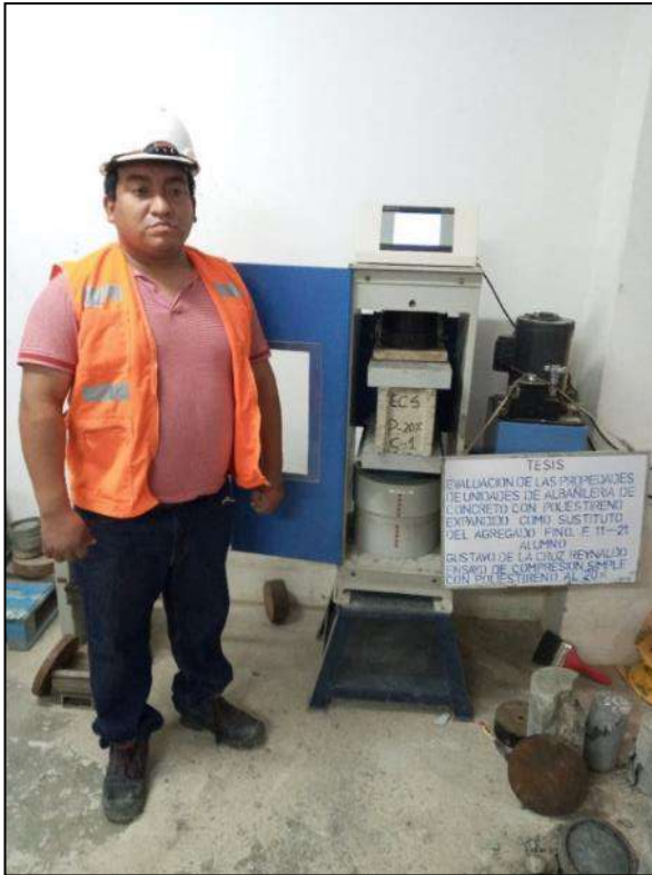
Fotografía 29. Ensayo de compresión simple en la unidad de albañilería con 20 % de poliestireno expandido.
