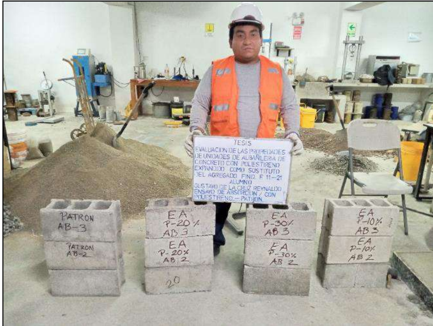
Fotografía 15. Unidades de albañilería para el ensayo de absorción.
