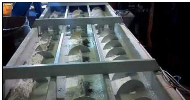
Figura 11. Proceso de lavado del plástico
