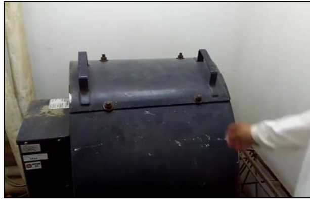
Figura 29. Máquina para el ensayo de desgaste los Ángeles
