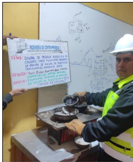
Fotografía N° 18: Procedimiento para tomar muestras de mezclas asfálticas con agregados para pavimentación, según norma MTC E 501.
