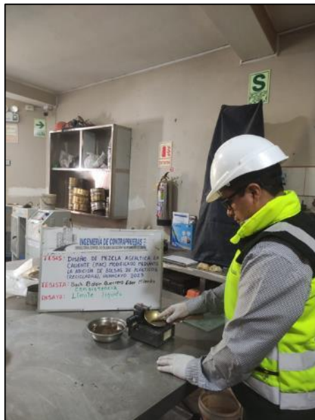
Fotografía N° 7: Ensayo de límite líquido, según referencia de la norma MTC E 110.
