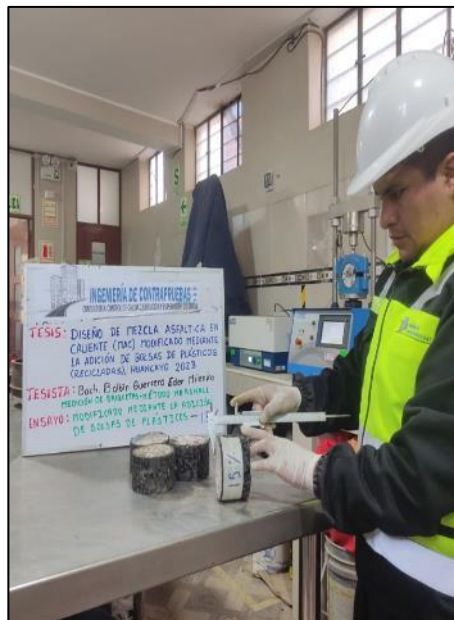
Fotografía N° 24: Realizando las medidas correspondientes a cada espécimen, según referencia de la norma MTC E-507
