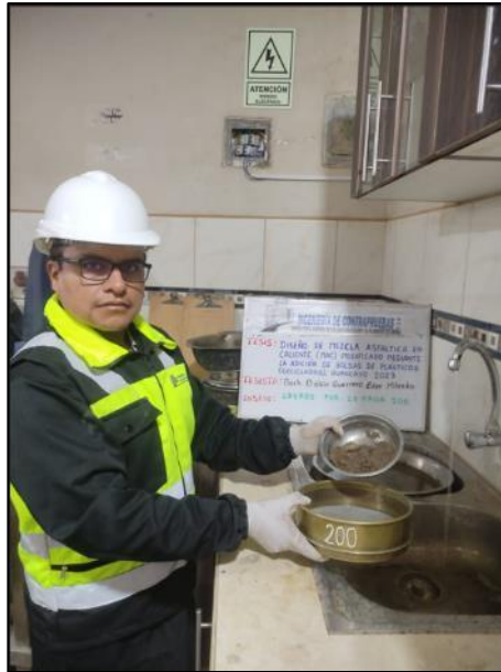
Fotografía N° 3: Método de ensayo normalizado para determinar materiales más finos que pasa por el tamiz N°200, según referencia de la NTP 400.018
