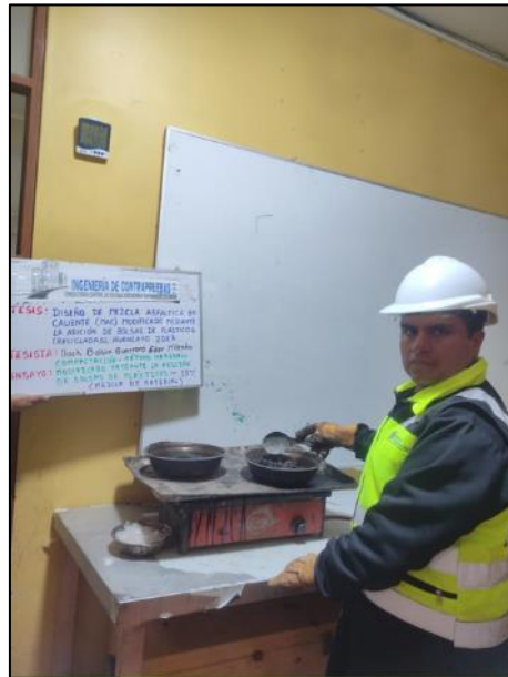
Fotografía N° 17: Procedimiento para tomar muestras de mezclas asfálticas con agregados para pavimentación, según norma MTC E 501.
