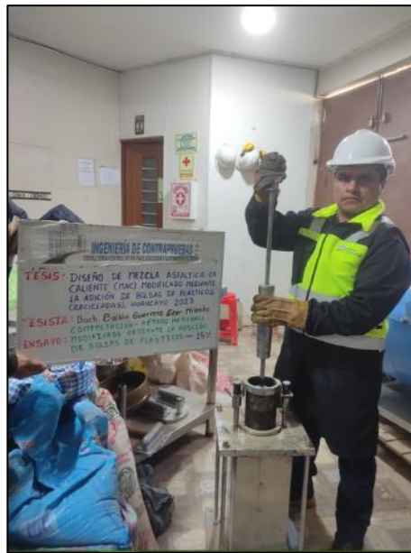
Fotografía N° 21: Coloca el molde en el pedestal con el sujetador y aplica golpes con el martillo de compactación según norma MTC E 504.
