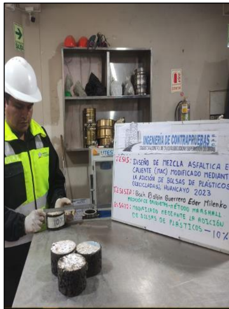
Fotografía N° 23: Realizando las medidas correspondientes a cada espécimen, según referencia de la norma MTC E-507
