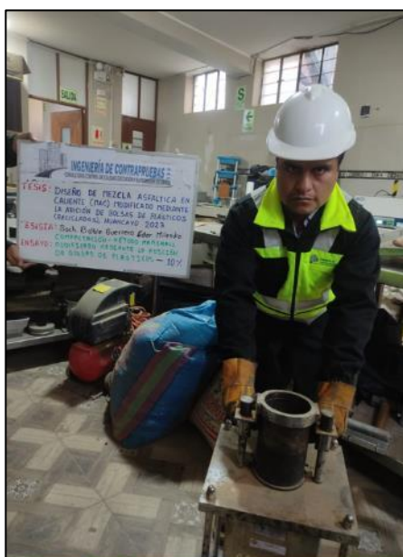
Fotografía N° 20: Coloca el molde en el pedestal con el sujetador y aplica golpes con el martillo de compactación según norma MTC E 504.
