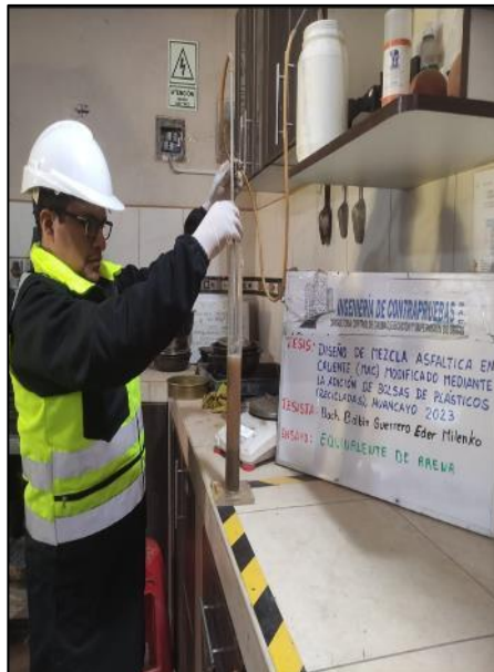
Fotografía N° 4: El propósito de este método es indicar, bajo condiciones estándar, las proporciones relativas de suelos arcillosos o finos plásticos y polvo en suelos granulares y agregados finos que pasan el tamiz N°4 (4,75mm), según referencia de la NTP 339.146
