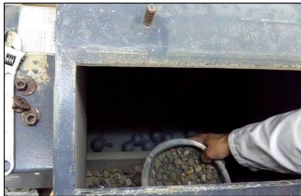
Figura 30. Colocación de las esferas de acero y agregados en la máquina los Ángeles
