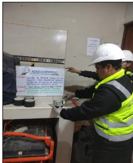
Fotografía N° 22: Realizando las medidas correspondientes a cada espécimen, según referencia de la norma MTC E-507
