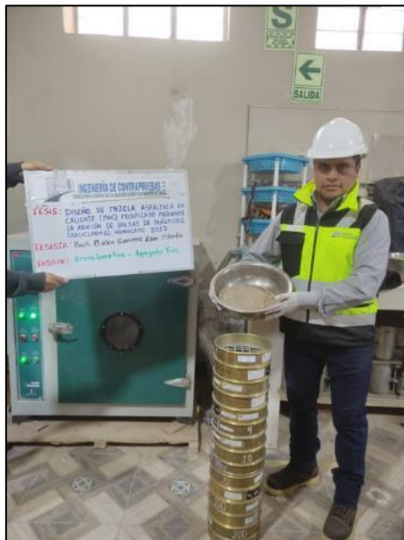
Fotografía N° 6: Determinar la gradación de materiales propuestos para uso como agregados finos, según referencia de la norma MTC E 204.
