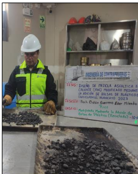
Fotografía N° 32: Este método cubre la determinación de la gravedad específica teórica máxima y densidad de mezclas bituminosas no compactadas a 25 °C, según referencia de la norma MTC E-508.
