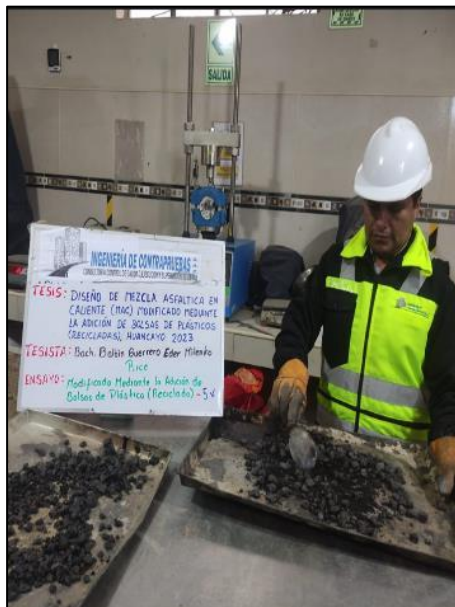
Fotografía N° 31: Este método cubre la determinación de la gravedad específica teórica máxima y densidad de mezclas bituminosas no compactadas a 25 °C, según referencia de la norma MTC E-508.
