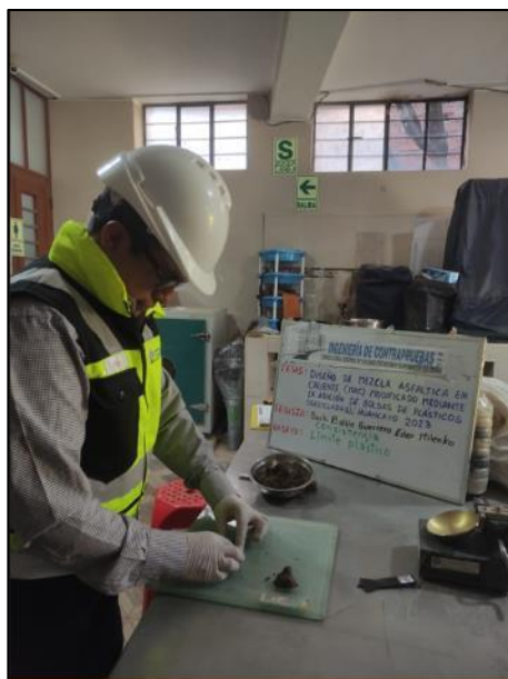
Fotografía N° 8: Ensayo de límite plástico, según referencia de la norma MTC E 110.
