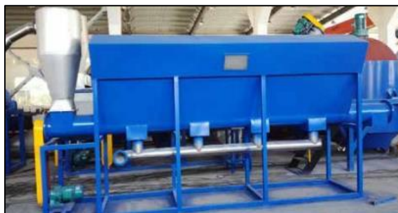
Figura 12. Lavado y centrifugado del plástico
