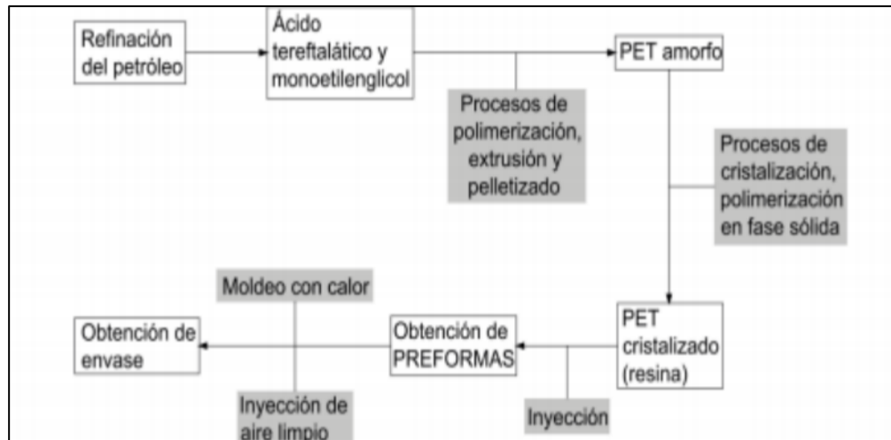
Figura 8. Proceso de producción del PET
