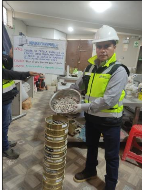
Fotografía N° 5: Determinar la gradación de materiales propuestos para uso como agregados, según referencia de la norma MTC E 204.
