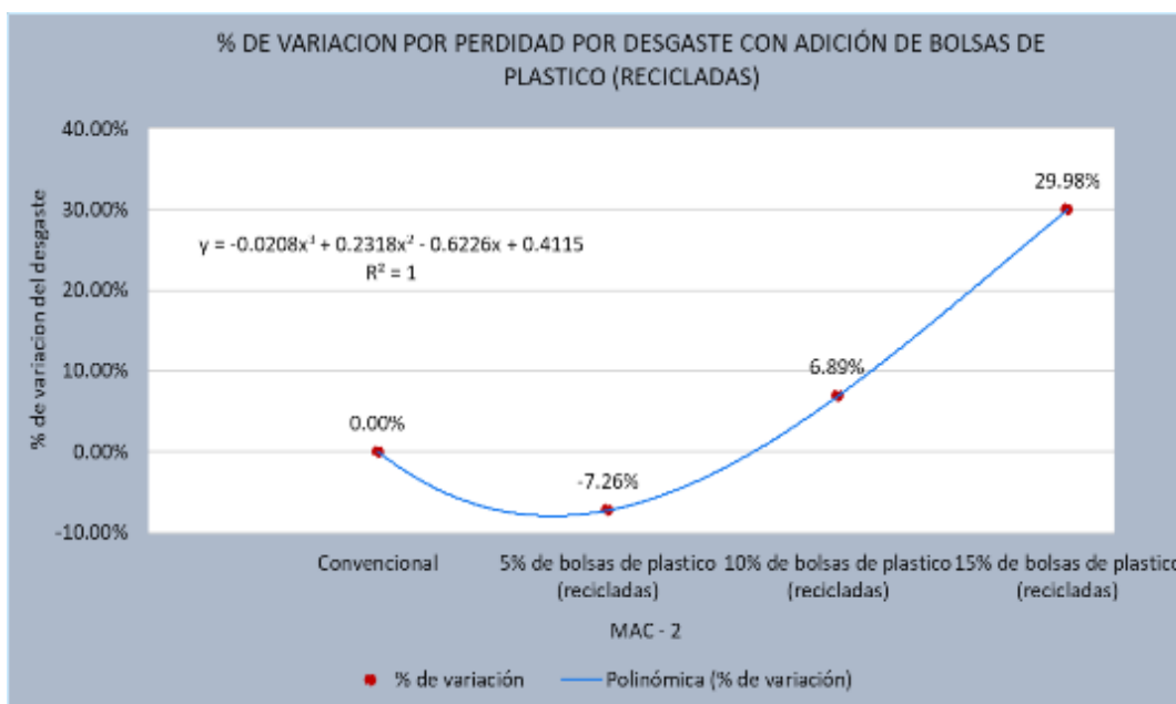
Figura 43. Variación del % de perdida por desgaste en la mezcla asfáltica
