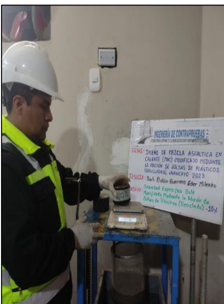
Fotografía N° 26: Se registran las masas del espécimen en aire y agua a 25 \pm 1^\circ\text{C} . Después, se seca hasta alcanzar el estado SSS para calcular su gravedad específica bulk.
