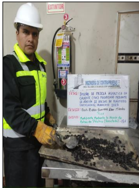
Fotografía N° 33: Este método cubre la determinación de la gravedad específica teórica máxima y densidad de mezclas bituminosas no compactadas a 25 °C, según referencia de la norma MTC E-508. FUENTE: Elaboración Propia
