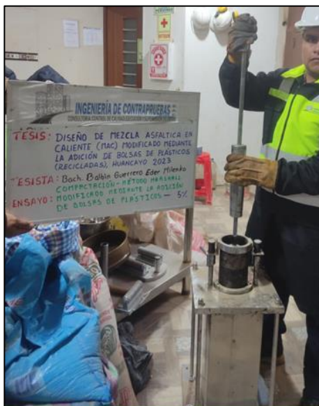
Fotografía N° 19: Coloca el molde en el pedestal con el sujetador y aplica golpes con el martillo de compactación según norma MTC E 504.
