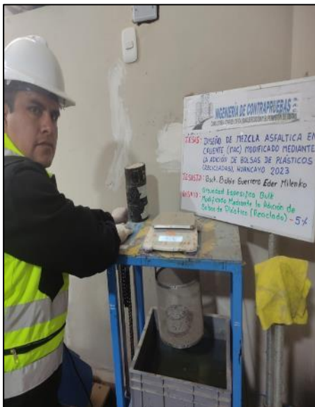
Fotografía N° 25: Se registran las masas del espécimen en aire y agua a 25 \pm 1^\circ\text{C} . Después, se seca hasta alcanzar el estado SSS para calcular su gravedad específica bulk.
