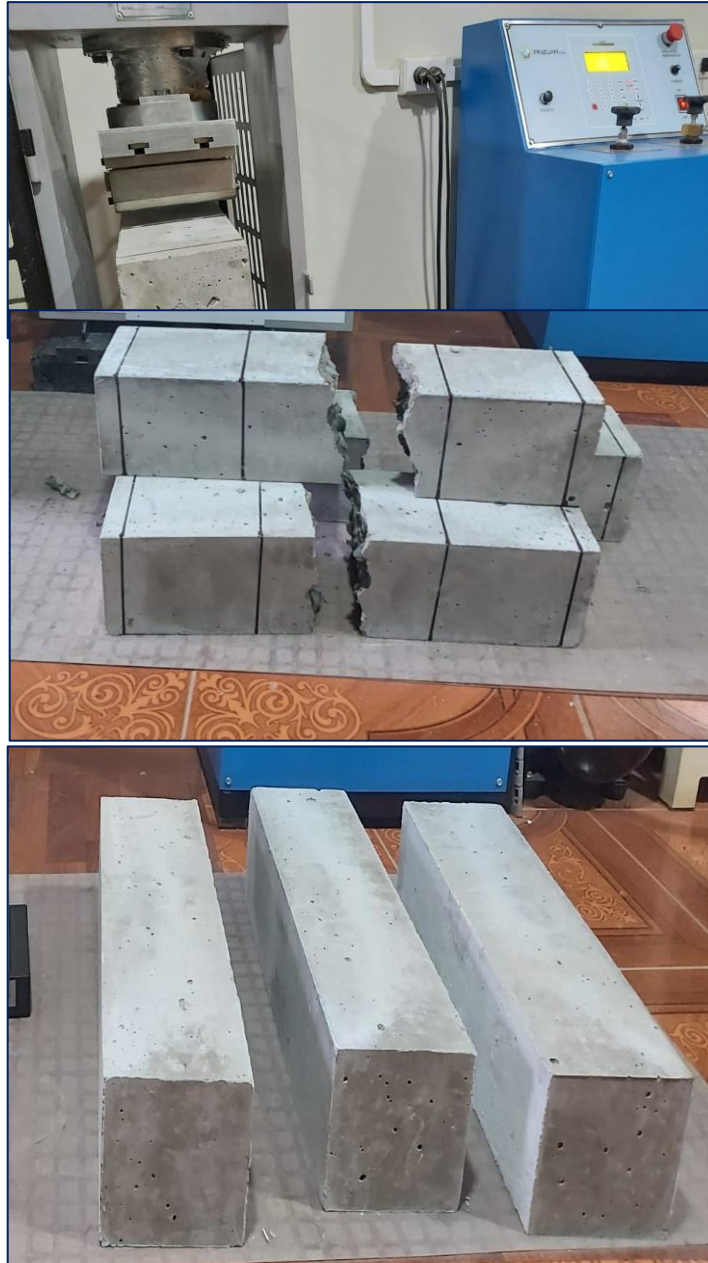
Fotografía 13. Resistencia a la flexión del concreto en vigas simplemente apoyadas cargadas a los tercios del tramo.
