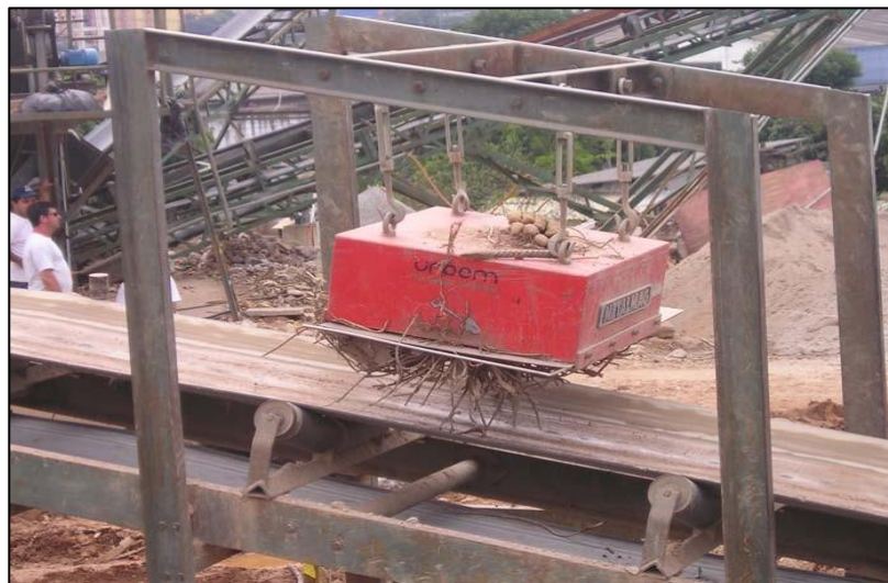
Figura 01. Separación magnética de los materiales ferrosos. Fuente: Carrión y Masapanta (2018).
