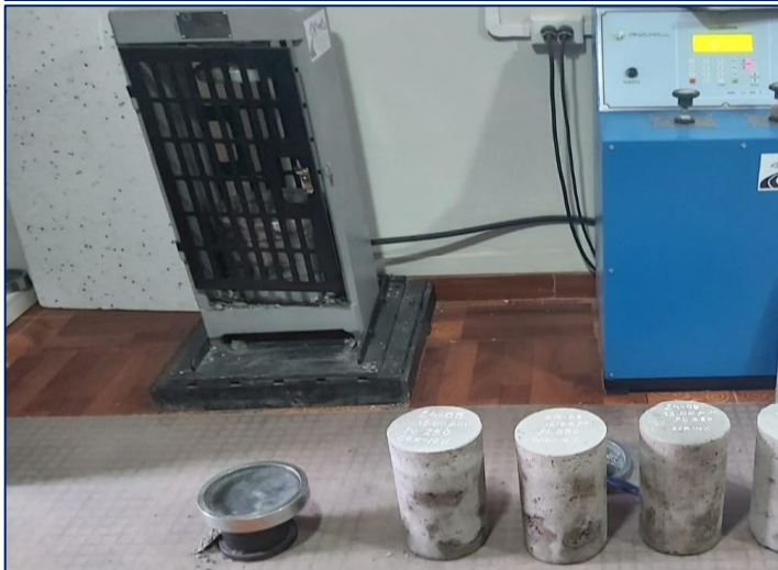
Fotografía 12. Resistencia a la compresión de testigos cilíndricos.
