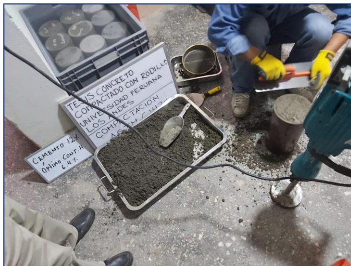
Fotografía 10. Método para moldear cilindros de concreto compactado con rodillo, usando un martillo vibratorio.
