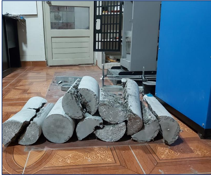
Fotografía 14. Método de prueba estándar para determinación de la resistencia a la tracción por compresión diametral de especímenes cilíndricos de hormigón.
