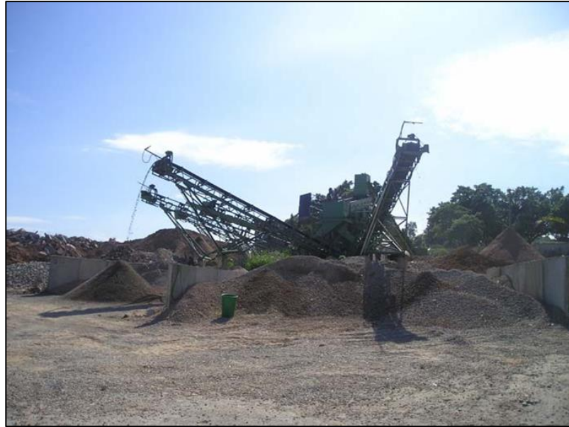
Figura 02. Agregados apilados por fajas según su granulometría. Fuente: Carrión y Masapanta (2018).
