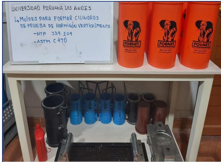
Fotografía 8. Moldes para formar cilindros de prueba de hormigón verticalmente.
