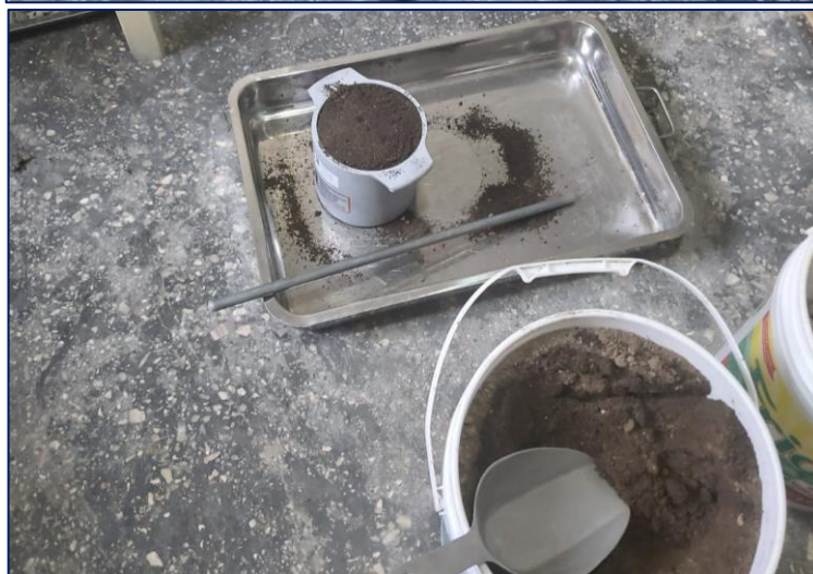
Fotografía 5. Ensayo para determinar la masa por unidad de volumen (peso unitario suelto y compactado) y vacíos en agregados
