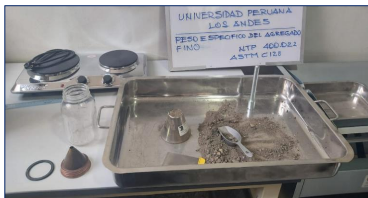
Fotografía 7. Ensayo para determinar la gravedad específica y absorción de agregados finos.
