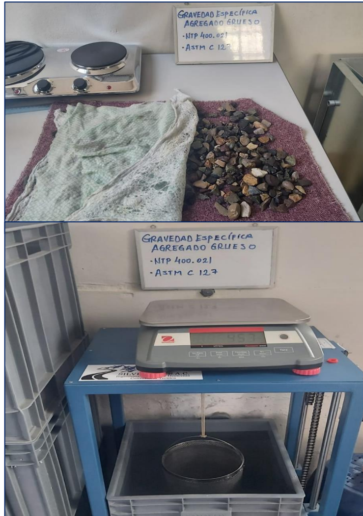
Fotografía 6. Ensayo para determinar la gravedad específica y absorción de agregados gruesos.
