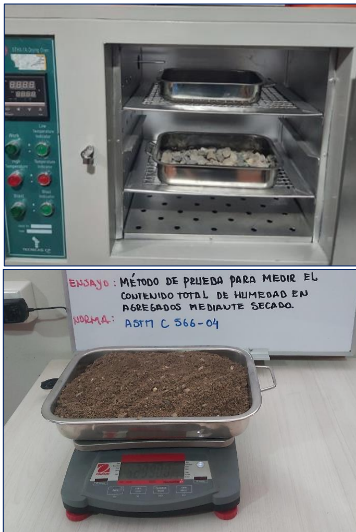
Fotografía 3. Ensayo para determinar el contenido de humedad total evaporable de agregados por secado.
