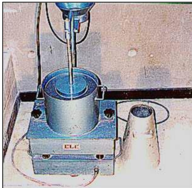
Figura 07. Ensayos de consistencia para el concreto compactado Fuente: Fardin y dos Santos (2020).
