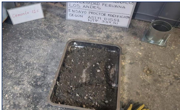
Fotografía 9. Método de compactación Proctor modificado.
