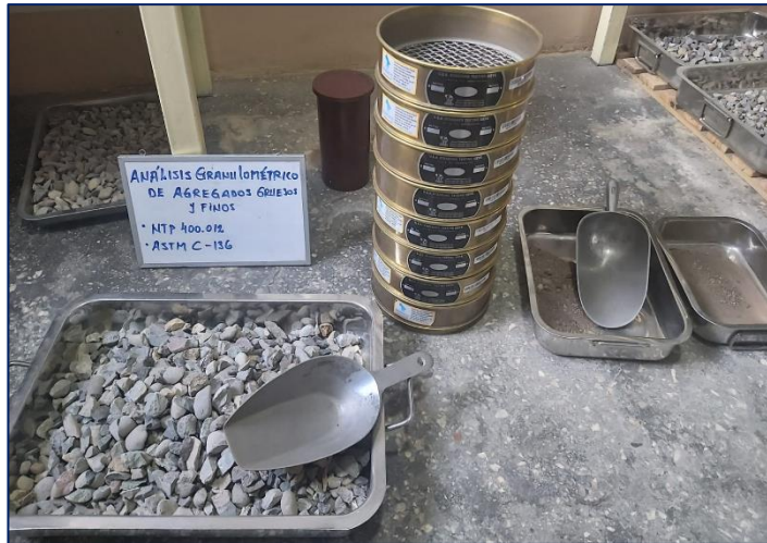
Fotografía 4. Tamizado del agregado grueso y fino.
