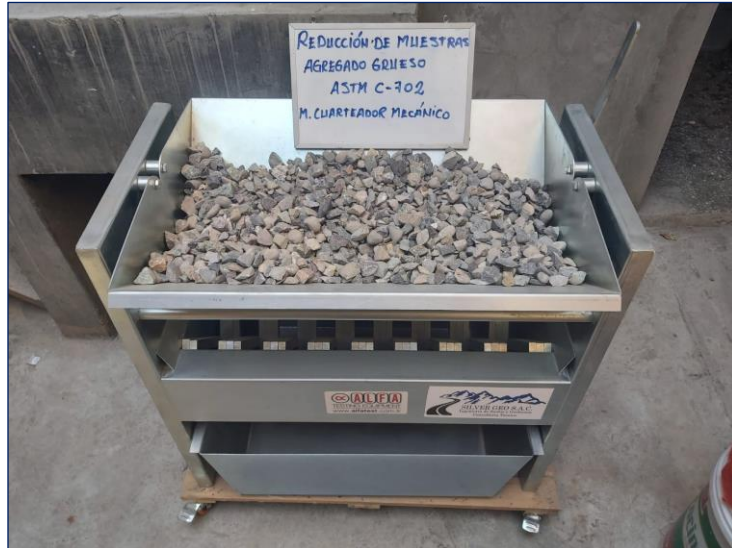
Fotografía 2. Cuarteo mecánico del agregado grueso.
