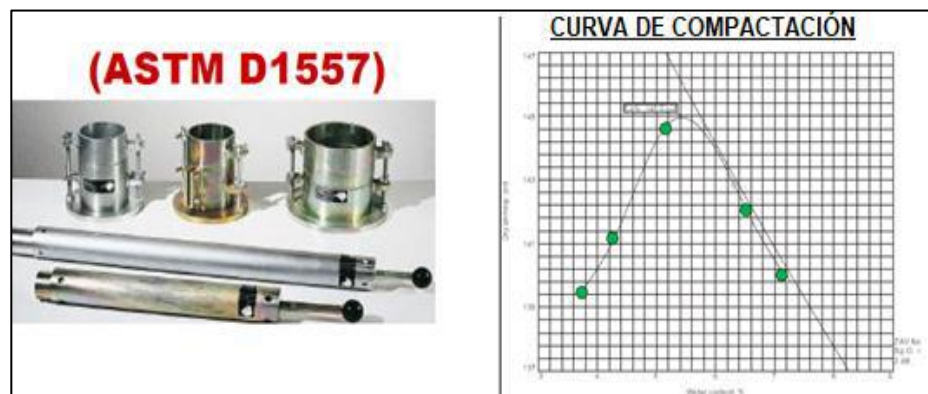
Figura 08. Aplicación del ensayo de compactación de suelos. Fuente: Carrión y Masapanta (2018).
