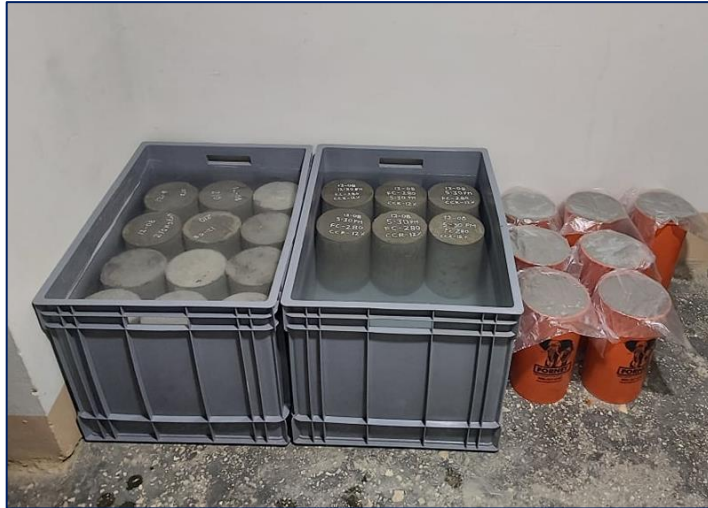
Fotografía 11. Curado de especímenes de hormigón en laboratorio.
