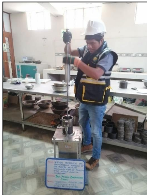
Fotografía N° 4: Proceso de ensayo de Proctor modificado realizando la adición de fibras de poliéster en la dosis de: 0.03%, 0.05%, 0.07% y 0.10% según la norma ASTM D 6926 -20.
