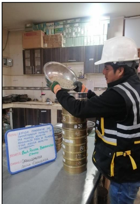
Fotografía N° 2: Proceso de ensayo de análisis granulométrico del AF por tamizado, según referencia de la norma ASTM C 136.
