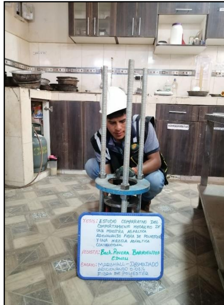
Fotografía N° 5: Proceso de desmolde de la muestra que según la norma ASTM D 6926 -20.
