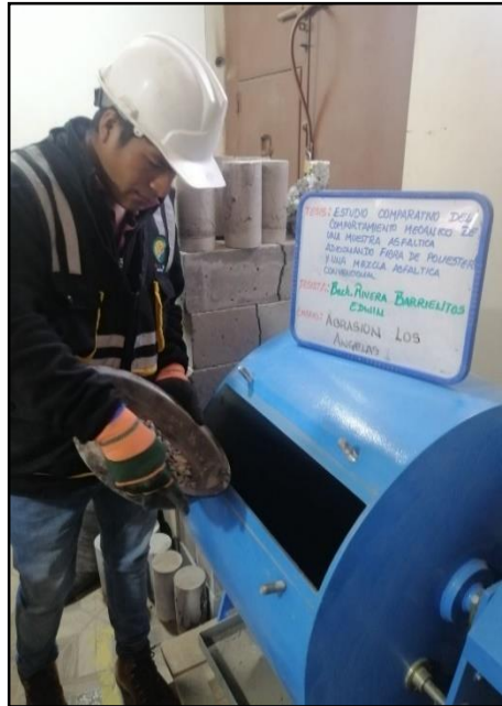
Fotografía N° 3: Proceso de ensayo de abrasión de los ángeles empleando el método B según la norma ASTM C 131.
