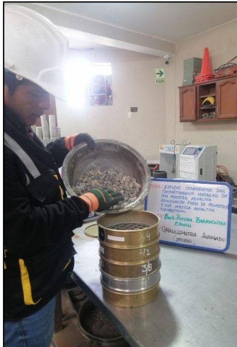
Fotografía N°1: Proceso de ensayo de análisis granulométrico del agregado grueso por tamizado, según referencia de la norma (ASTM C 136).
