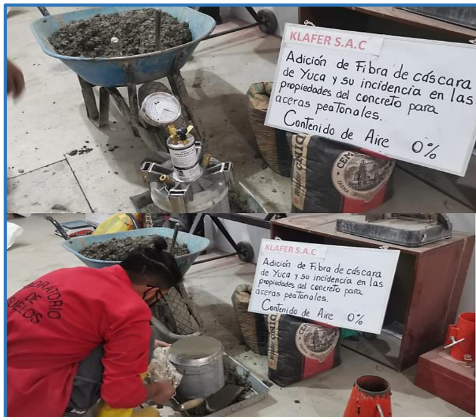
Figura 11: Ensayo de contenido de aire; Según NTP 339.080
