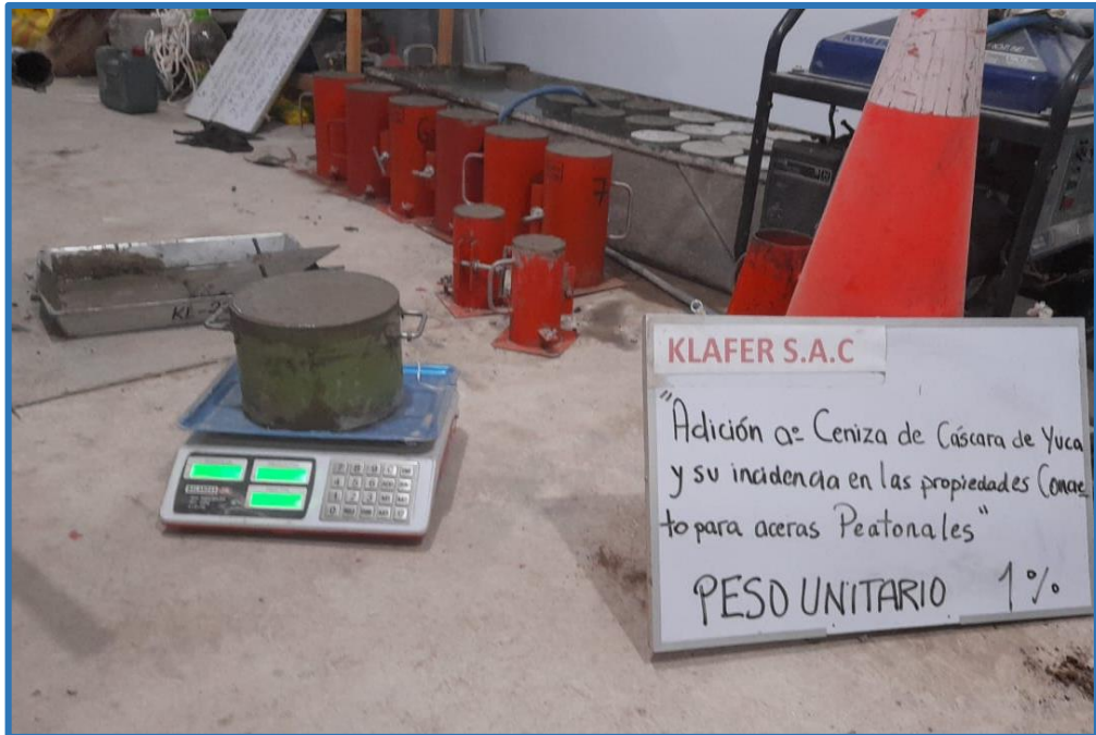
Fuente: Propia. Se realiza el ensayo de peso unitario al 1.00%.
