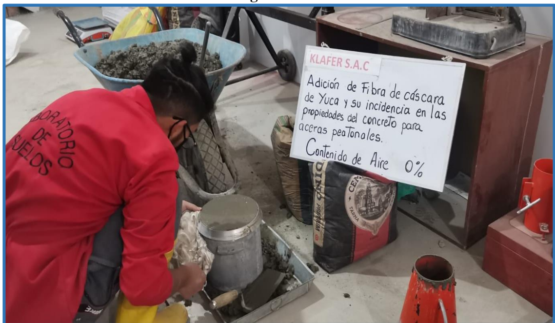
Fuente: Propia. Se realiza el ensayo de contenido de aire al 0%.
