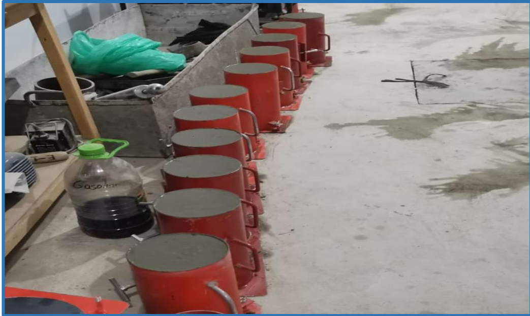
Fuente: Propia. Ensayo de probetas para pruebas de resistencia a la compresion.
