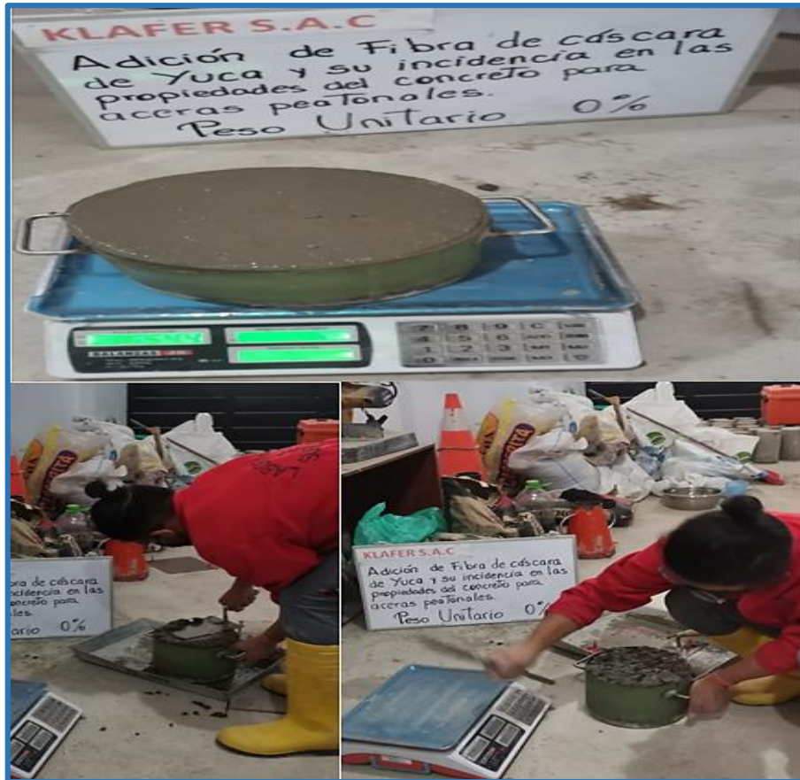
Figura 10: Ensayo de peso unitario; Según NTP 339.046
