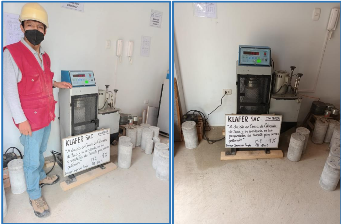
Fuente: Propia. Se realiza el ensayo de compresion simple de 1.0 % al 28 dias.
