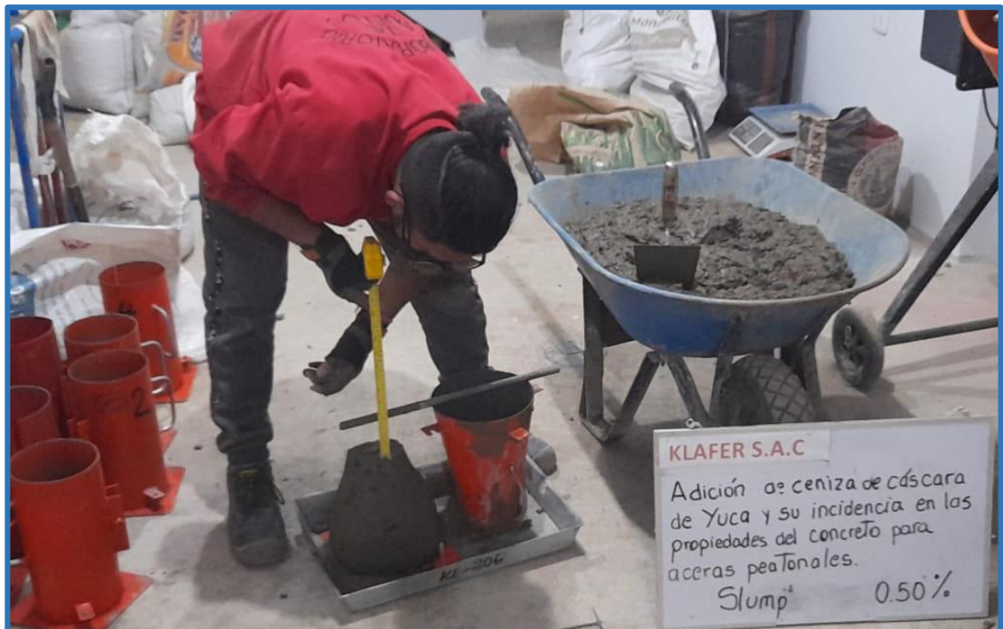
Fuente: Propia. Se realiza el ensayo de prueba slump al 0.50%.
