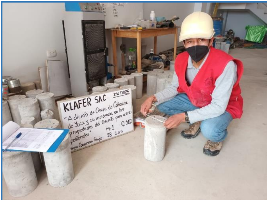
Fuente: Propia. Se realiza las medidas como la altura y el diametro de la probeta.
