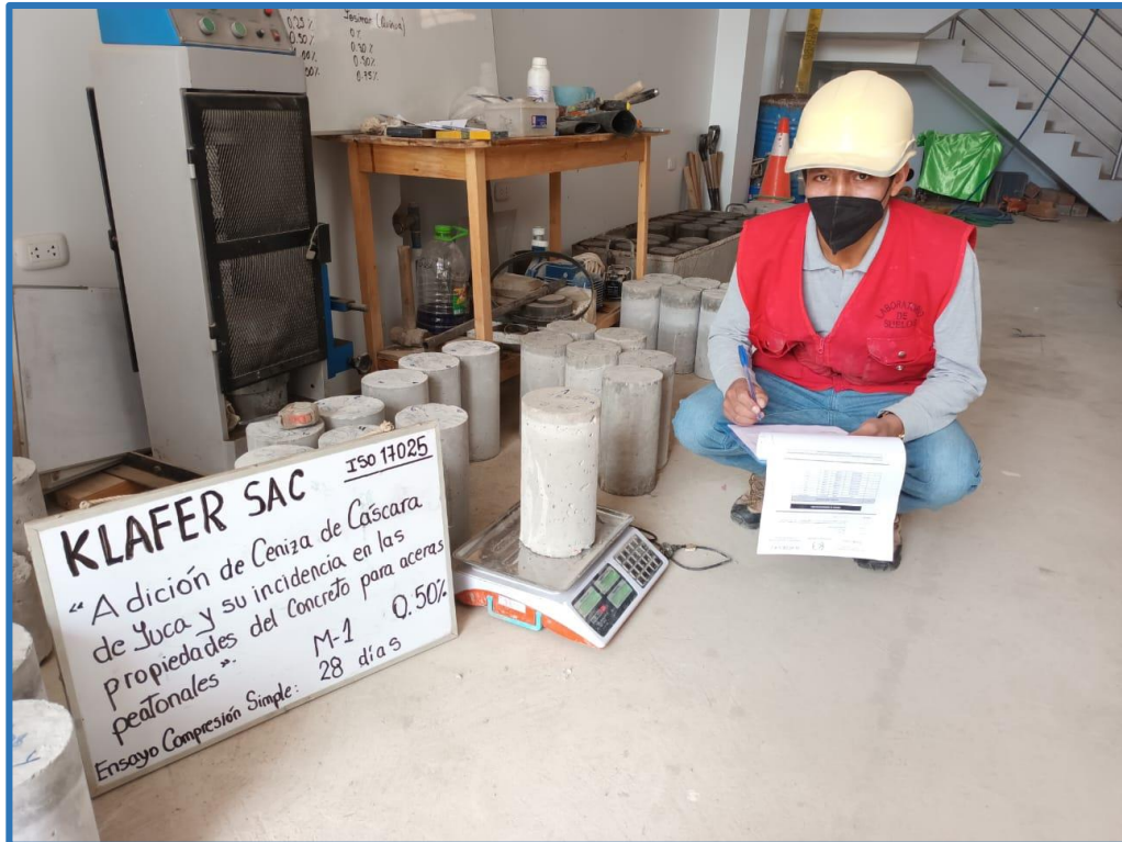
Fuente: Propia. Se obtiene el peso de la probeta utilizando la balanza electronica.
