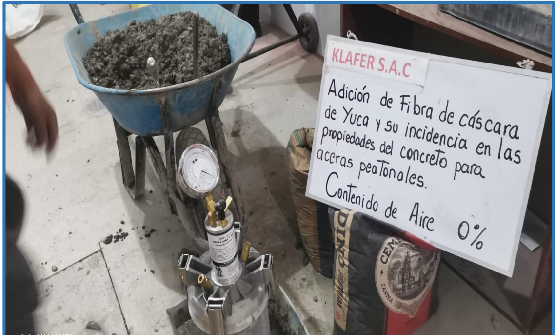
Fuente: Propia. Se realiza el ensayo de contenido de aire.
