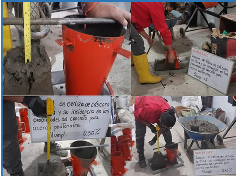
Figura 9: Ensayo de asentamiento (Cono de Abrahams); Según NTP 339.035
