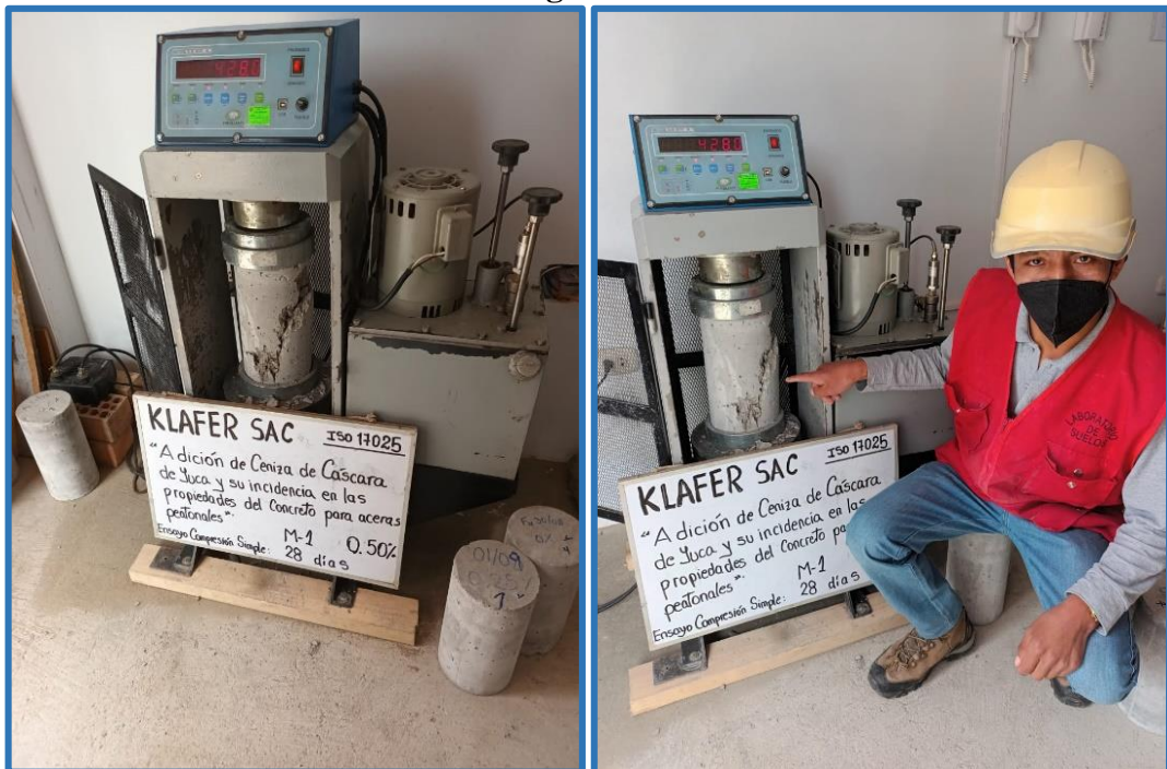
Fuente: Propia. Se realiza el ensayo de compresion simple de 0.50% al 28 dias.
