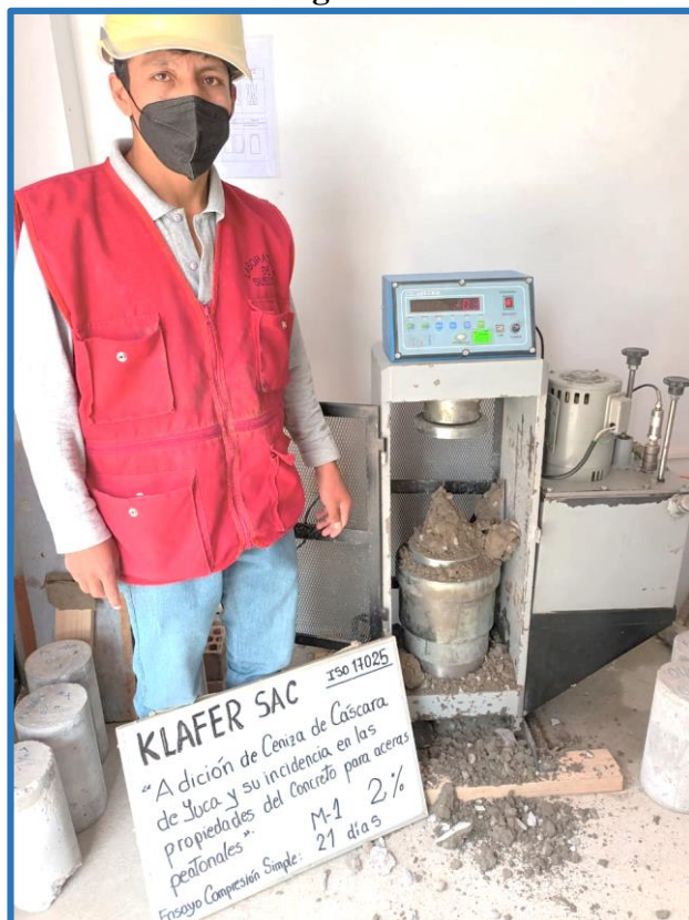
Fuente: Propia. Se realiza el ensayo de compresion simple de 2.0 % al 28 dias.
