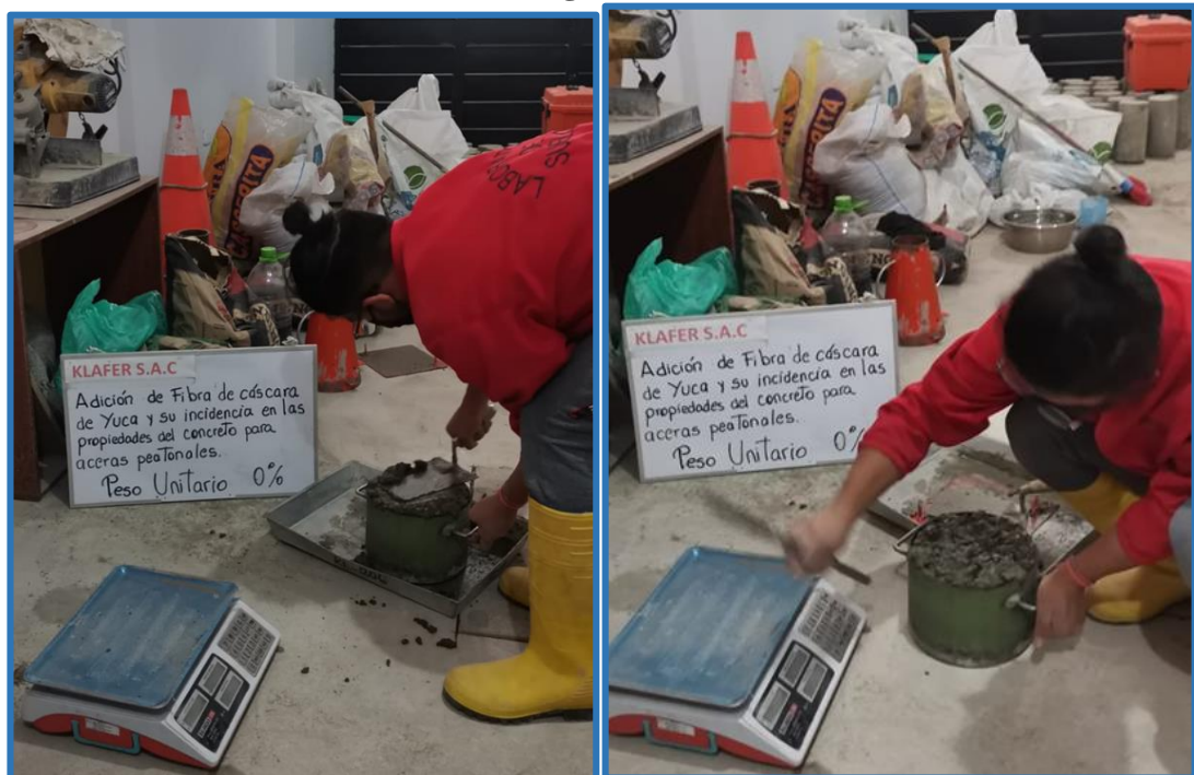
Fuente: Propia. Se realiza el ensayo de peso unitario al 0%.
