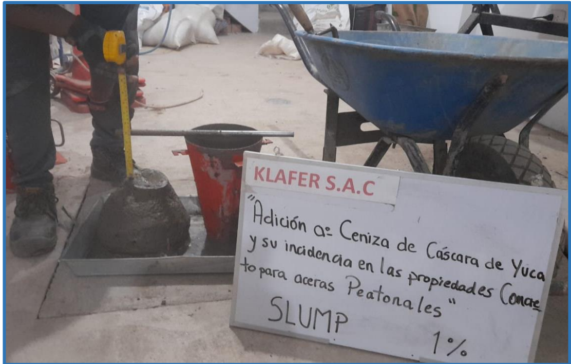
Fuente: Propia. Se realiza el ensayo de prueba slump al 1.00%.
