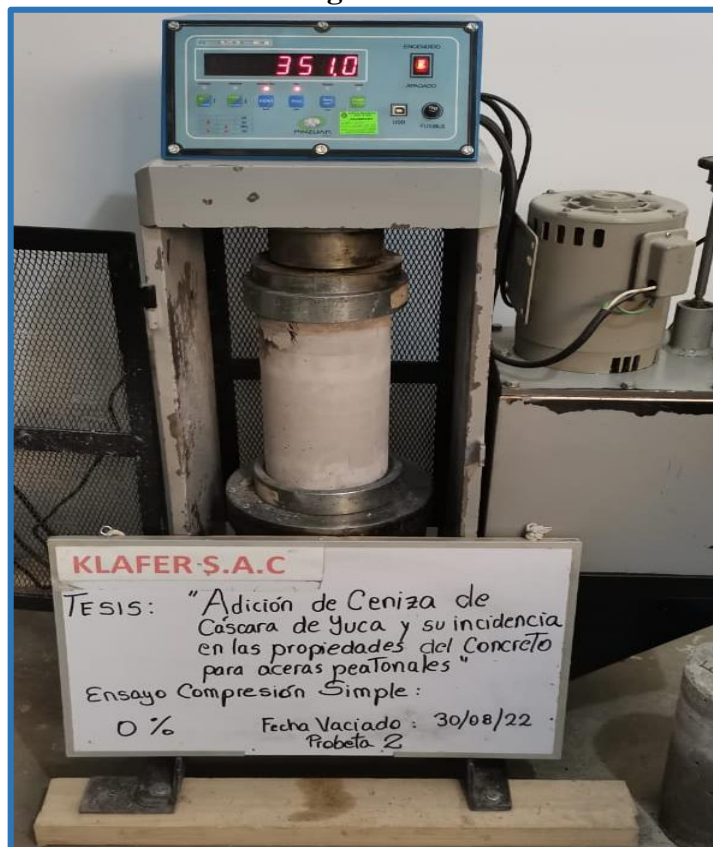
Fuente: Propia. Se realiza el ensayo compresion simple al 0%.
