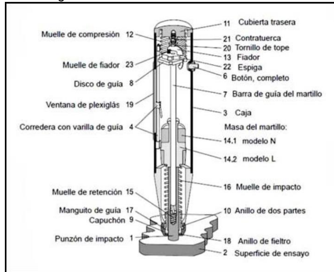
«Figura 4 Estructura de martillo de Schmidt»
