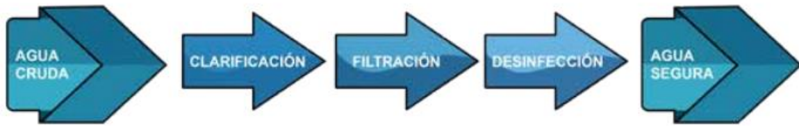
Figura4 Esquema del tratamiento de potabilización del agua
