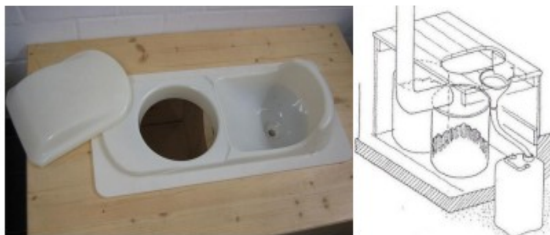
Figura 2.2.6.6 Ejemplo de funcionamiento del baño seco - Imágenes de Winblad et al. (2004).
