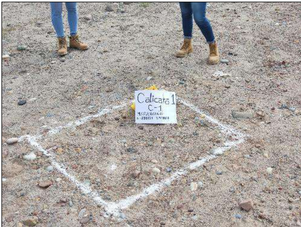
Fotografía 8. Demarcación de calicata 1
