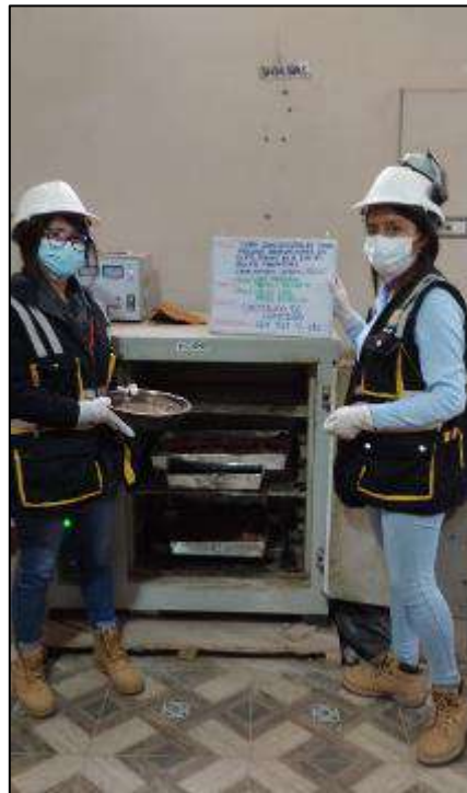
Fotografía 16. Ensayo de contenido de humedad
