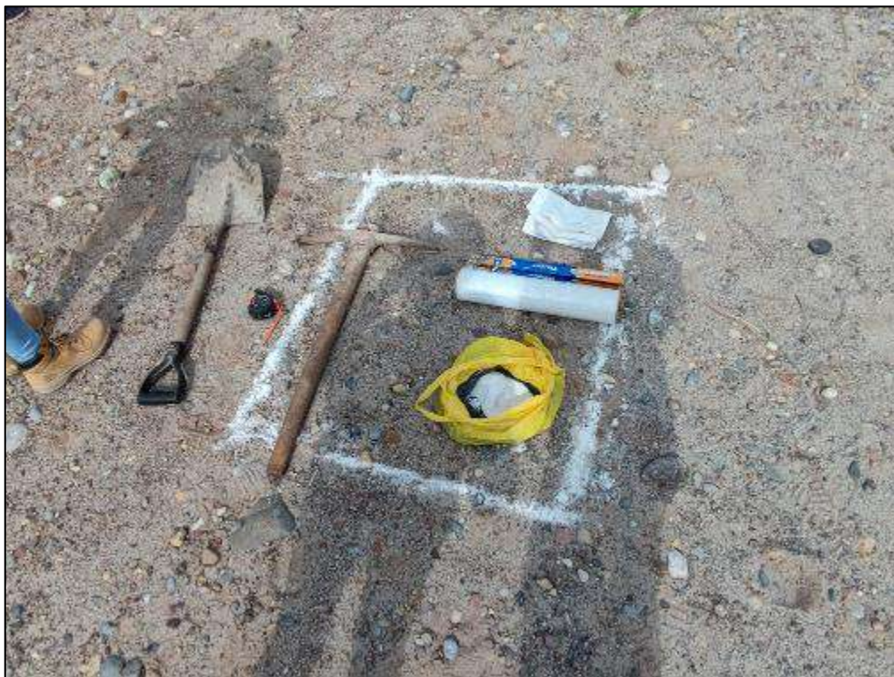
Fotografía 10. Demarcación de calicata 2 y materiales
