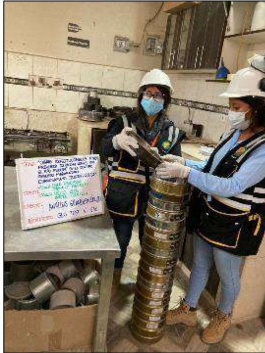
Fotografía 13. Análisis granulométrico, serie de tamices
