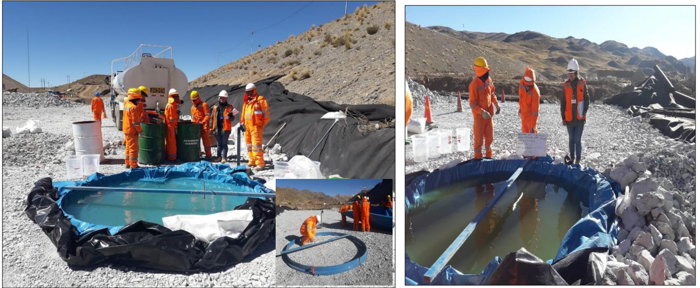
Figura 20: Determinación de densidad – método reemplazo por agua
