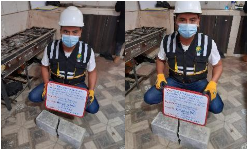
Fotografía 26. Rotura de viga (14 días) convencional y rotura de viga (14 días) con adición de escoria de cobre al 15%
