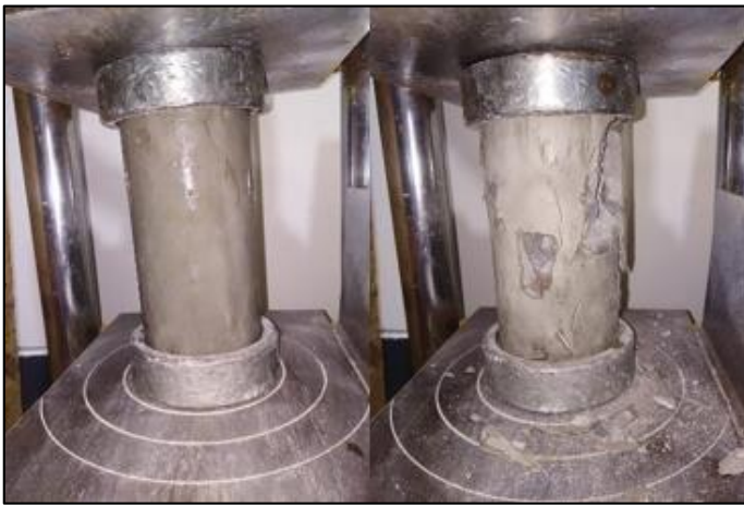
Figura 2.3. Ensayo de la resistencia a la compresión en laboratorio. Fuente: Viera y Chicaiza (2018).
