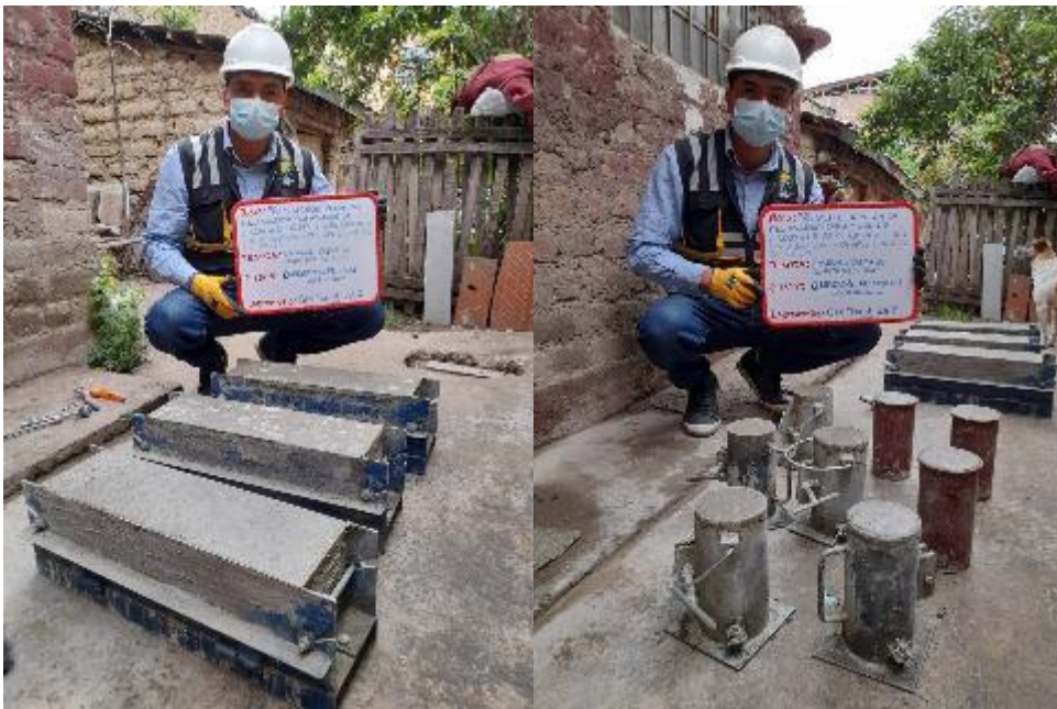
Fotografía 22. Elaboración de vigas y probetas del concreto convencional.
