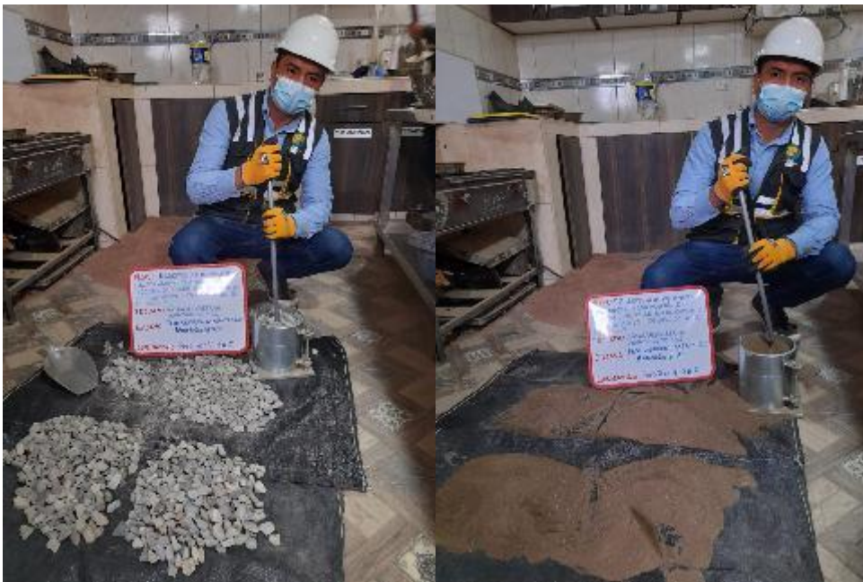
Fotografía 19. Ensayo peso unitario compactado del agregado grueso y fino.
