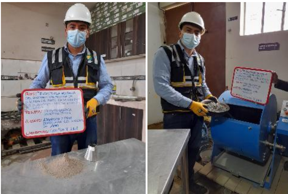
Fotografía 17. Ensayo absorción y peso específico del agregado fino y abrasión los Ángeles.
