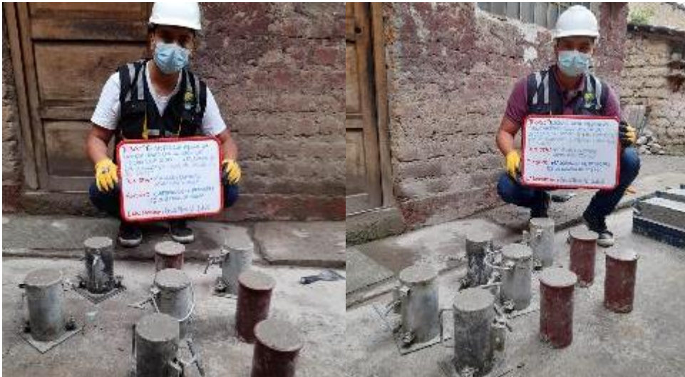
Fotografía 23. Elaboración de probetas al 5 % y 10% escoria de cobre.
