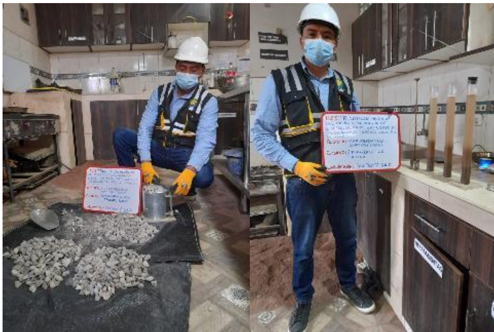
Fotografía 15. Ensayo peso unitario suelto del agregado grueso y ensayo equivalente de arena.
