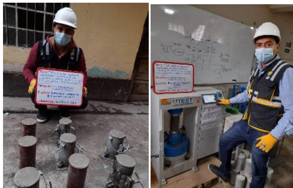
Fotografía 25. Elaboración de probetas al 15 % y rotura de probetas (7 días) con 5 % de cobre.
