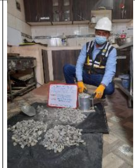
Fotografía 7. Peso unitario suelto (PUS) de agregado grueso
