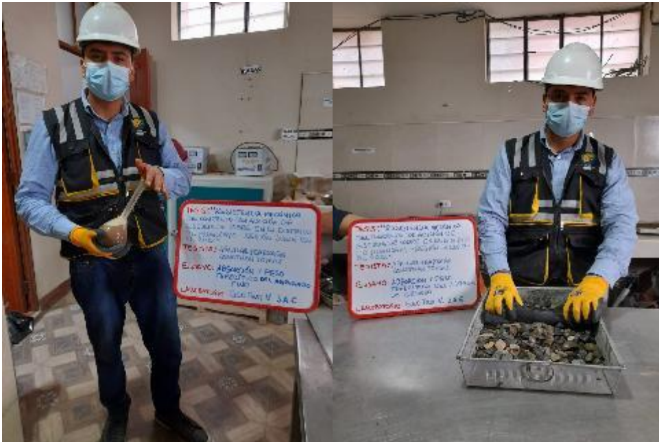
Fotografía 16. Ensayo absorción y peso específico del agregado fino y agregado grueso.
