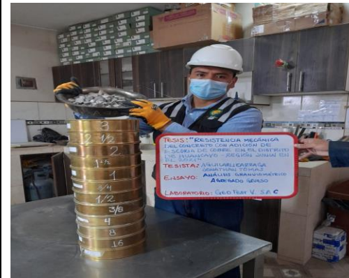
Fotografía 4. Tamizando para análisis de granulometría del agregado grueso.
