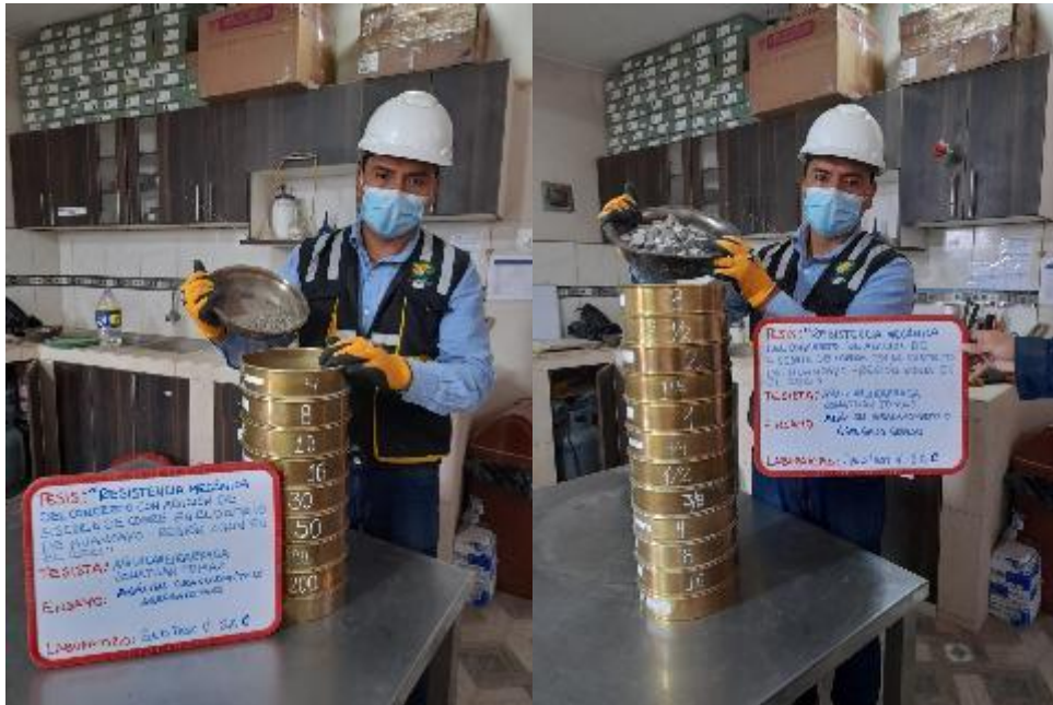
Fotografía 14. Análisis granulométrico del agregado fino y grueso.
