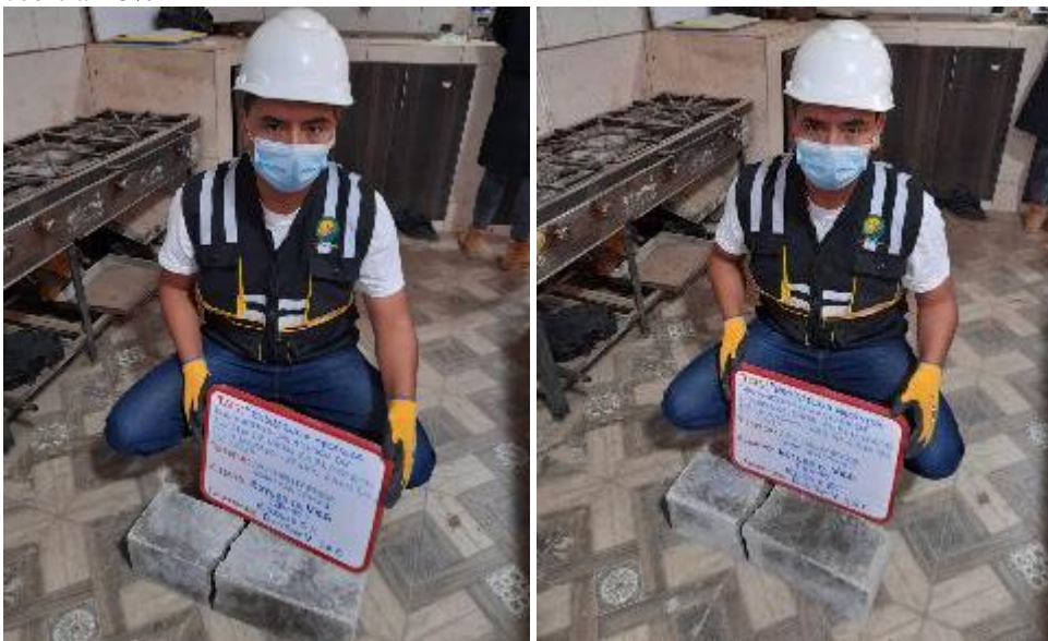
Fotografía 27. Rotura de viga (28 días) con adición de 5 % de escoria de cobre y viga (28 días) con adición al 10 % de escoria de cobre.
