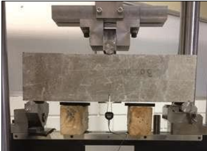
Figura 2.4. Ensayo de la resistencia a la flexión en laboratorio. Fuente: Gutierrez y Reyes (2022).
