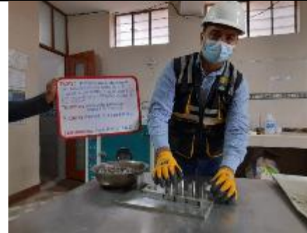
Fotografía 5. Método para la determinación de los porcentajes de partículas chatas o alargadas en el agregado grueso.
