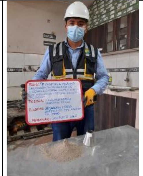
Fotografía 9. Absorción y peso específico del agregado fino.
