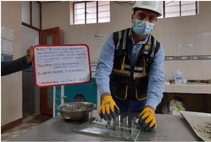
Fotografía 18. Ensayo para determinar las partículas chatas y alargadas.
