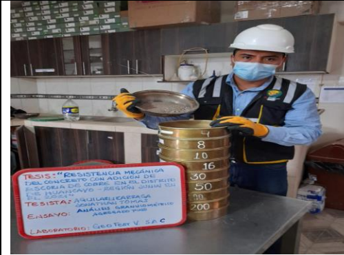
Fotografía 3. Tamizando para el análisis de granulometría de árido fino.
