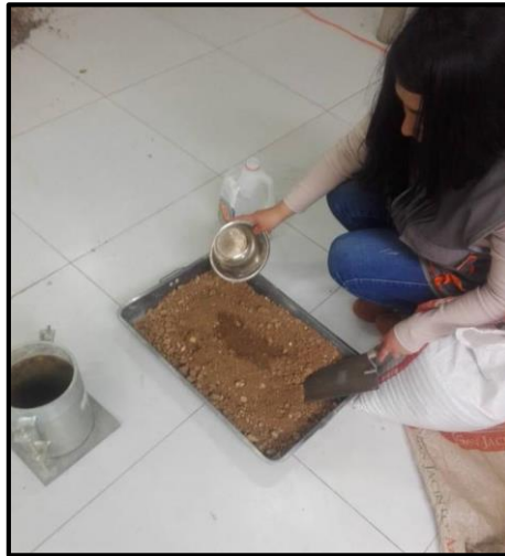
Figura 14. Ensayo de proctor - preparación del espécimen
