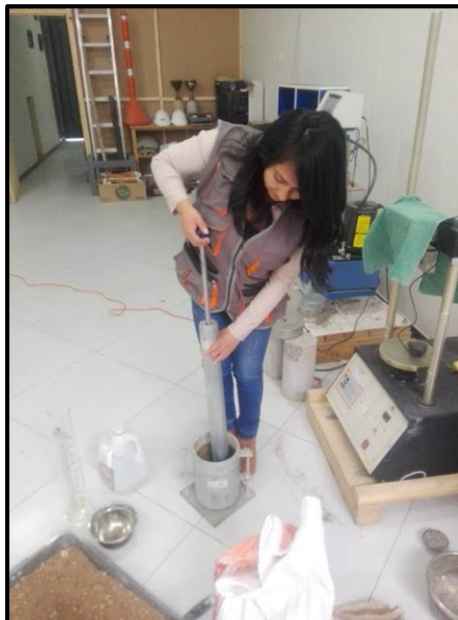
Figura 15. Ensayo de proctor - compactación
