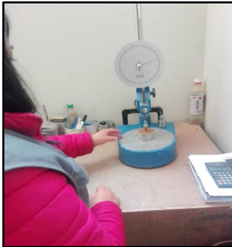
Figura 11. Ensayo del límite líquido con el penetrómetro cónico
