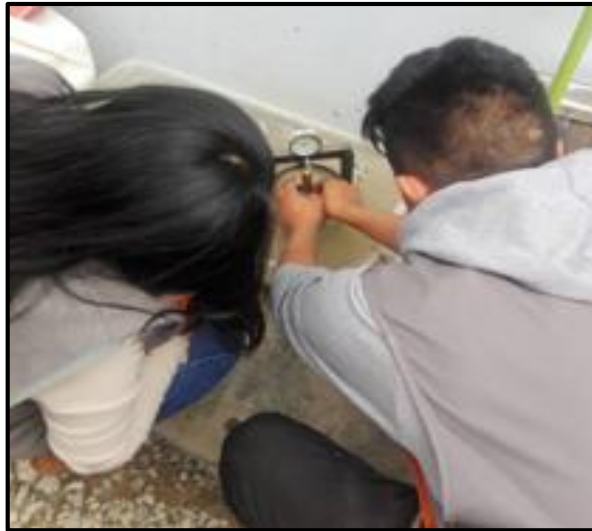
Figura 17. Ensayo de Relación de soporte de California CBR- Expansión
