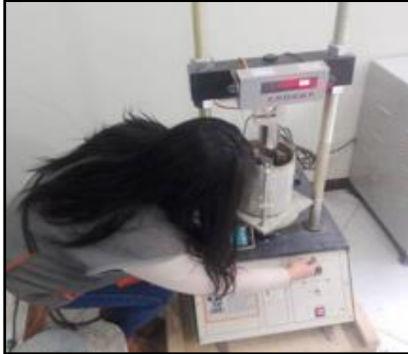
Figura 16. Ensayo de Relación de soporte California CBR- Penetración
