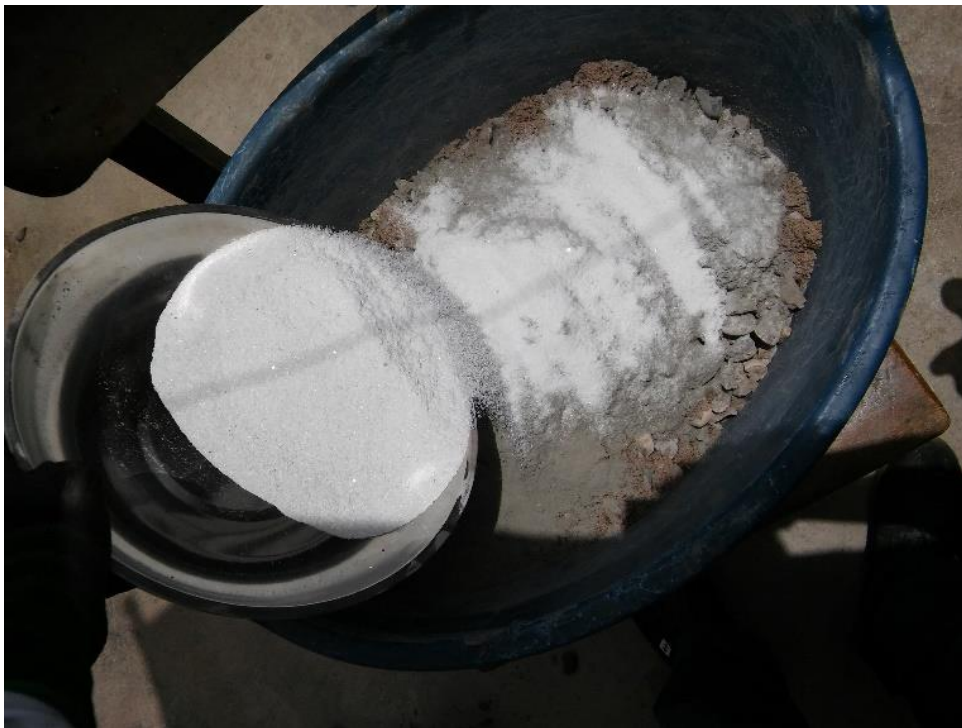
Figura 53. Incorporación del vidrio de sosa, cal y sílice a la mezcla del concreto. Fuente: Elaboración propia.
