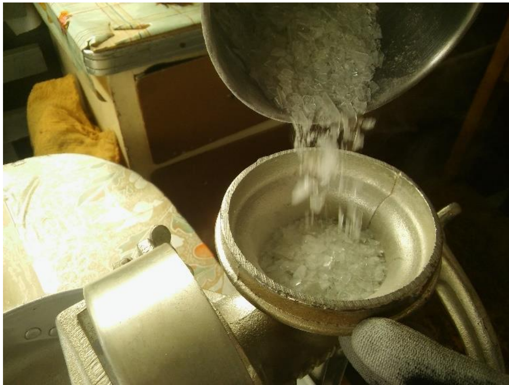
Figura 77. Vertiendo el vidrio chancado a la moledora.
