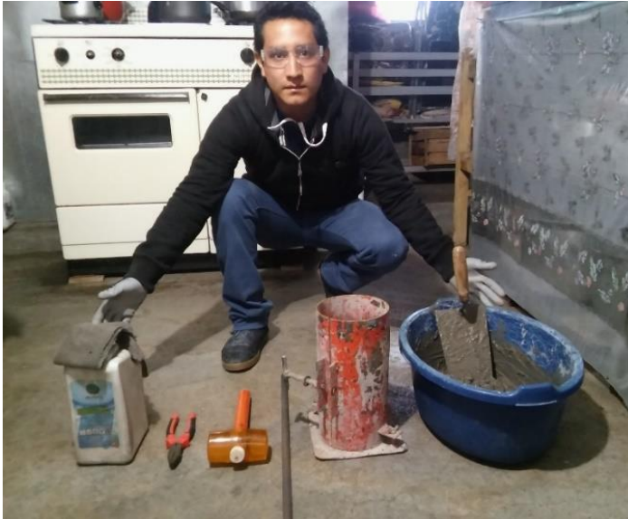
Figura 16. Equipo para la producción de las probetas de concreto. Fuente: Elaboración propia.
