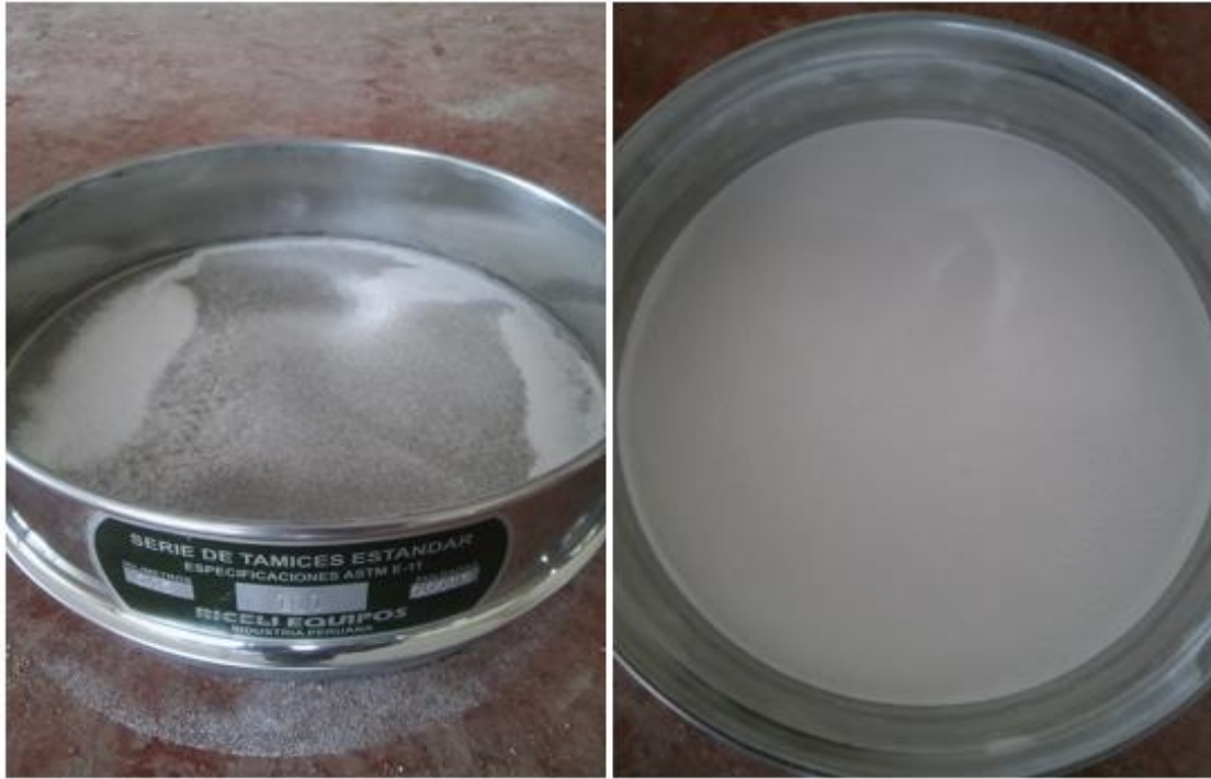
Figura 82. Resultado final del tamizado (pasa la malla N° 100) del vidrio de sosa, cal y sílice que se utilizará para ser incorporado a la mezcla del concreto F'c=210\text{Kg/cm}^2 .
