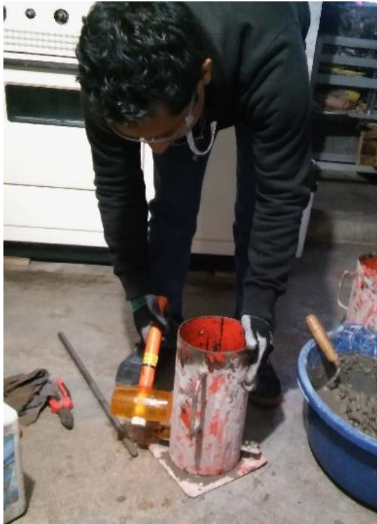
Figura 61. Golpeando el molde, 16 golpes por 4 costados, 4 en cada lado, con el martillo de goma. Fuente: Elaboración propia.
