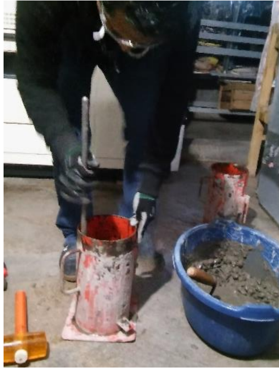
Figura 60. Chuseando la mezcla, 25 golpes por norma. Fuente: Elaboración propia.
