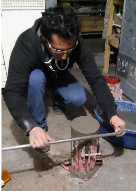
Figura 62. Nivelando la tercera capa y ultima de la probeta con la varilla. Fuente: Elaboración propia.
