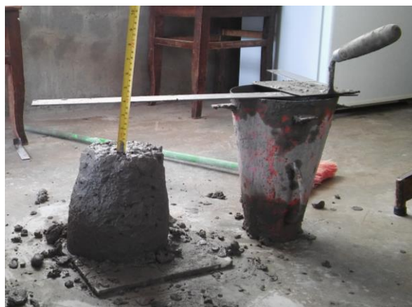
Figura 129. SLUMP para el concreto convencional.
