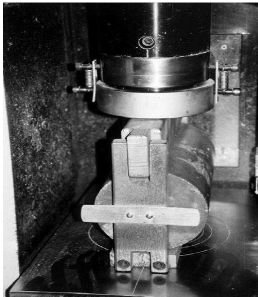
Figura 72. Cilindro colocado para ensayo de tensión indirecta
