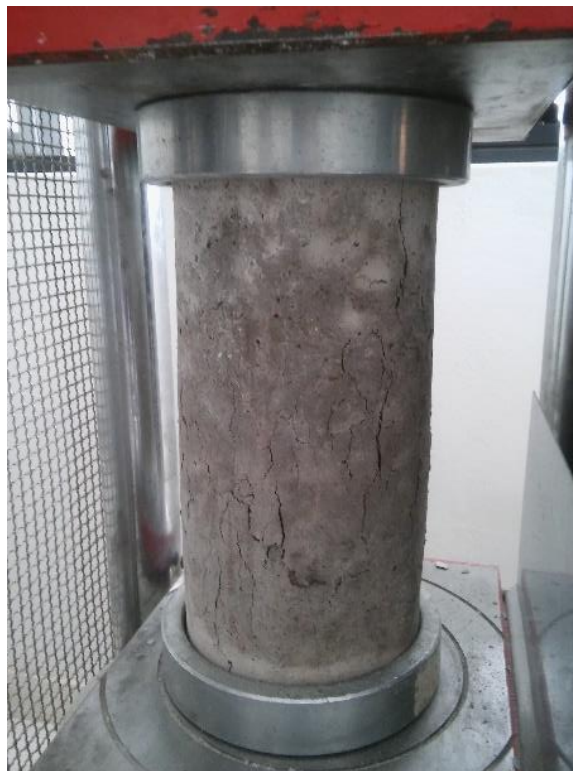
Figura 67. Falla por compresión axial. Fuente: Elaboración propia.
