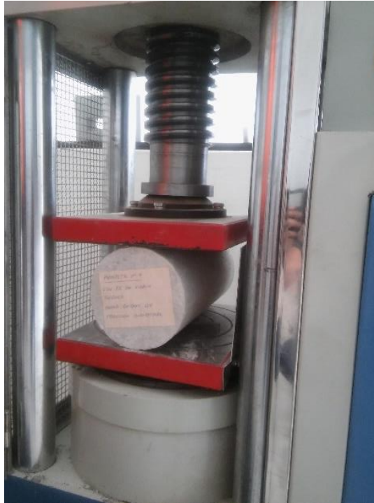
Figura 68. Falla por tracción diametral. Fuente: Elaboración propia.
