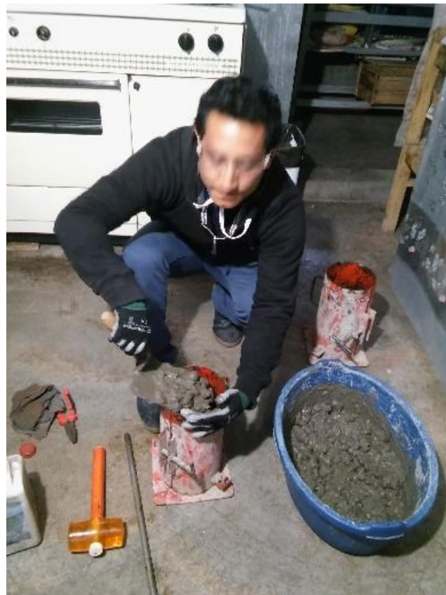
Figura 59. Llenando el molde con la mezcla de concreto. Fuente: Elaboración propia.
