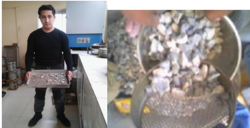
Figura 26. Zarandeo de la muestra. Fuente: Elaboración propia.
