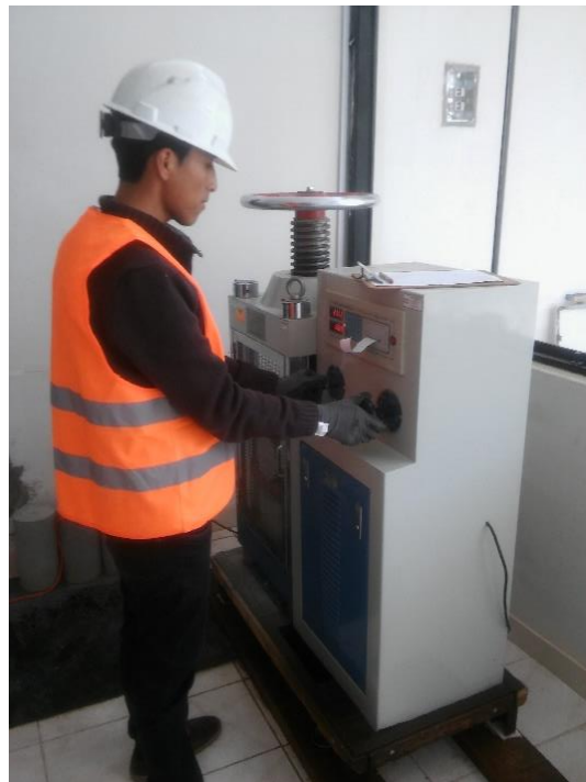
Figura 21. Máquina para ensayos de compresión axial y diametral. Fuente: Elaboración propia.
