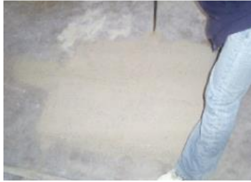
Figura 34. Cuarteo de la muestra. Fuente: Elaboración propia.
