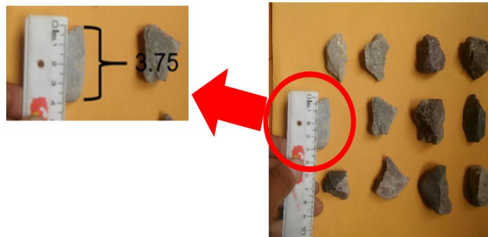
Figura 132. Evidencia de medición del agregado grueso.
