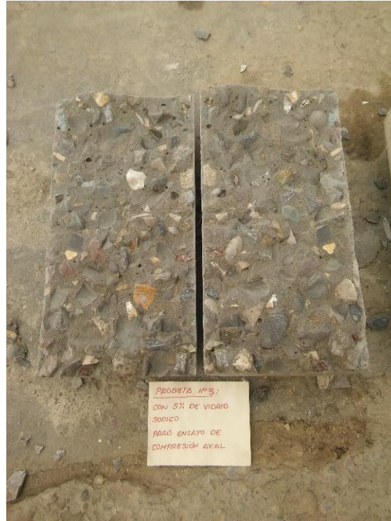
Figura 70. Distribución de los agregados, cemento y vidrio en la probeta de concreto con 5% de vidrio incorporado. Fuente: Elaboración propia.
