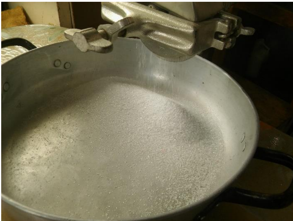
Figura 79. Resultado del vidrio al pasar por la molidora.
