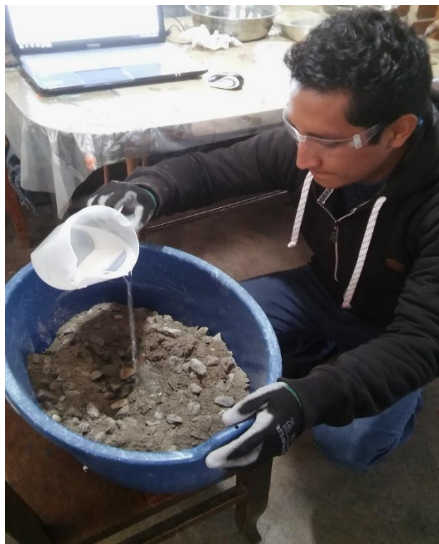
Figura 55. Incorporando agua a la mezcla. Fuente: Elaboración propia.
