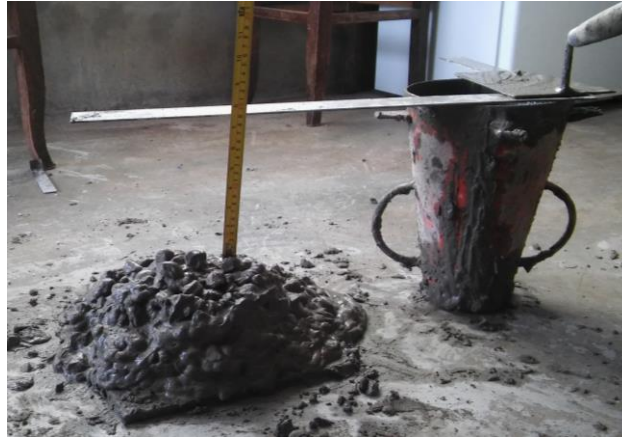
Figura 112. SLUMP para el 50% de vidrio de sosa, cal y sílice incorporado.
