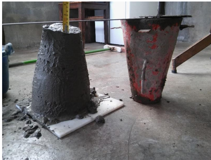
Figura 2. Ensayo de asentamiento del concreto, prueba del SLUMP. Fuente: Elaboración propia.
