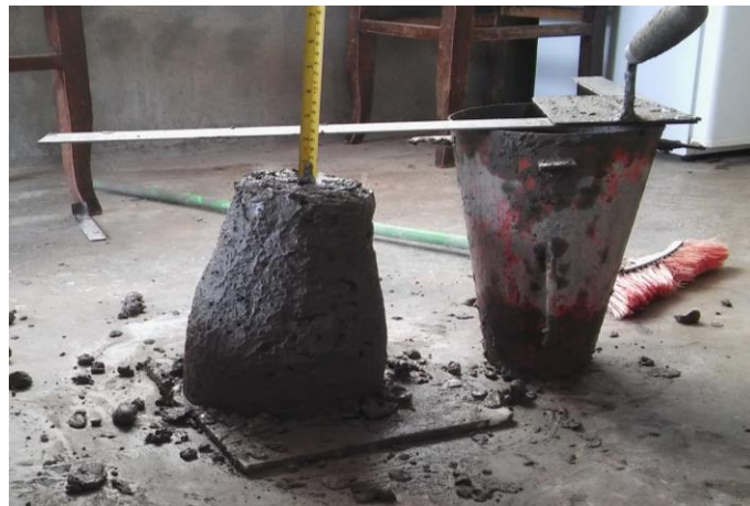
Figura 107. SLUMP para el 5% de vidrio de sosa, cal y sílice incorporado.
