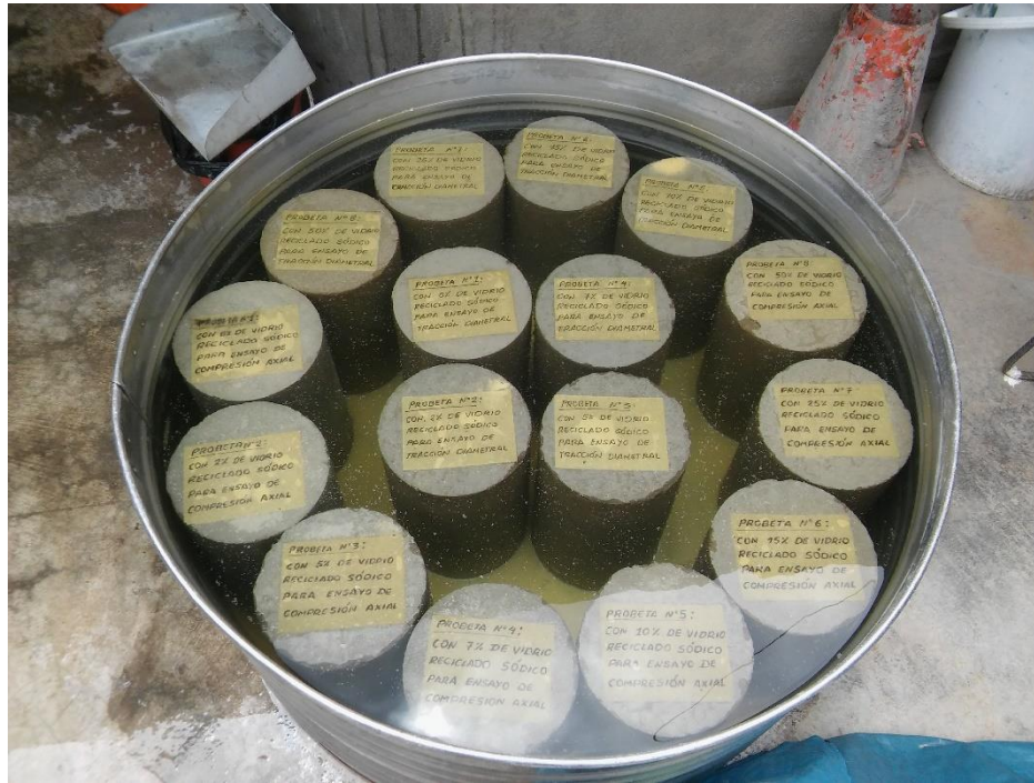
Figura 22. Perol de inox para curado de las probetas. Fuente: Elaboración propia.
