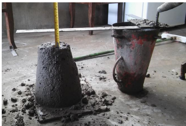
Figura 108. SLUMP para el 7% de vidrio de sosa, cal y sílice incorporado.
