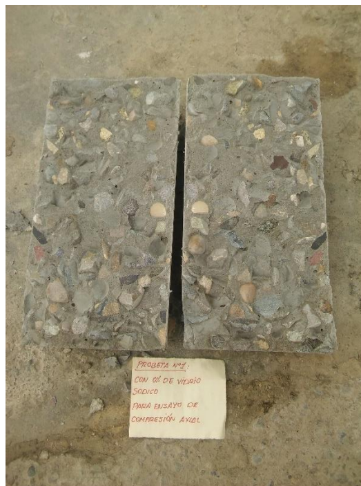
Figura 69. Distribución de los agregados y cemento en la probeta de concreto convencional. Fuente: Elaboración propia.
