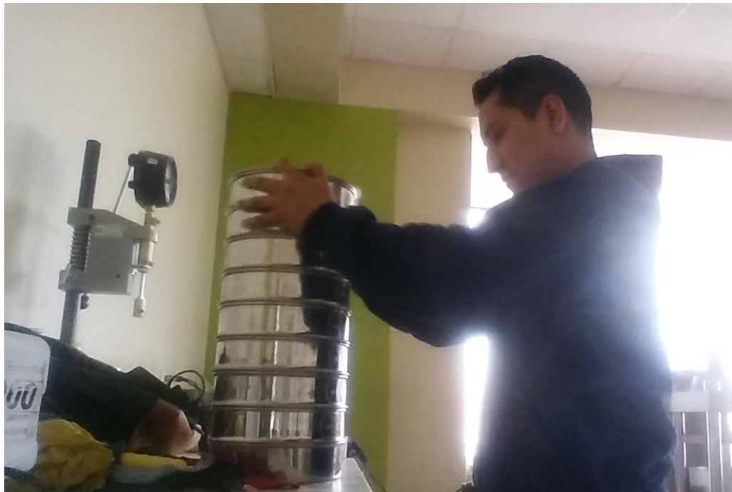
Figura 81. Movimiento de los tamices.
