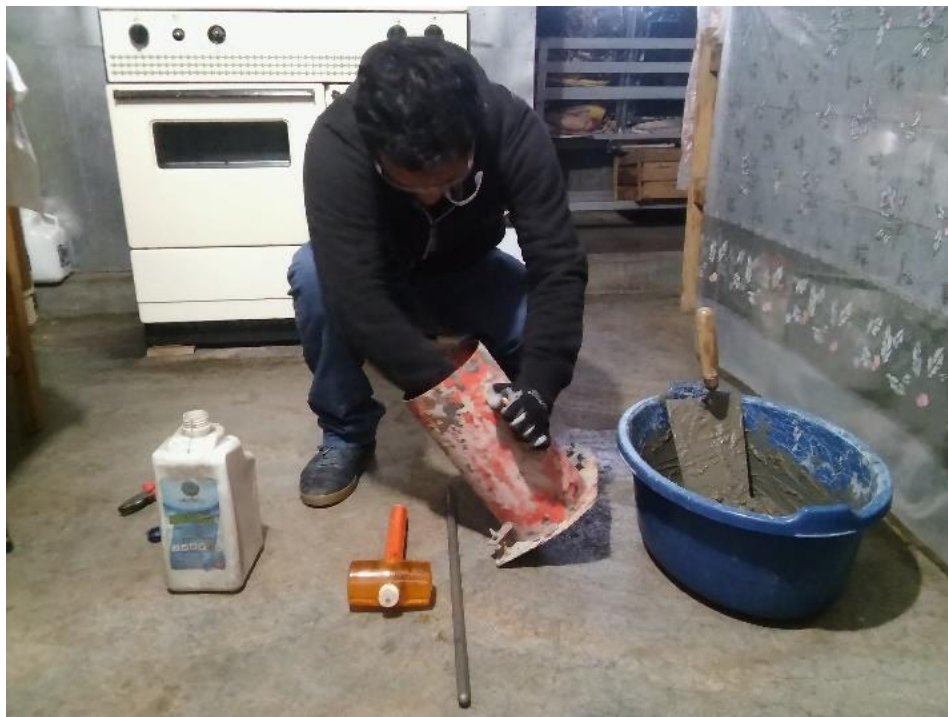
Figura 57. Empapando el molde con petróleo. Fuente: Elaboración propia.
