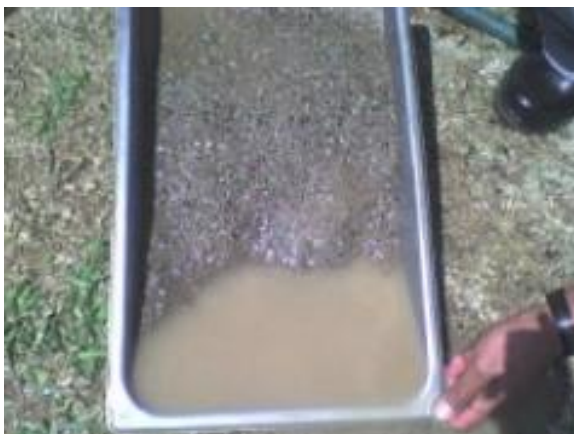
Figura 36. Lavando la muestra. Fuente: Elaboración propia.
