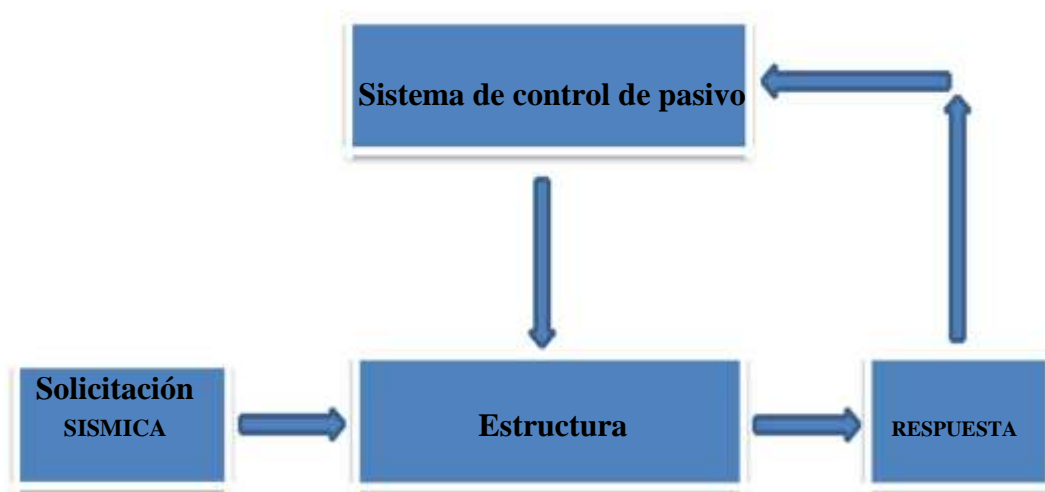
Flujograma del mecanismo de control de sistemas pasivos
