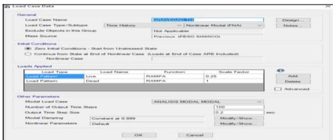
Figura 58: Definición de la carga para análisis FNA
