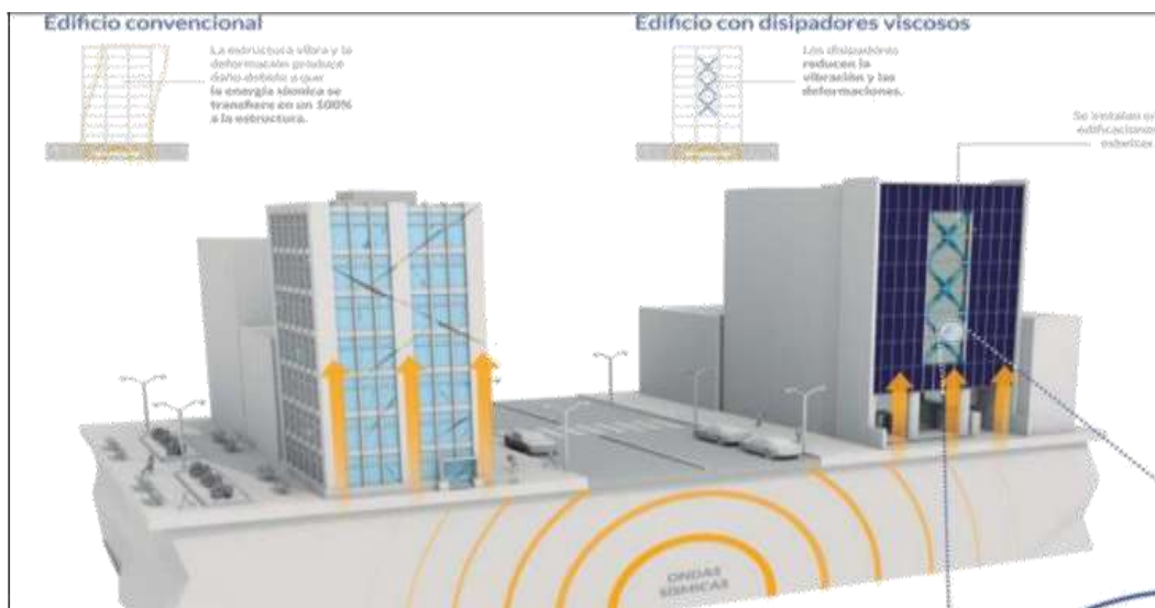
Figura 23: Comparativa entre edificación con y sin amortiguadores de fluido viscoso Fuente: CDV- Representaciones
