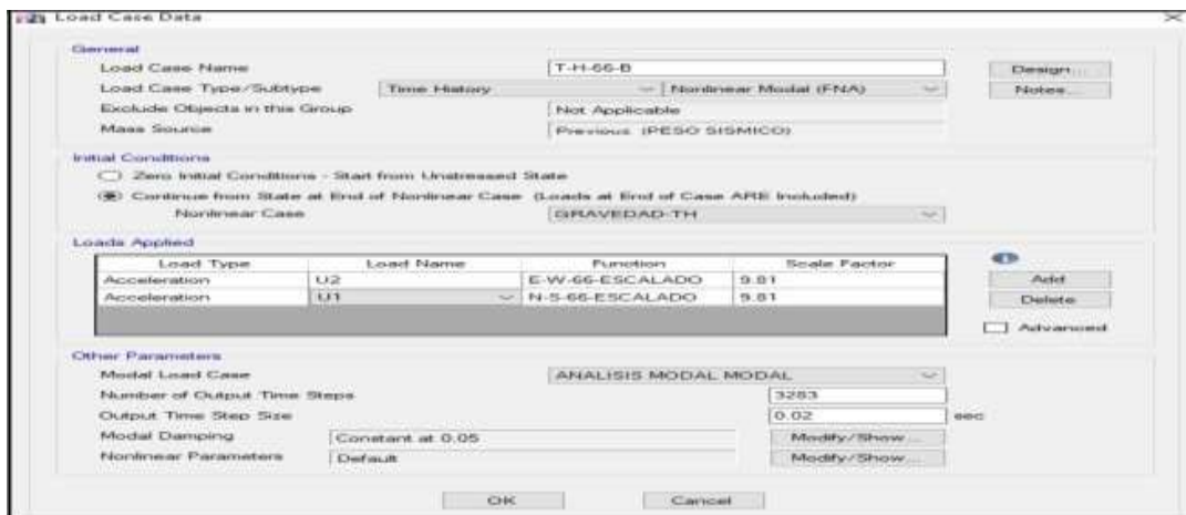
Figura 59: Definición del número de pasos para el análisis FNA dirección X-X
