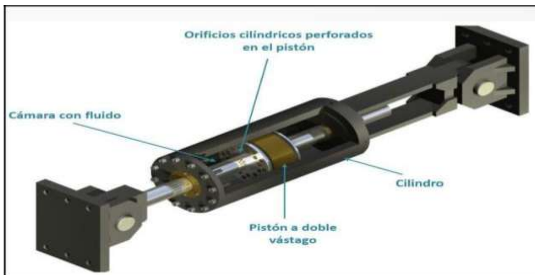
Figura 24: Esquema 3D del Amortiguador de Fluido Viscoso Fuente: CDV- Representaciones
