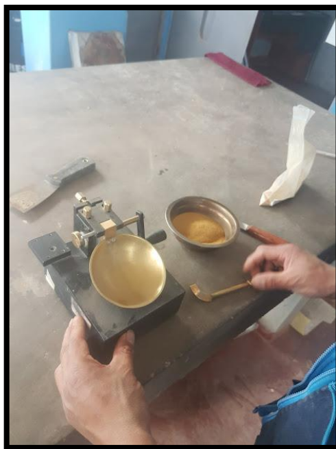
Imagen 14: ensayo para el límite líquido
