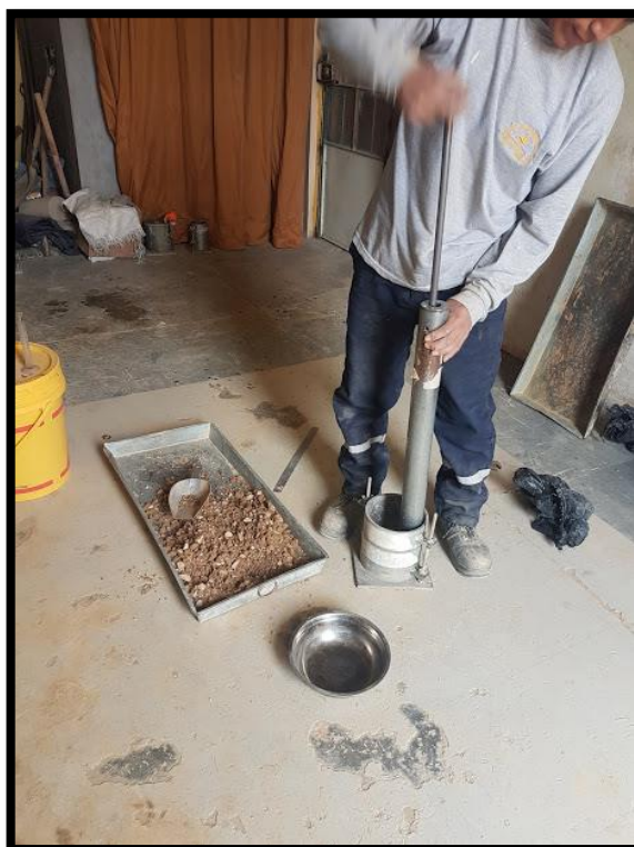
Imagen 16: compactación de material préstamo
