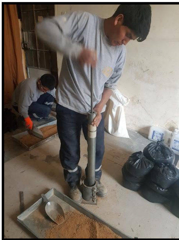
Imagen 15: compactación de material de calicata
