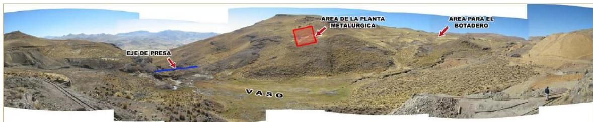
Figura N°3 Vista mostrando el área prevista para el emplazamiento de la Planta Metalúrgica, ubicada en la ladera derecha de la Quebrada Sayocomana, interesando depósitos morrénicos y afloramientos aislados de rocas volcánicas.
