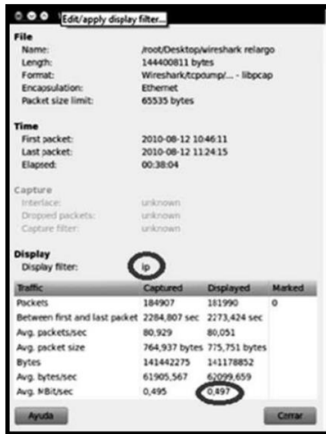
Fig. 23: Velocidad de transferencia de la red.
