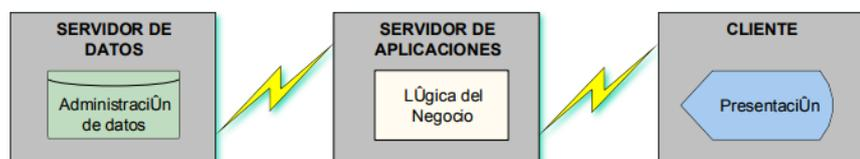
Fig. 2.2 - Arquitectura cliente – servidor en 3 capas
