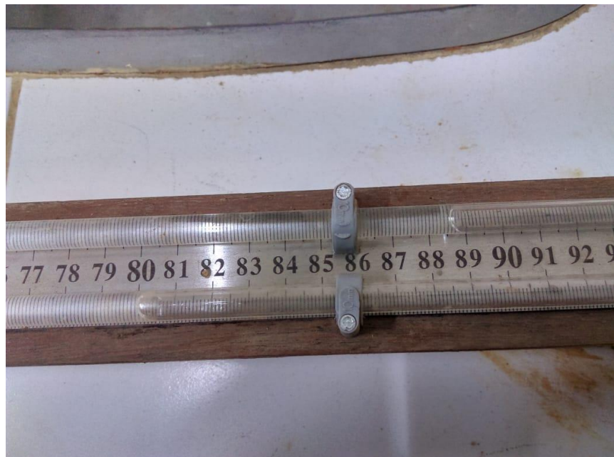
Figura 115: Las lecturas se realizan con el menisco como se muestra en la figura donde las lecturas serán 88.5 cm y 80 cm.
