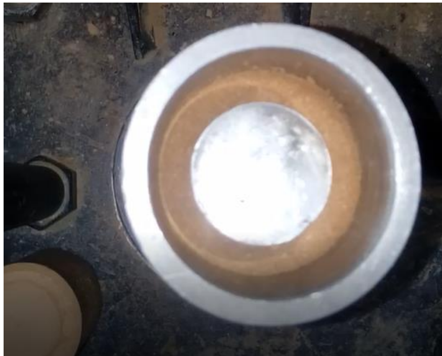
Figura 135: Disco espaciador, siempre al centro de cp cuero de prueba. Fuente: Propia.
