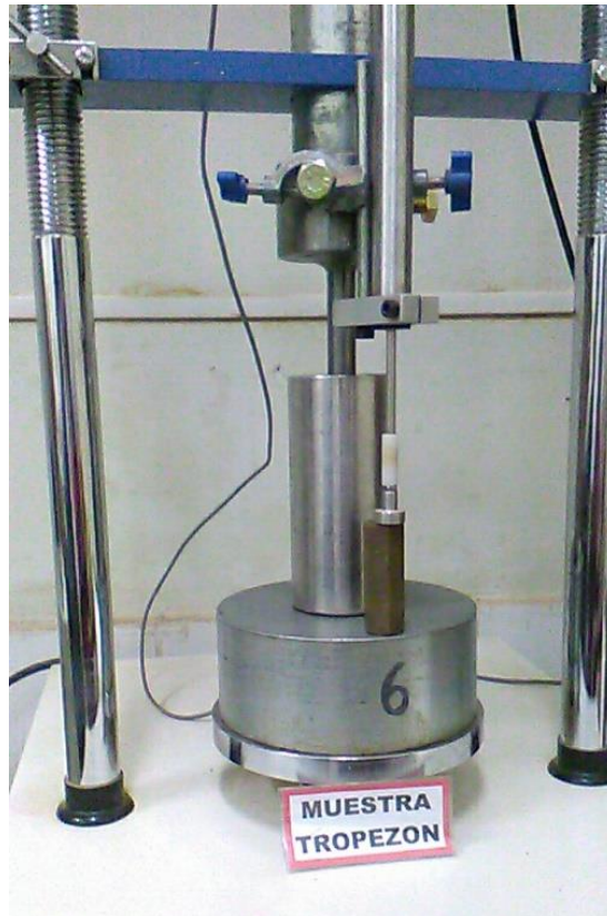
Figura 84: Instalación final del equipo con todos los sensores electrónicos penetración Mini-CBR de la muestra Tropezón. Fuente: Propia.
