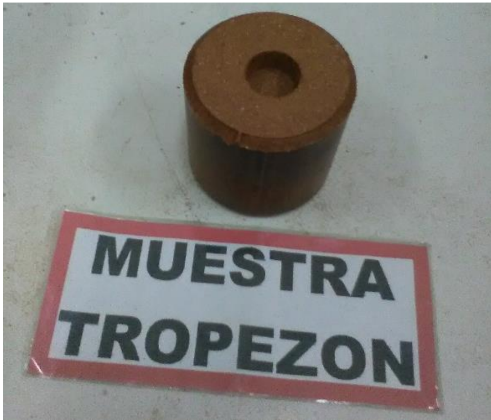
Figura 105: Cuerpo de prueba ya penetrado por el ensayo Mini-CBR. Fuente: Propia.
