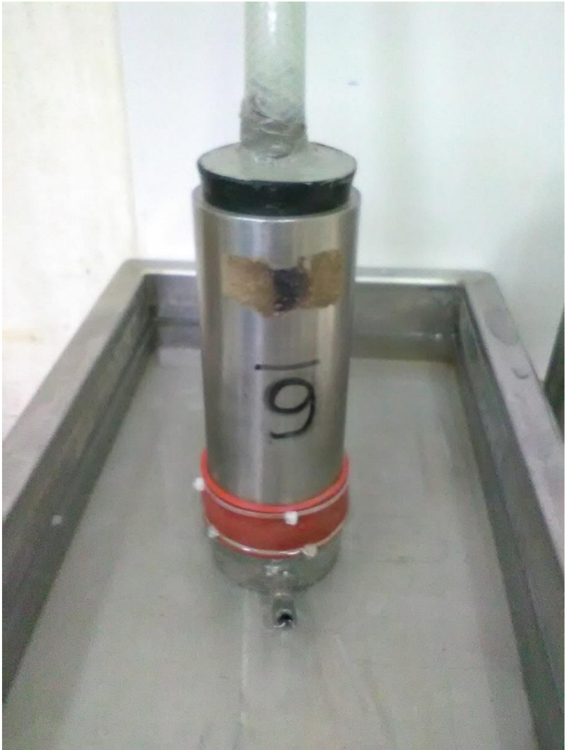
Figura 127: Sellado de la manguera y el tapón de jebe con silicona gris. Fuente: Propia.
