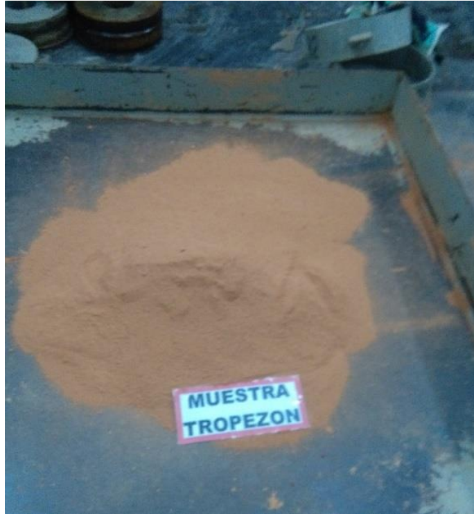
Figura 62:Disgregado al aire libre de la muestra Tropezón. Fuente: Propia.
