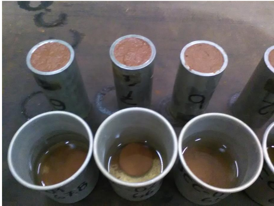
Figura 166: Muestras extraídas desprendidas después de estar sumergidas 24 horas Fuente: Propia
