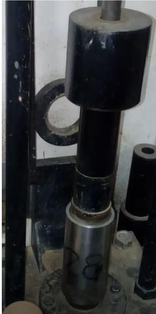
Figura 136: Compactación del Cp con el martillo intermedio. Fuente: Propia.
