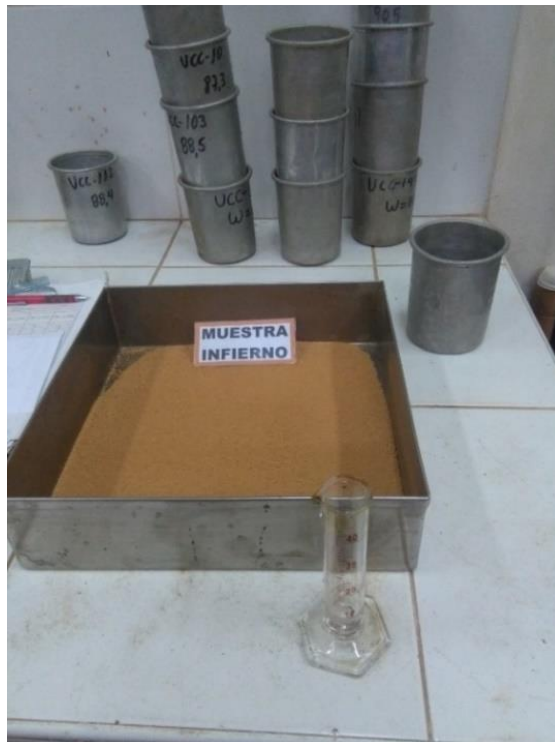
Figura 67: Muestra de 500 gr preparada para el primer punto del ensayo mini Proctor. Fuente: Propia.
