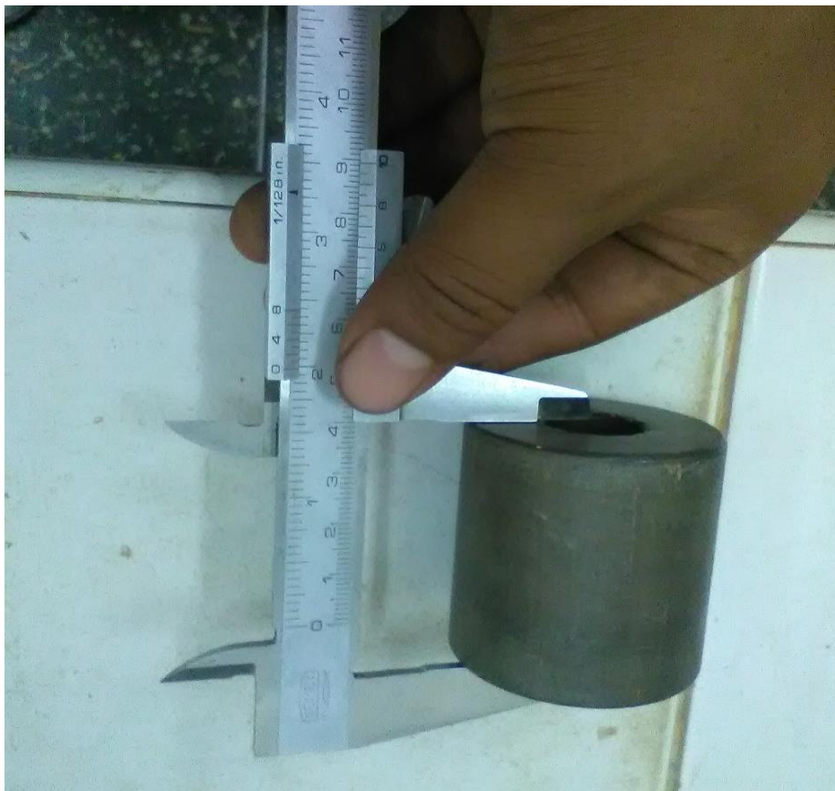
Figura 75: Medición del cilindro patrón. Fuente: Propia
