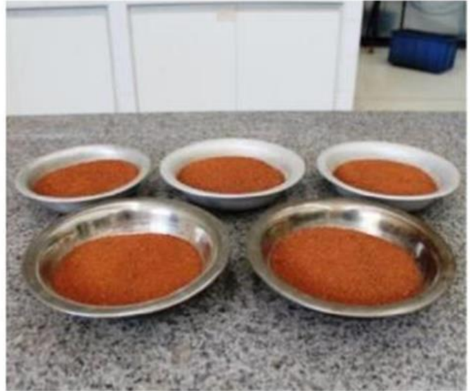
Figura 70: División de la muestra en cinco porciones. Fuente: Libro de “Aplicación de práctica de Mini Proctor”, de Villibor y Nogami, 2014, Pág. 4.
