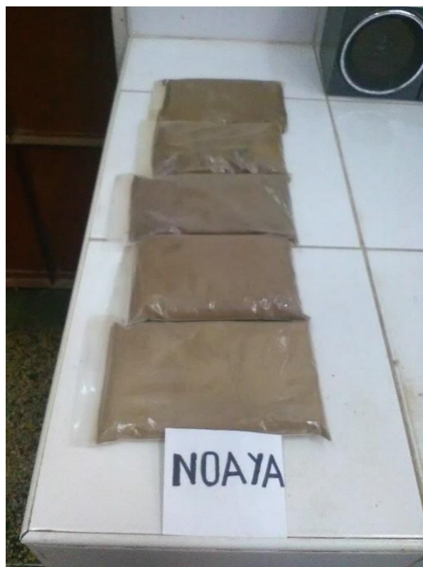
Figura 73: Muestras con diferentes cantidades de humedad siendo esta muestra arenosa con limo con 500 g c/u. Fuente: Propia.
