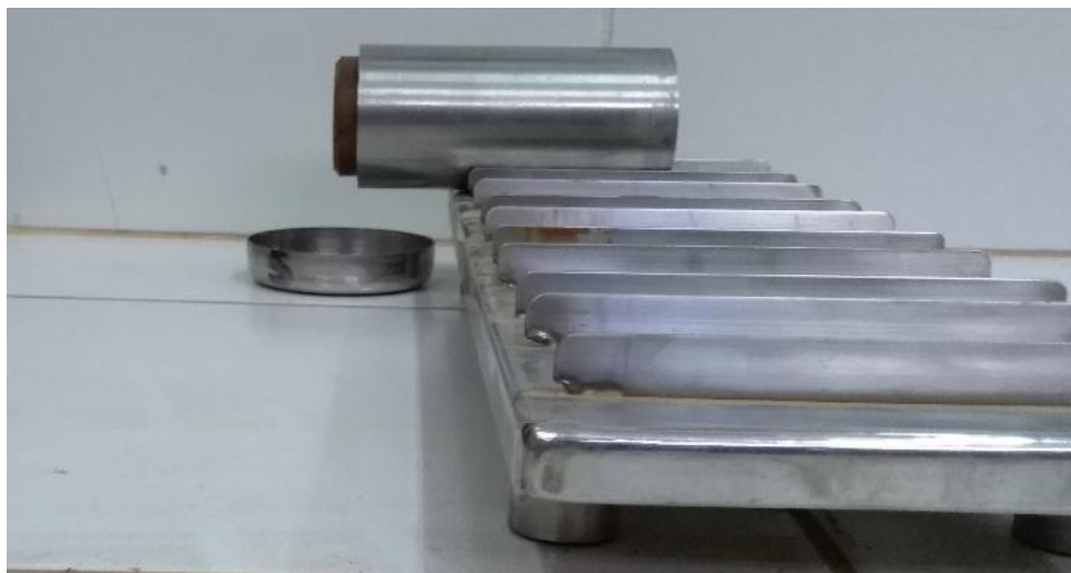
Figura 151: Soporte que mantiene los molde en posición horizontal. Fuente: Propia
