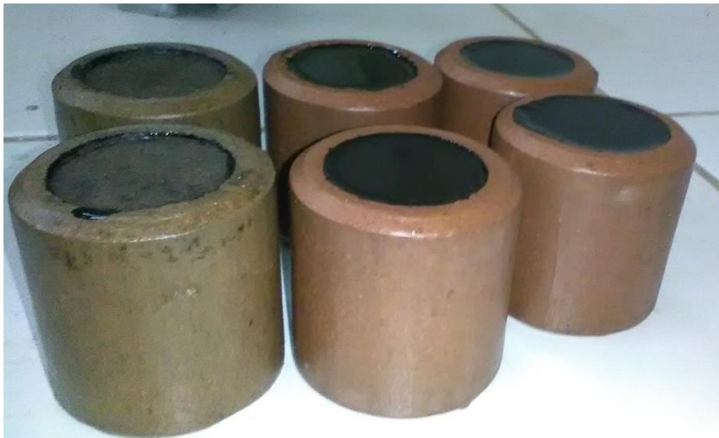
Figura 144: Muestra con imprimación bituminosa a la izquierda Noaya a medio Tropezón y a la derecha Infierno. Fuente: Propia
