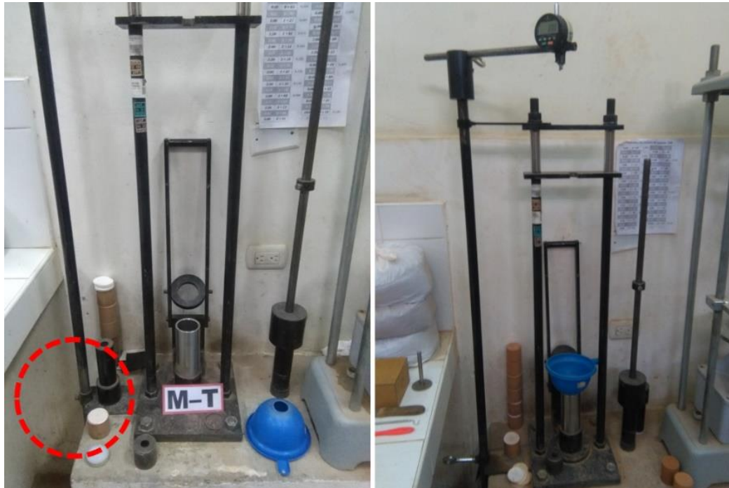
Figura 57: Colocación del sujetador de la barra vertical. Fuente: Propia.
