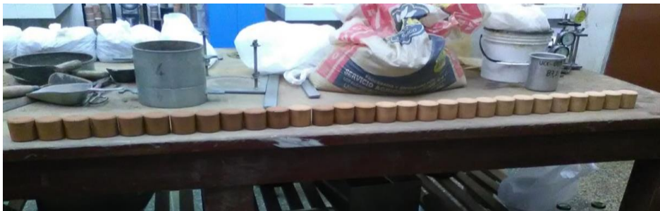
Cuerpos de prueba expulsados con distintas humedades
