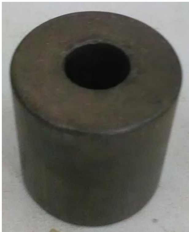
Figura 89: Sobrecarga perforada patrón de 50 mm de \varnothing la perforación es de diámetro es de 17 mm. Fuente: Propia.
