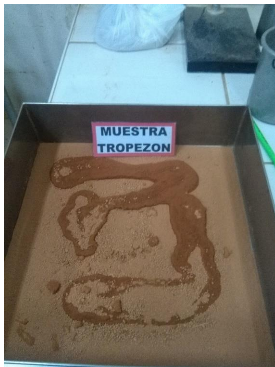
Figura 69: Agua vertida en el primer punto del ensayo de mini-Proctor donde se procede a mezclar y homogenizar.
