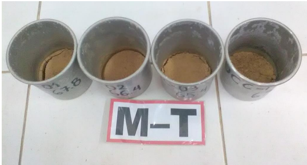
Figura 168: Muestras salidas de horno y listas para calcular la Pi. Fuente: Propia.
