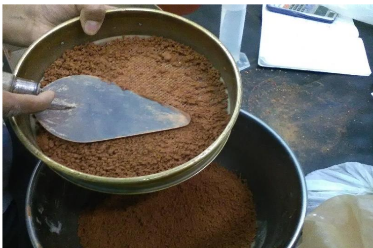
Figura 54: Repaso de los grumos de suelo por la malla número 10. Fuente: Propia
