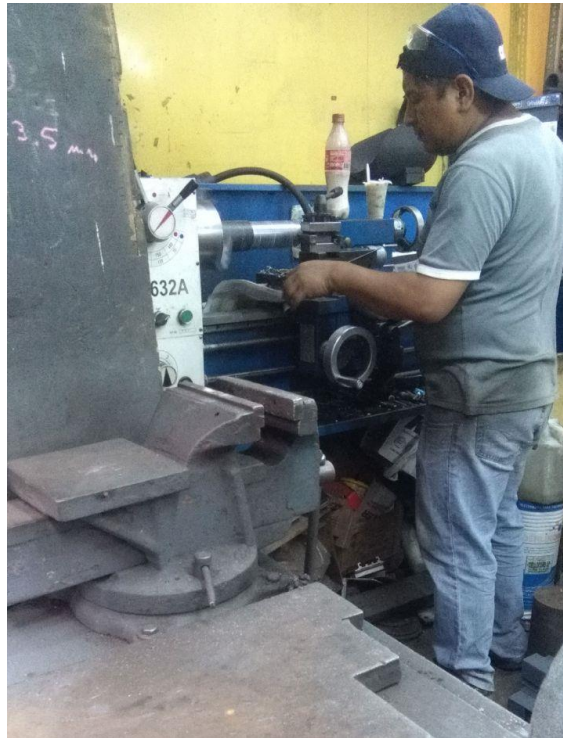
Figura 96: Torneado del acero VCL por el operario especialista. Fuente: Propia.
