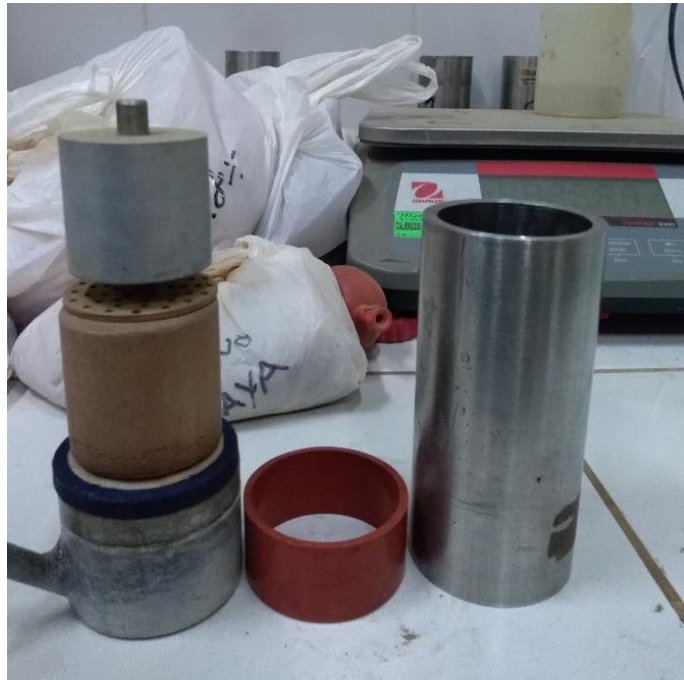
Figura 113:Equipos y materiales en el orden que se coloca antes del ensayo Fuente propio
