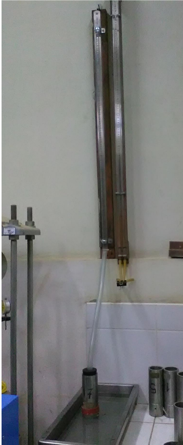
Figura 125: Vista panorámica del equipo de permeabilidad con tubo de 16 mm Ø. Fuente: Propia.
