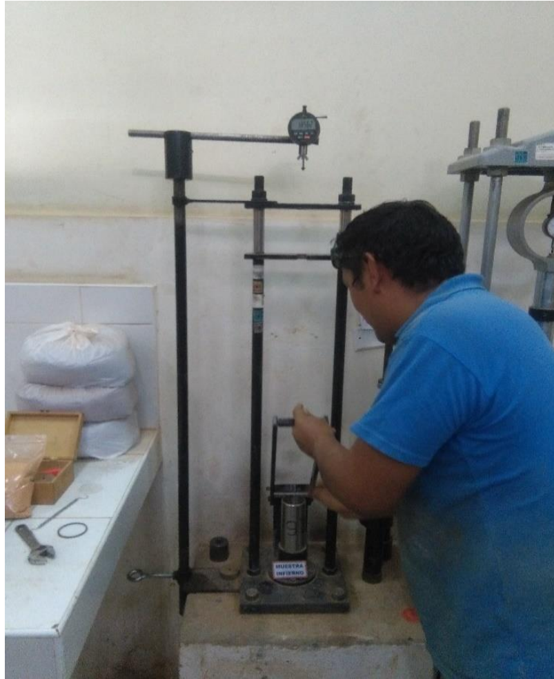
Figura 37:Empujando la muestra con la ayuda del extractor Fuente: Propia.
