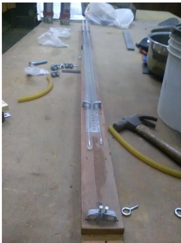
Figura 111: Colocación de la regla metálica y de las grapas para asentar los tubos de vidrio.
