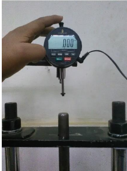
Figura 47: Dial electrónico, posición para medición de cp mini Proctor. Fuente: Propia.
