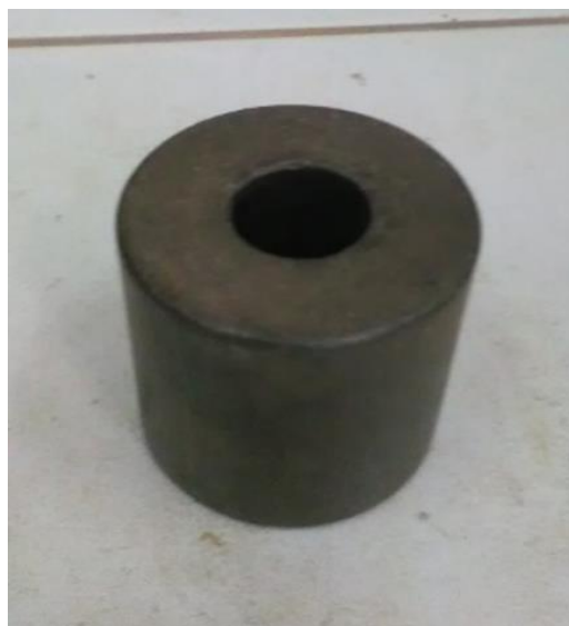
Figura 48: Cilindro perforado para uso de calibración y guía de penetración Mini-CBR. Fuente: Propia.
