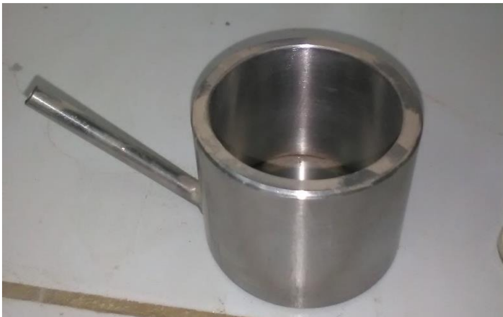
Figura 109: Recipiente base de 50.0 mm de diámetro interior. Fuente: Propia.
