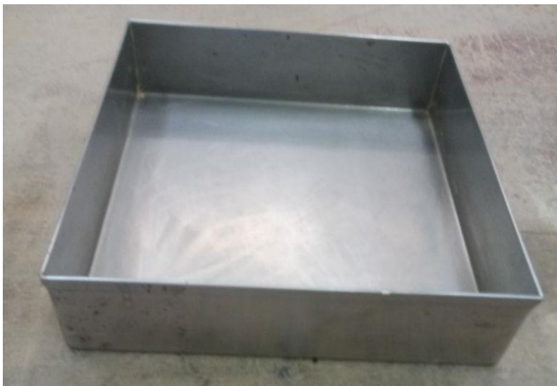
Figura 53: Bandeja de acero inoxidable para el mezclado de muestras y agua Fuente: Propia.
