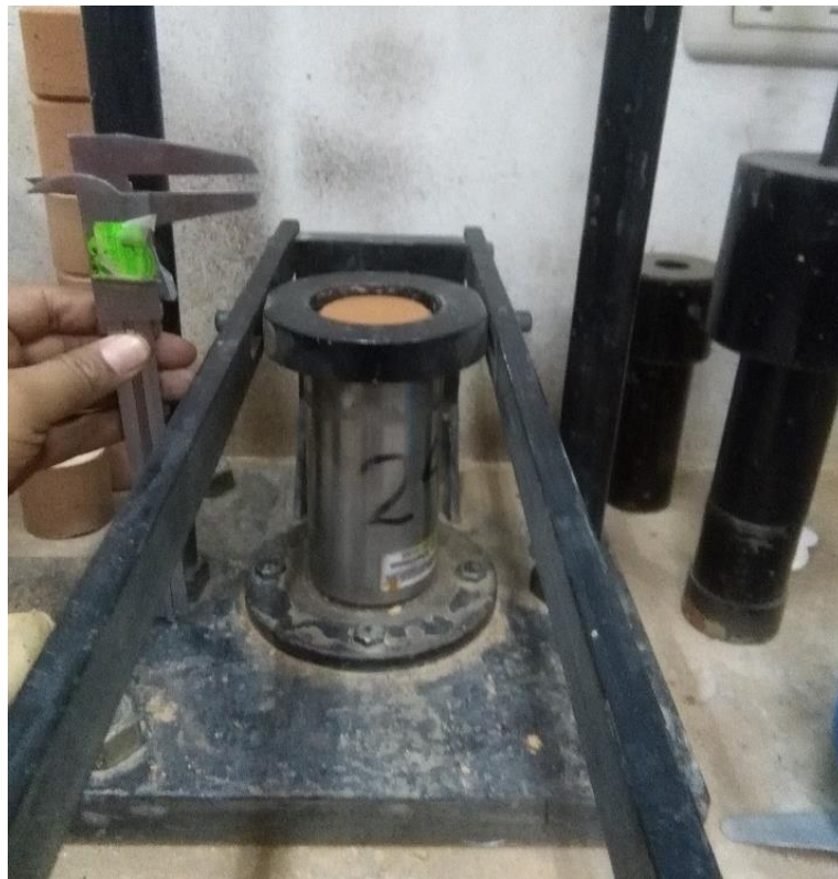
Figura 155: Procediendo a expulsar el cuerpo de prueba. Fuente: Propia.
