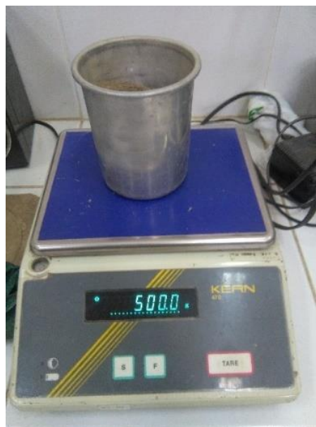
Figura 74: Pesado de una porción para determinar el contenido de humedad. Fuente: Propia.
