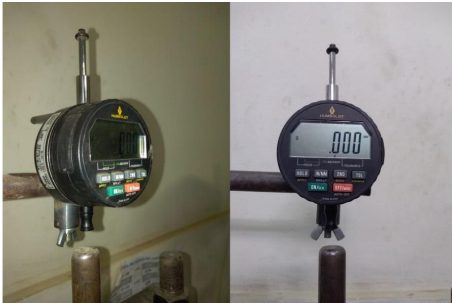
Figura 131: Posición del dial para empezar el ensayo Mini-MCV Fuente: Propia.
