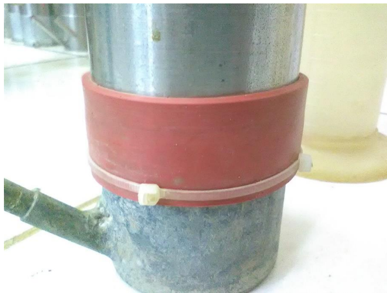
Figura 114:La función del tubo de jeringa ayuda a que sea más hermético. Fuente: Propia
