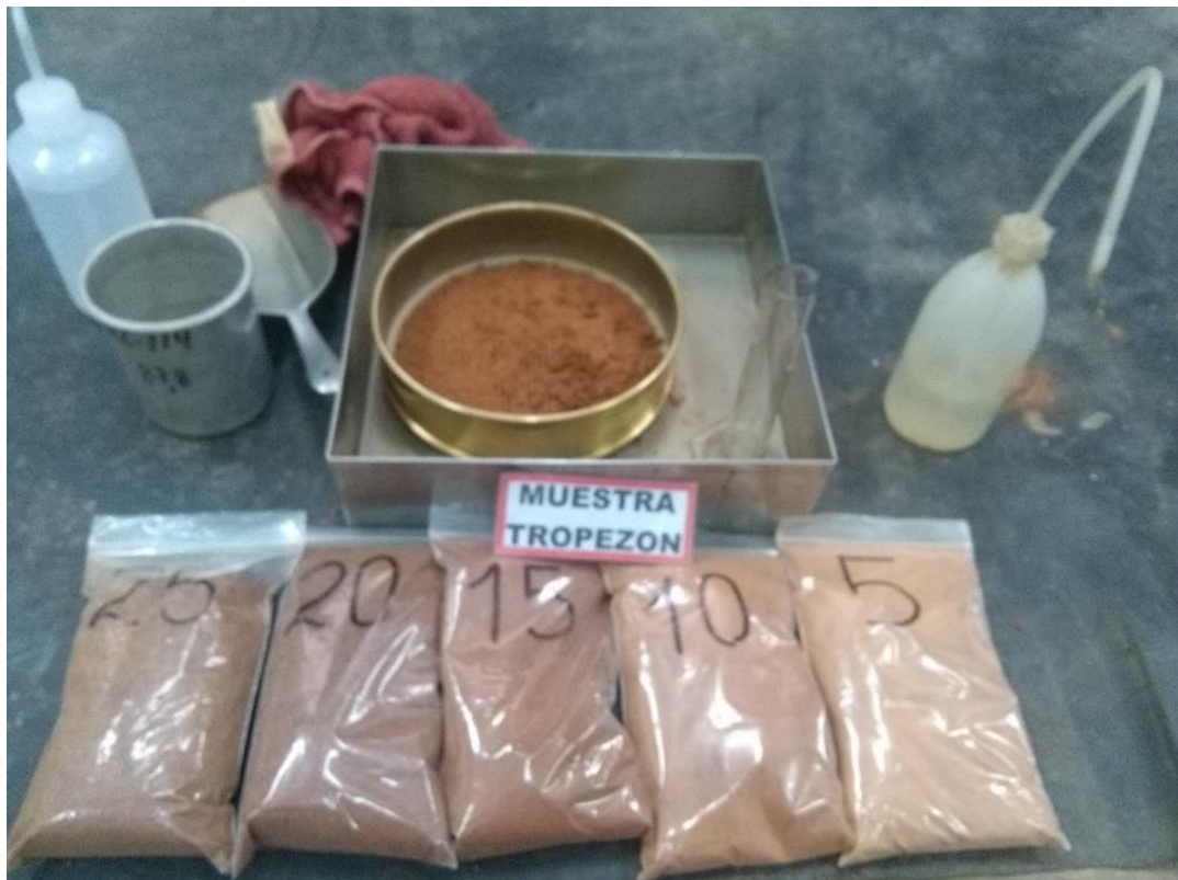
Figura 71: Muestras húmedas que tengan grumos deberán ser repasados en el tamiz. Fuente: Propia
