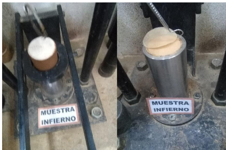
Figura 78:Expulsión del cuerpo prueba (Cp) con la palanca de extracción y retirada del anillo y el disco de polietileno. Fuente: Propia.
