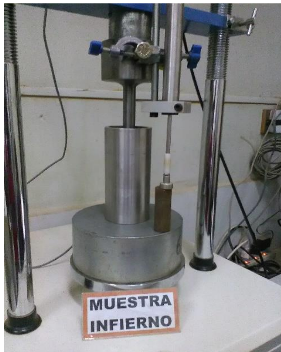
Figura 85: Instalación final del equipo con todos los sensores electrónicos penetración Mini-CBR de la muestra Infierno. Fuente: Propia
