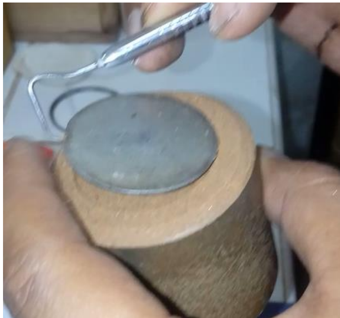
Figura 137: Expulsión del disco espaciador. Fuente: Propia
