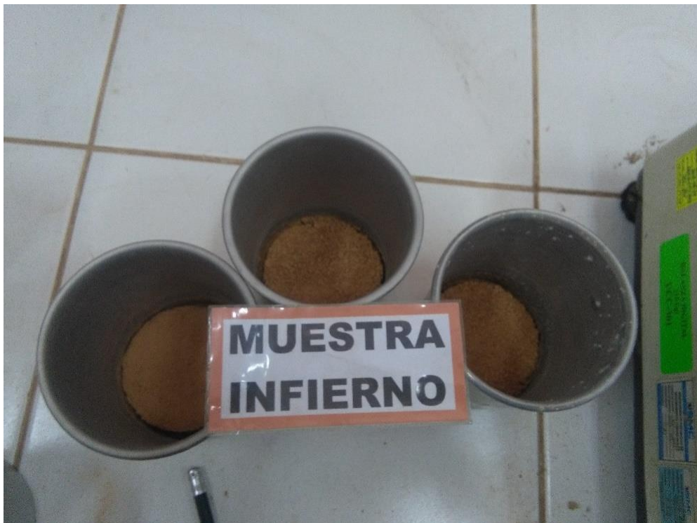
Figura 167: Una vez extraídas ponerlas en el horno hasta que seque toda el agua Fuente: Propia.
