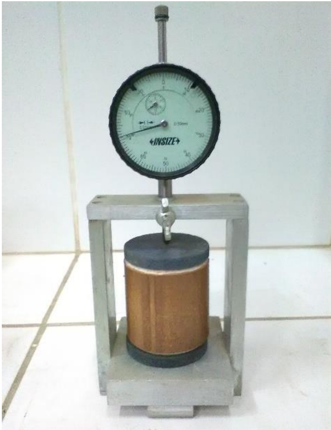
Figura 106: Contracción de la muestra Tropezón sin sobre carga. Fuente: Propia.
