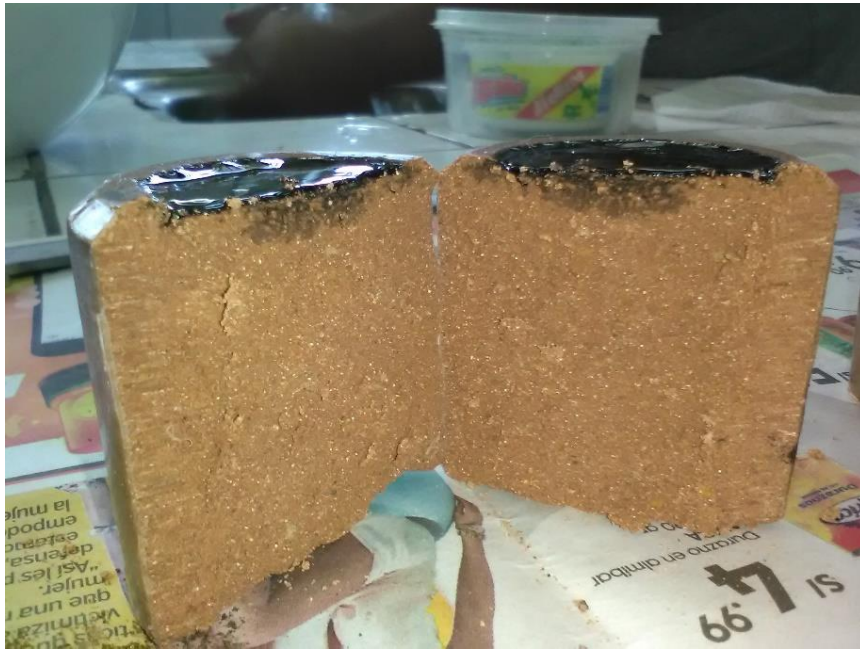
Figura 147: Medición de la penetración de la muestra de Tropezón. Fuente: Propia
