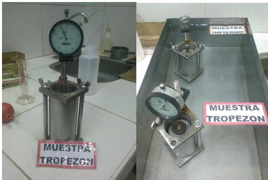
Figura 99: Expiación sumergida con carga de 490 gramos para penetración en Mini-CBR. Fuente: Propia
