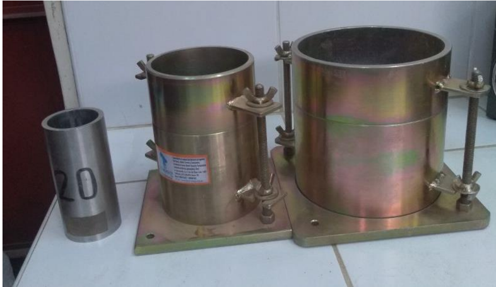
Figura 39: Moldes de Mini-Proctor, Proctor modificado de 4" y 6" Fuente: Propia.
