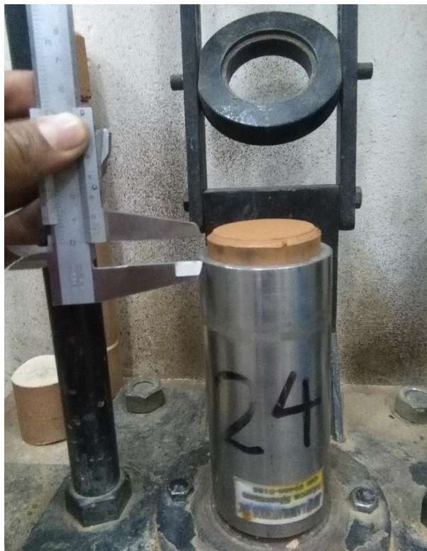
Figura 157: Medición del cuerpo parcialmente expulsado con un vernier. Fuente: Propia
