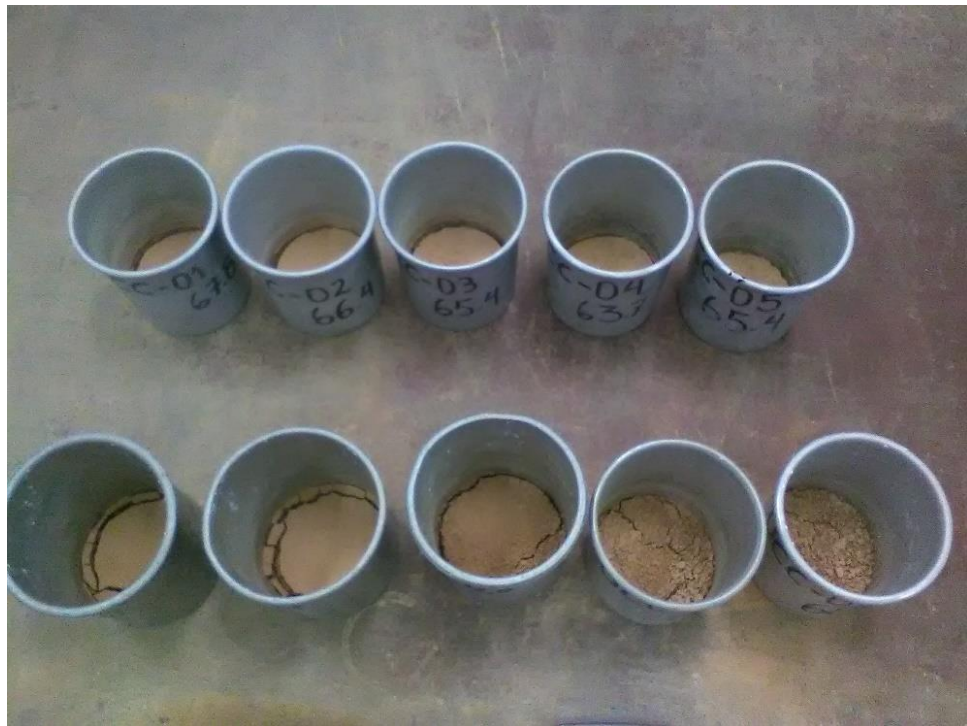
Figura 169: Muestras salidas del horno listas para el cálculo Pi. Fuente: Propia.
