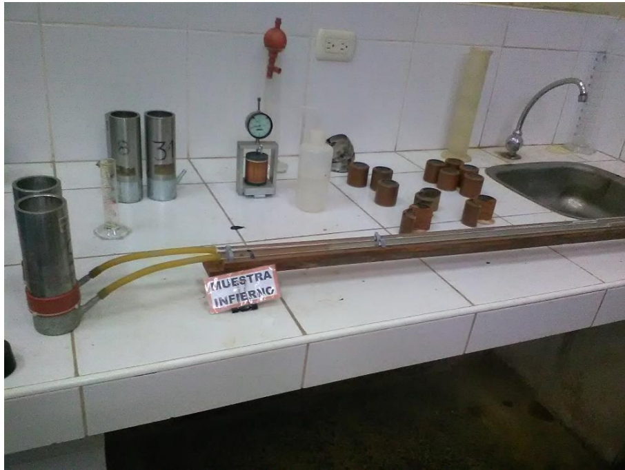
Figura 119: Ejecución de infiltrabilidad de la muestra Infierno. Fuente: Propia.
