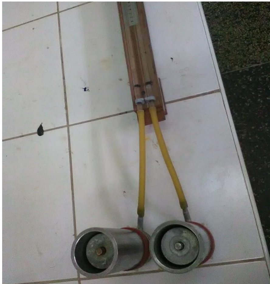
Figura 118: Colocación de las sobrecargas de 490 g encima del Cp. Fuente: Propia.
