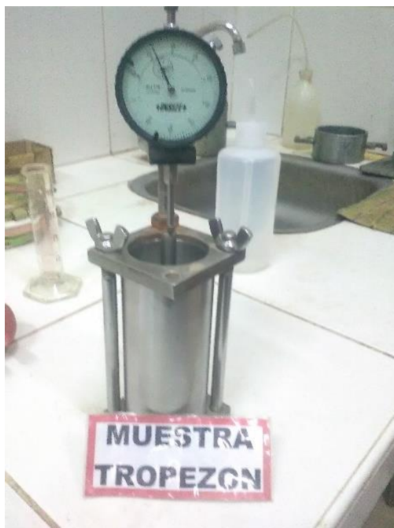
Figura 87: Armazón para determinar la expansión Conforme a la norma DER o la DNIT. Fuente: Propia.
