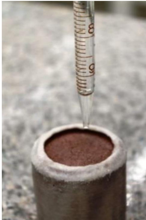
Figura 139:Humedecimiento de CP. Fuente: Ensayo de penetración de imprema dura DERP
