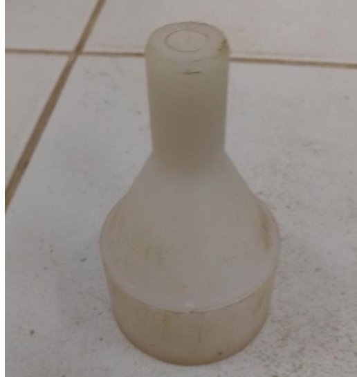
Figura 55:Asentador para las muestras de suelo y asentador de los discos de los ensayos bituminosos. Fuente: Propia.
