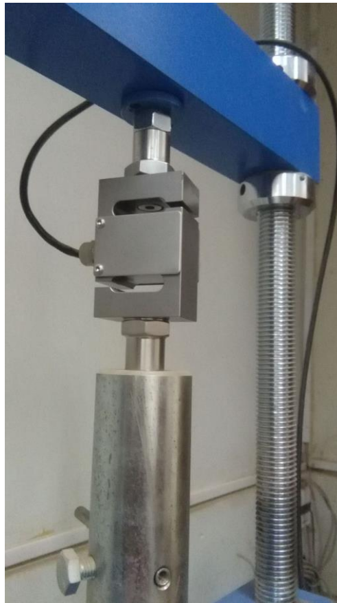
Figura 81: Al no tener anillo dinamométrico se contaba con una celda S con capacidad de carga de 500kgm. Fuente: Propia.
