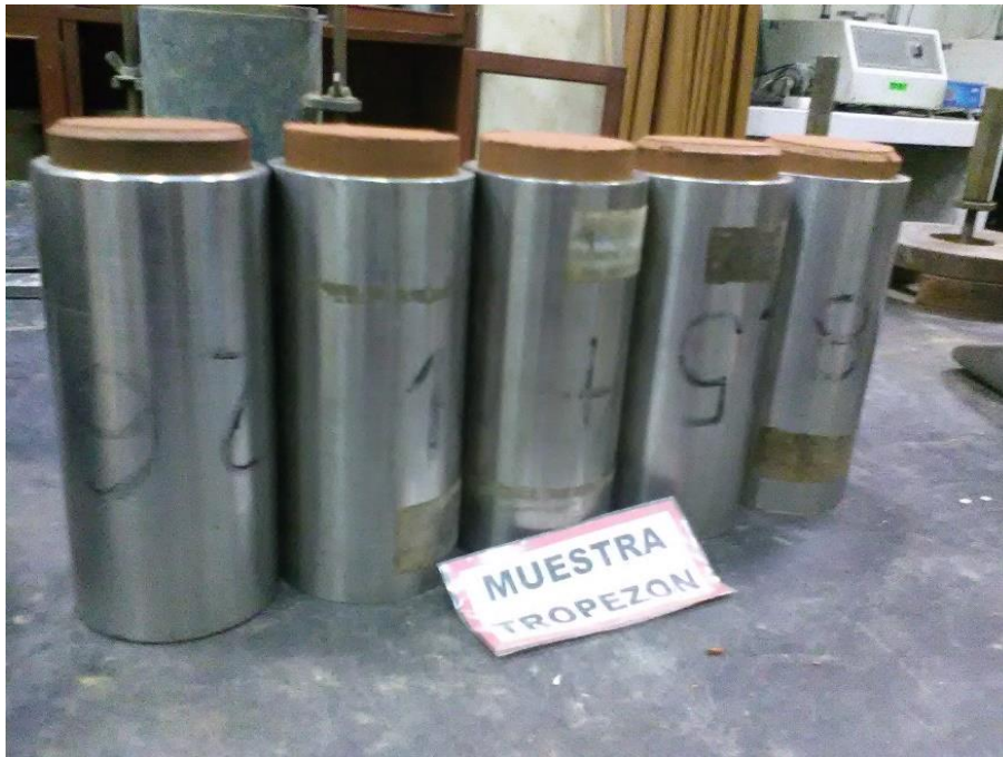
Figura 160: Los 5 cuerpos de prueba del ensayo Mini-MCV con expulsión de 1 cm cada una con distintas humedades. Fuente: Propia
