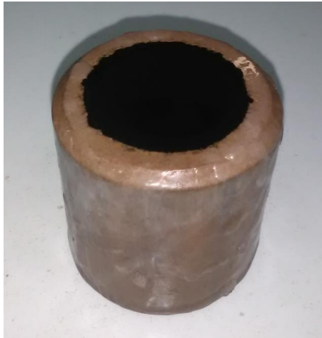
Figura 143: Muestra con imprimación bituminosa, mezcla de Infierno. Fuente: Propia
