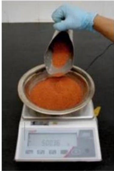
Figura 70: División de la muestra en cinco porciones. Fuente: Libro de “Aplicación de práctica de Mini Proctor”, de Villibor y Nogami, 2014, Pág. 4.
