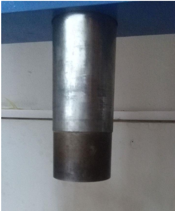
Figura 82: Pistón de penetración de 50 mm de \varnothing para CBR normal.
