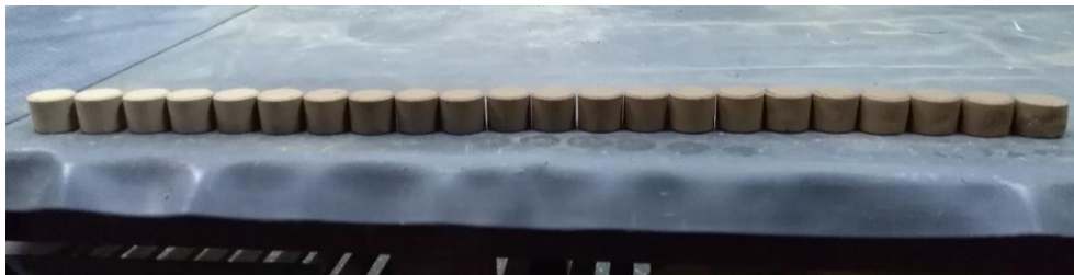
Cuerpos de prueba expulsados con distintas humedades
