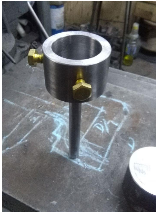
Figura 97: Acabado final del accesorio DM 5016 con tornillos de bronce para el ajuste Fuente: Propia.
