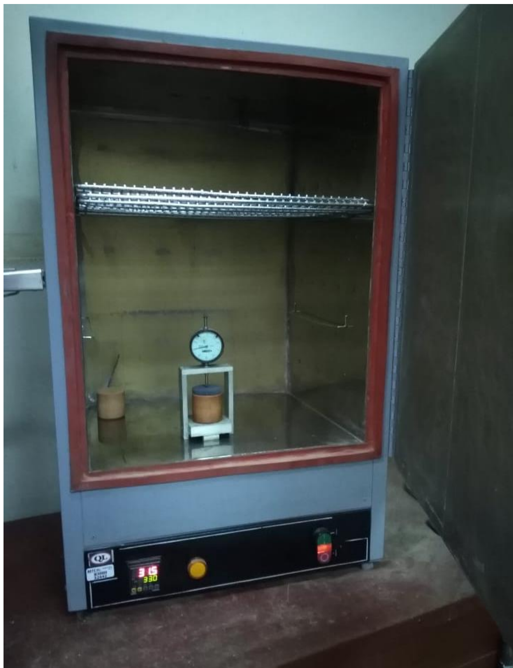
Figura 108: Ensayo de contracción en el horno. Fuente: Propia.
