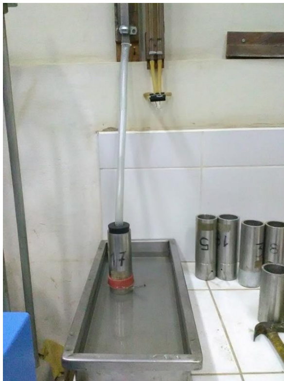
Figura 124: Instalación de la manguera de silicona de 16 mm de \varnothing interior. Fuente: Propia.
