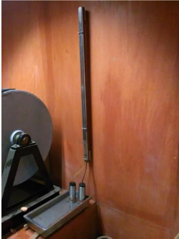
Figura 121: Ejecución del ensayo de Permeabilidad con tubos de 5 mm \varnothing Fuente: Propia
