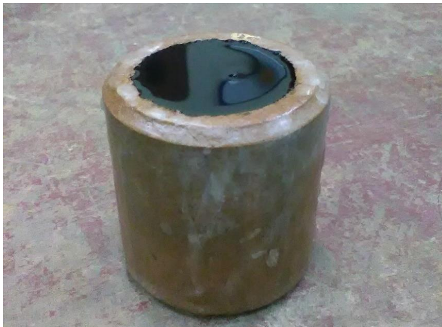
Figura 142:Muestra con imprimación bituminosa, mezcla de Tropezón. Fuente: Propia.
