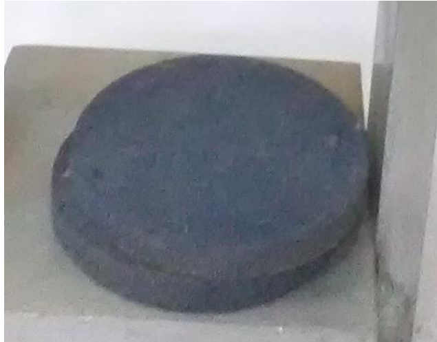
Figura 110: Piedra porosa que se coloca entre el recipiente base y el molde con el cp. Fuente Propia.
