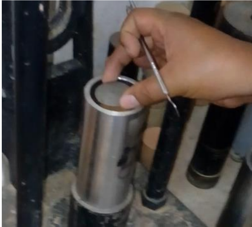
Figura 134: Colocación del disco espaciador de 35 mm de \varnothing y 1.5 mm de espesor. Fuente: Propia.
