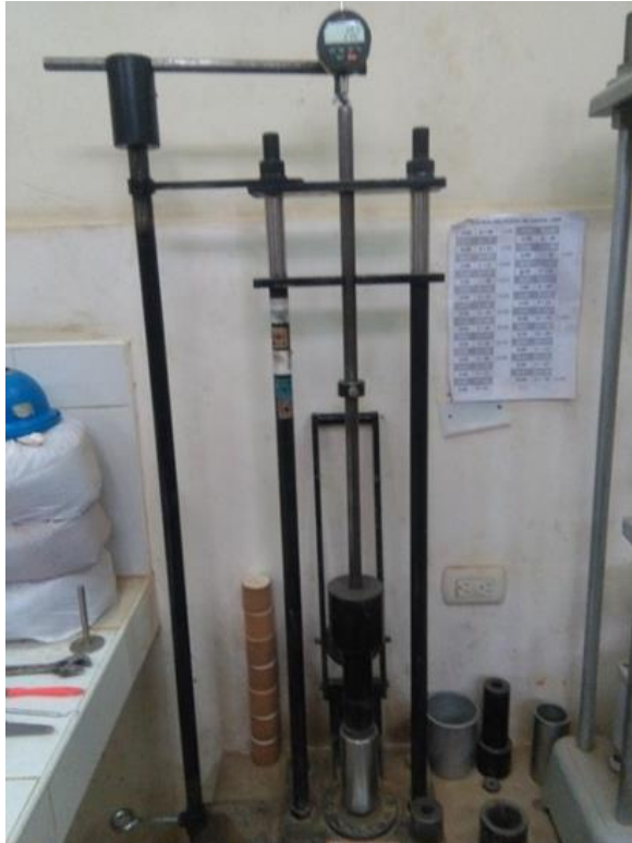
Figura 132: Equipo de compactación para ensayos de Mini-Proctor y Mini-MCV. Fuente: Propia.
