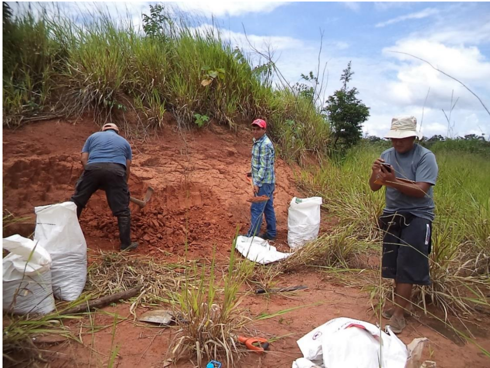
Figura 30:Extracción y almacenamiento en sacos de 50 kg Fuente: Propia.
