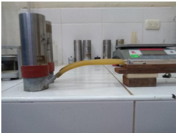
Figura 112: Soporte de madera que nivela el tubo de vidrio con el cuerpo de prueba. Fuente Propia
