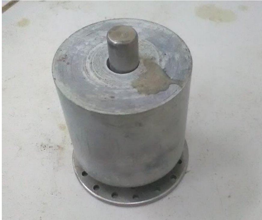
Figura 88: Sobrecarga para el ensayo de expansión con carga Fuente: Propia
