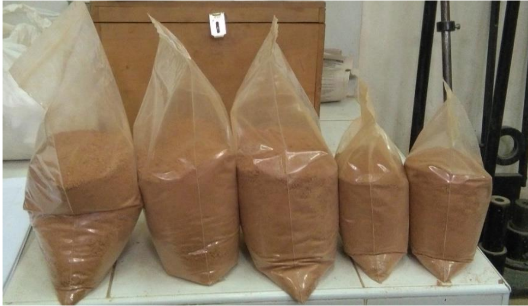
Figura 64: Porciones de 15 kg, guardadas en bolsas de polietileno. Fuente: Propia.
