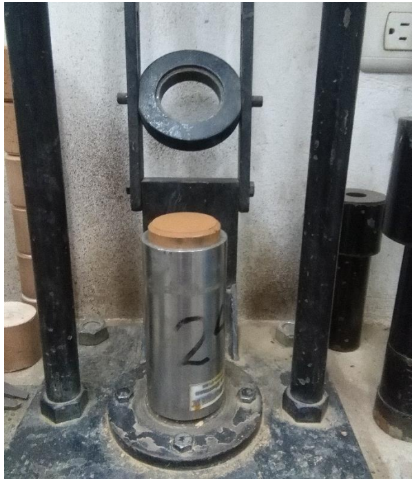
Figura 156: Se expulsa de tal modo de que sobresalga aproximadamente 1 cm. Fuente: Propia
