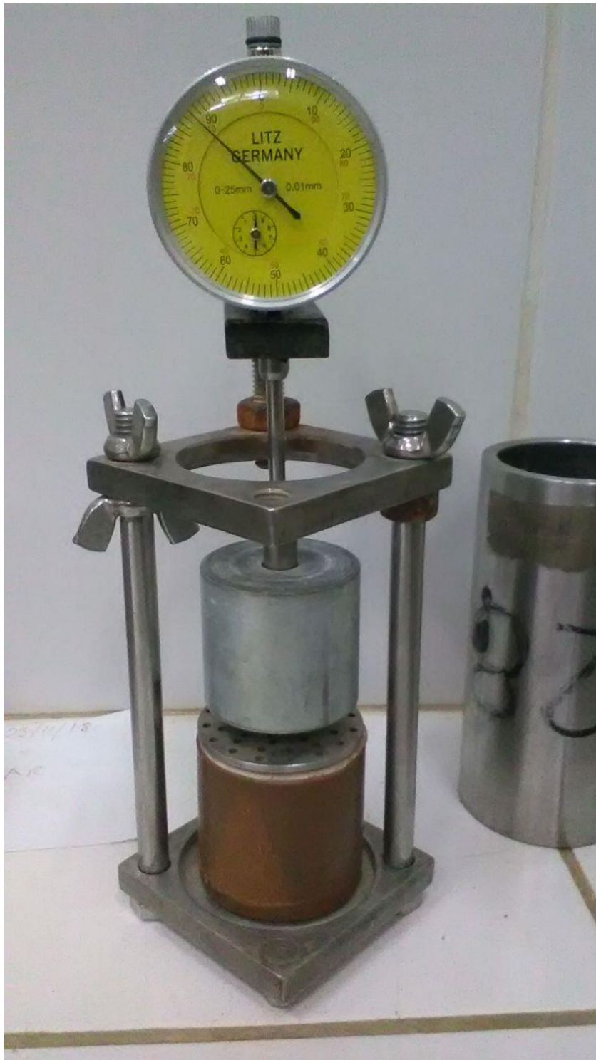
Figura 107: Contracción de la muestra tropezón con sobrecarga con una pesa de 420 g. Fuente: Propia.
