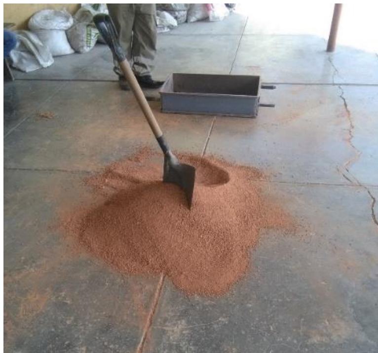
Figura 61: Muestra cuarteada y pasada por la malla número 10. Fuente: Propia.
