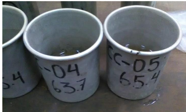
Figura 153: Recipiente que capta toda la muestra desprendida por inmersión llamado capsula. Fuente: Propia
