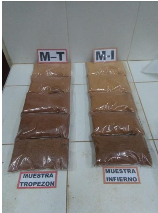
Figura 72: Muestras con diferentes cantidades de humedad de la muestra Tropezón y de Infierno, para su saturación se recomienda 12 horas con 500 g c/u. Fuente: Propia.
