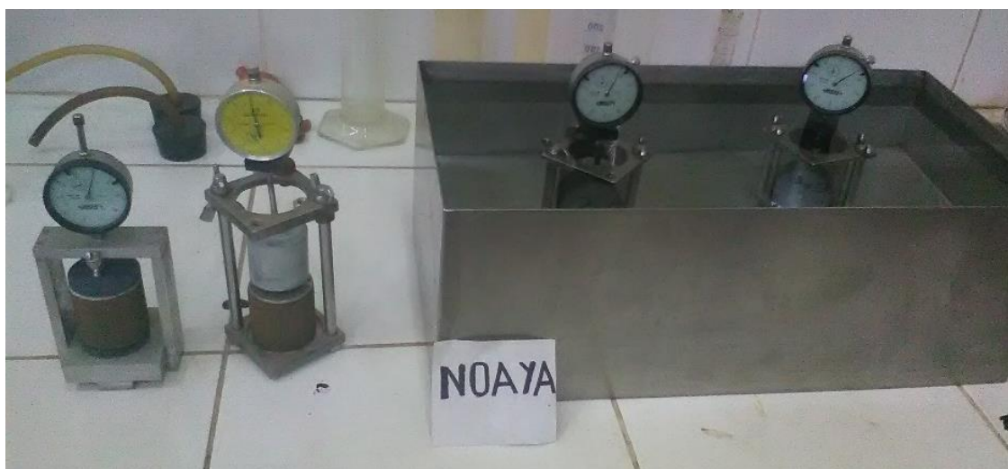
Figura 100: Empezando por la izquierda vemos cp con contracción sin carga seguida por contracción con carga y lo que está sumergido es expansión con carga y expansión si carga.
