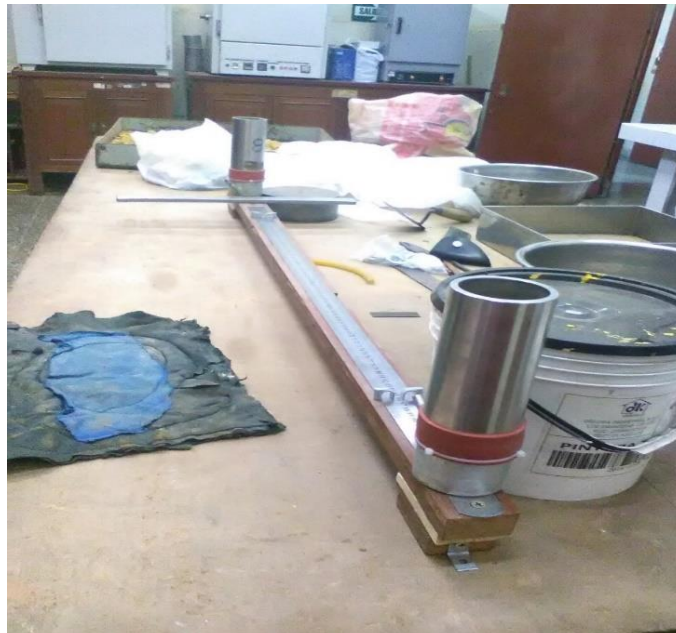
Figura 116: Pegado de las bases que son tacos de madera. Fuente: Propia.
