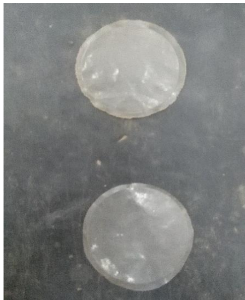
Figura 56:Discos de polietileno para uso en Mini Proctor y ensayos de mini MCV. Fuente: Propia.
