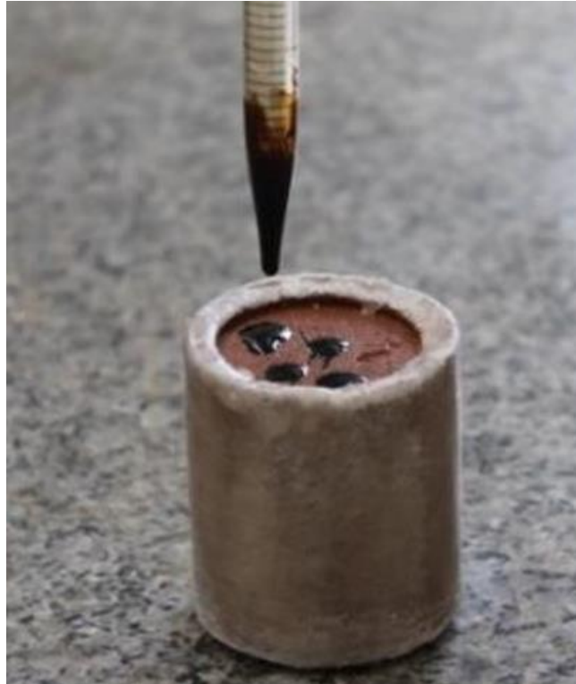
Figura 141:Reposo de los cp parafinados. Fuente: Ensayo de penetración de imprima dura DERP.
