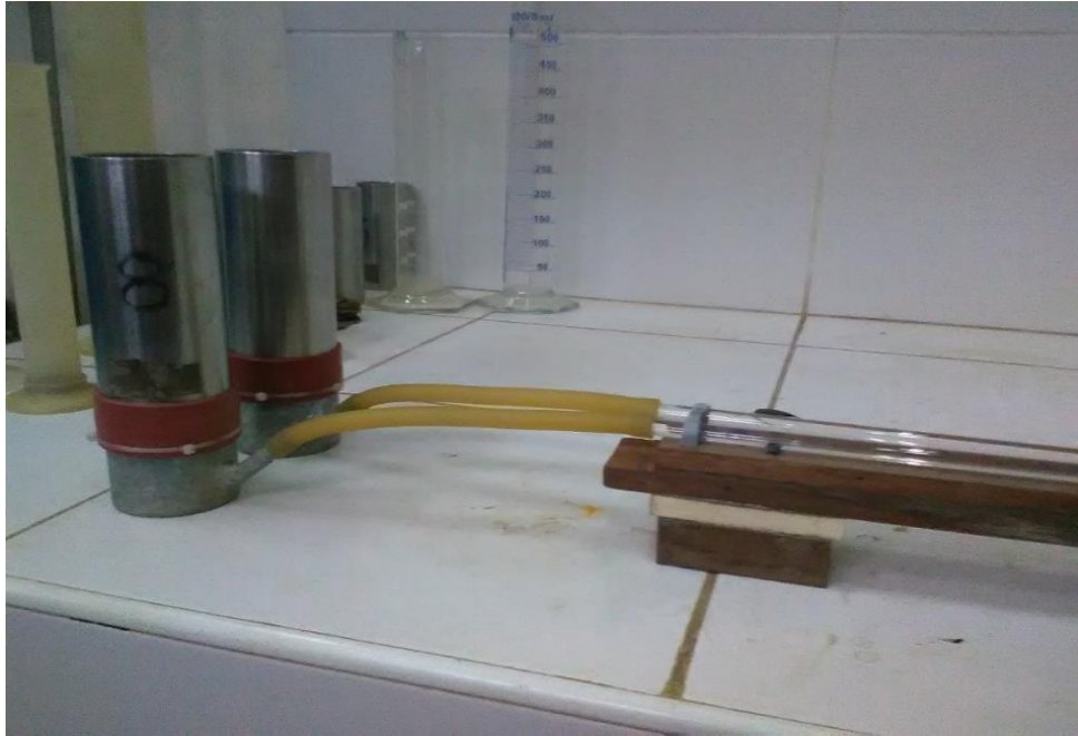
Figura 117: Colocación de los tubos de jebe Fuente: Propia.
