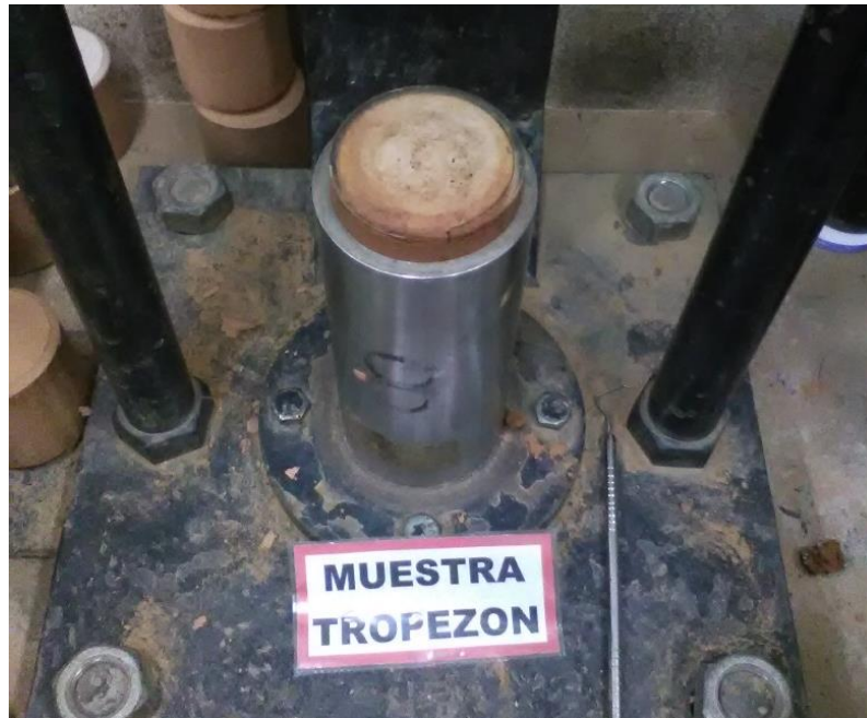
Figura 158:Expulsión de la muestra de la cantera Tropezón. Fuente: Propia
