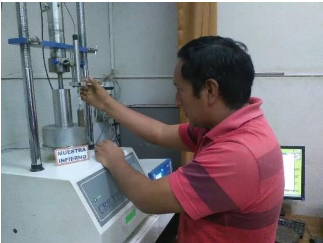
Figura 102:Instalación y habilitación para la penetración del Mini-CBR. Fuente: Propia.
