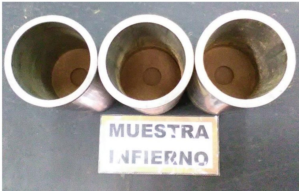
Figura 103: Cp cuerpos de prueba penetrados con el pistón de 16 mm. Fuente: Propia.
