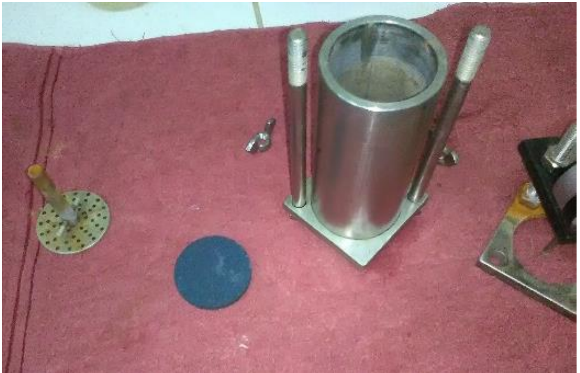
Figura 101:Desacople del montaje antes de la penetración. Fuente: Propia.
