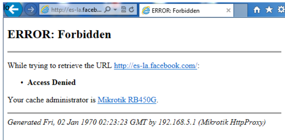
Figura 5.5 Bloqueo de Facebook con web proxy Fuente: Red de la MDCH Elaboración: Propia
