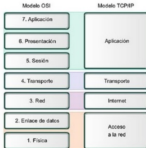
Figura 2.10 Comparación Modelo OSI / TCP/IP Fuente: http://espedatacomm.blogspot.pe/2011/09/modelo-osi-vs-tcpip_26.html
