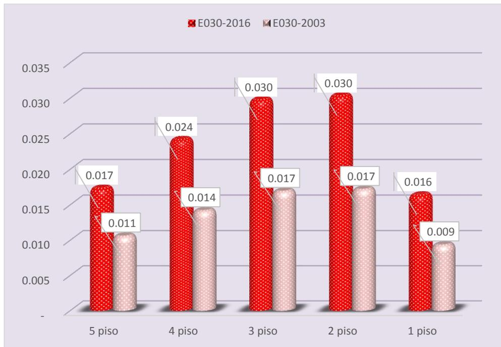
Figura 66. Diferencia de Derivas - dirección X (E030-2016 y E030-2003)
