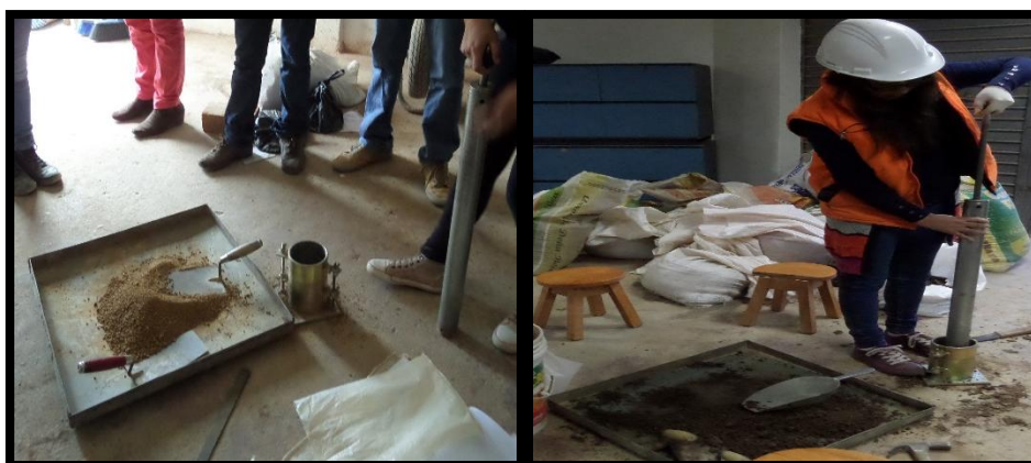
Figura 7: Instrumentos para el ensayo de proctor modificado.
