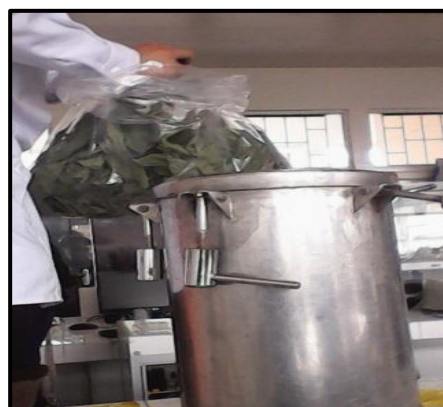
Introducción de 250 g de hojas secas y 4.0 L de agua en el equipo de destilación
