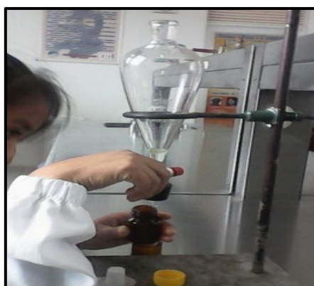
Separación de fase orgánica en pera de decantación para obtener 3.0 mL de aceite esencial
