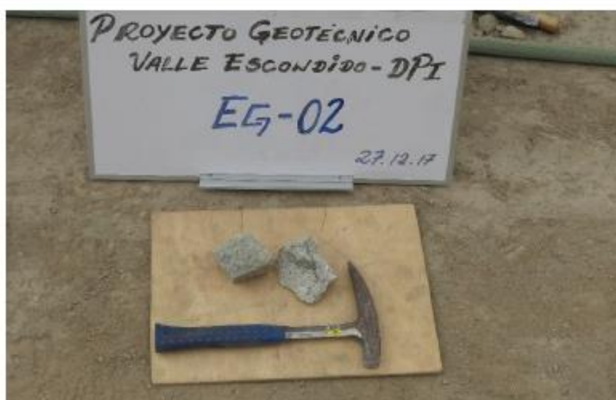
Fotografía N°9: Muestra de roca granodiorita, roca ígnea plutónica, textura, holocristalina, fanerítica de grano medio, leucocrática (color gris claro), compuesta por minerales de cuarzo y plagioclasas en mayor proporción, presencia en menor cantidad de minerales máficos u oscuros (biotitas y hornblendas).
