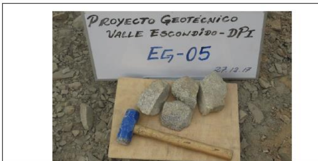
Fotografía N°12: Muestra de roca granodiorita, roca ígnea plutónica, textura, holocristalina, fanerítica de grano medio, leucocrática (color gris claro), compuesta por minerales de cuarzo y plagioclasas en mayor proporción, presencia en menor cantidad de minerales máficos u oscuros (biotitas y hornblendas).
