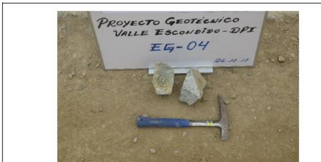
Fotografía N°11: Muestra de roca granodiorita, roca ígnea plutónica, textura, holocristalina, fanerítica de grano medio, leucocrática (color gris claro), compuesta por minerales de cuarzo y plagioclasas en mayor proporción, presencia en menor cantidad de minerales máficos u oscuros (biotitas y hornblendas).
