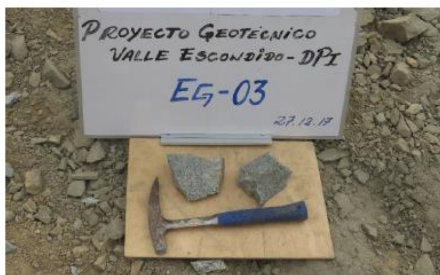
Fotografía N°10: Muestra de roca granodiorita, roca ígnea plutónica, textura, holocristalina, fanerítica de grano medio, leucocrática (color gris claro), compuesta por minerales de cuarzo y plagioclasas en mayor proporción, presencia en menor cantidad de minerales máficos u oscuros (biotitas y hornblendas).
