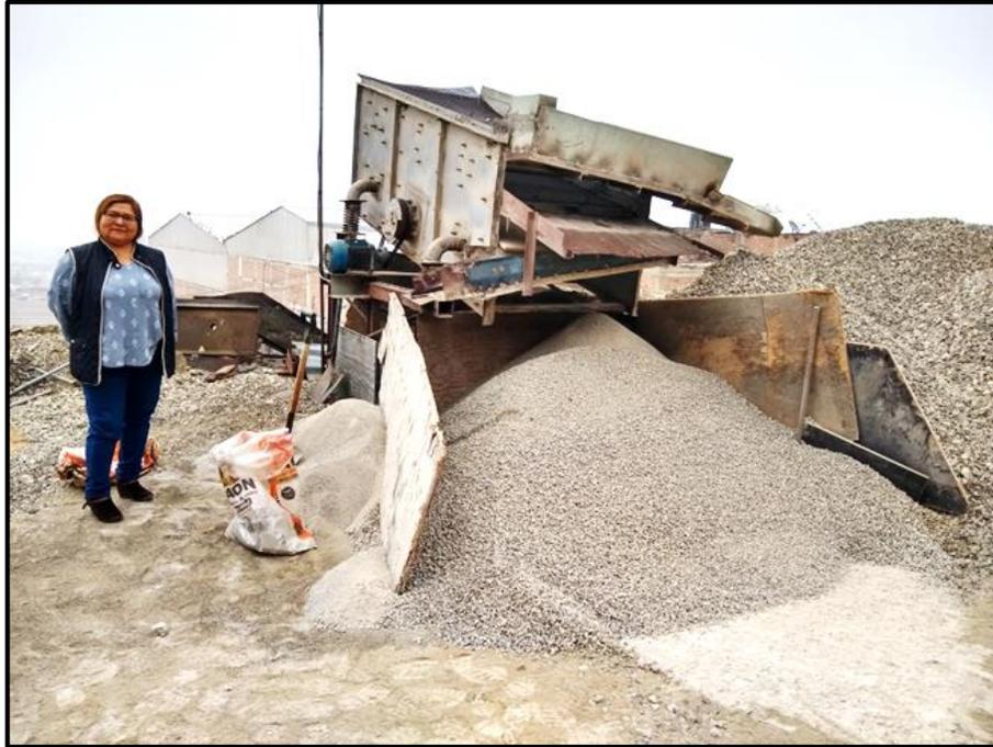
Figura 7: Máquina tamizadora del concreto triturado
