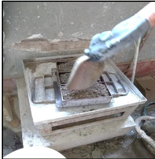
Figura 23: Colocación de la mezcla en el molde de Adoquín
