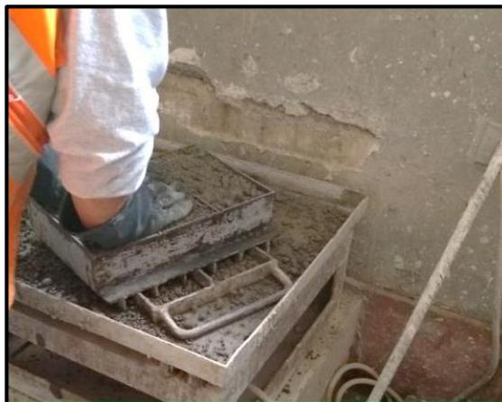
Figura 24 Compactación y vibrado de la mezcla
