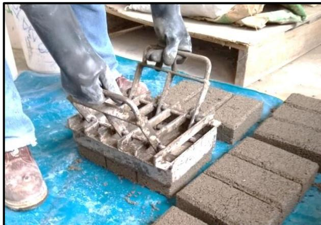
Figura 26: Desmolde de los adoquines
