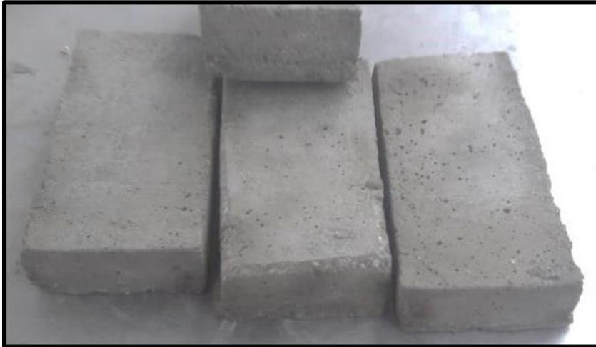
Figura 29: Adoquines fabricados con residuos de concreto sin aditivo
