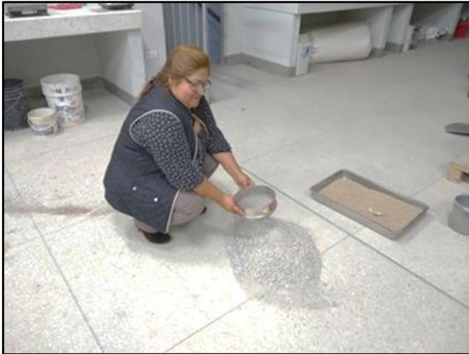
Figura 12: tamizado del agregado reciclado
