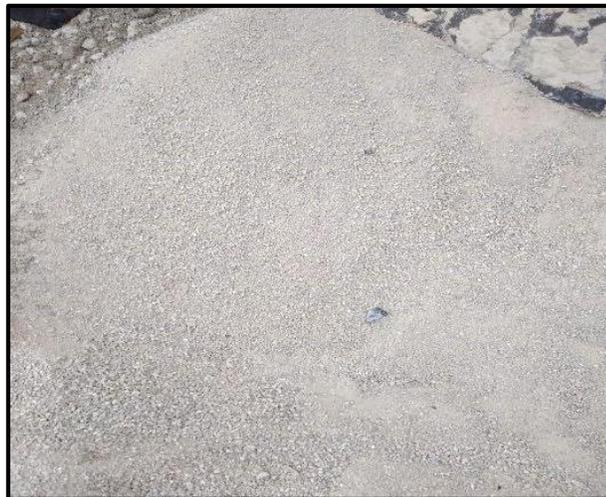
Figura 8: Agregado reciclado
