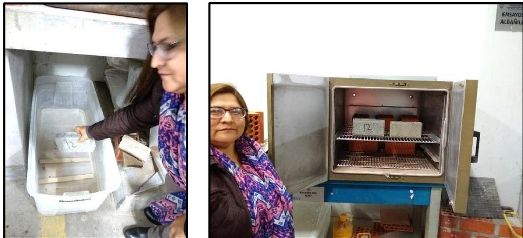
Figura 32: Adoquín sumergido en agua por 24 horas y en el horno
