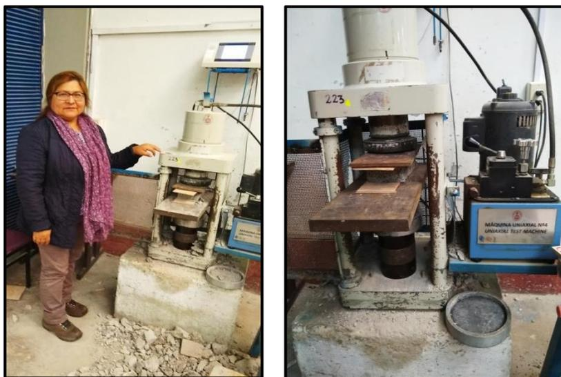
Figura 31: Ensayo de Resistencia a la compresión axial del adoquín
