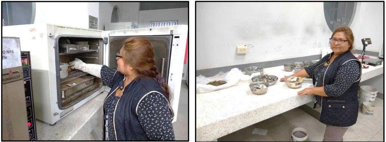
Figura 14: Poniendo la muestra en el horno y determinar el peso específico
