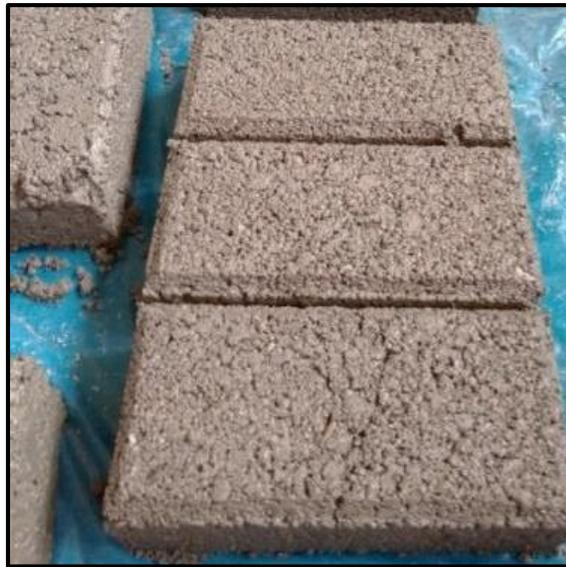
Figura 28: Adoquines fabricados con residuos de concreto y aditivo
