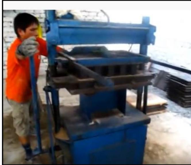
Figura 25: Maquina adoquinera marca Proyecol, con motor de 3HP
