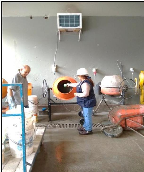
Figura 18: Agregando aditivo a la mezcla
