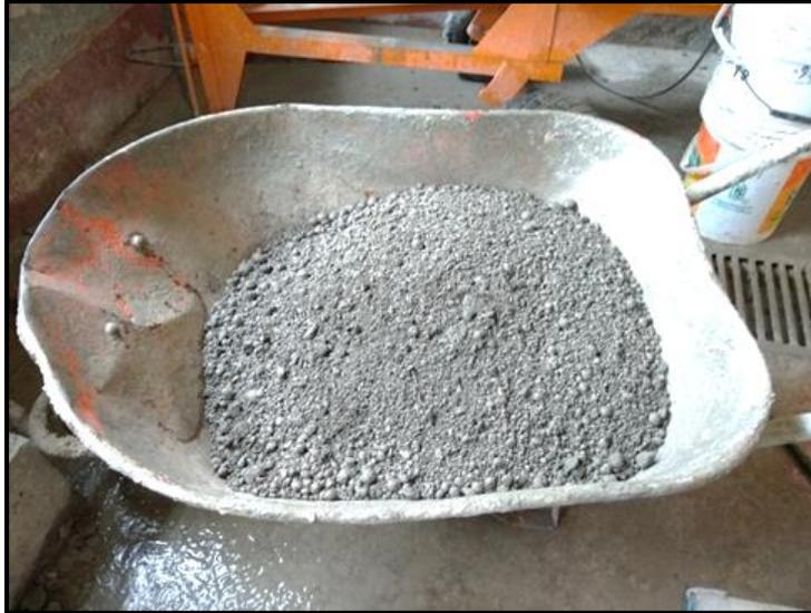
Figura 19: Mezcla con incorporación de aditivo súper plastificante
