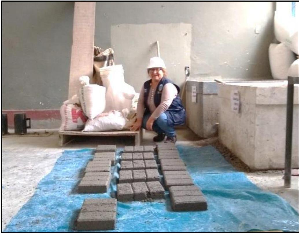
Figura 27: Fraguado de los adoquines
