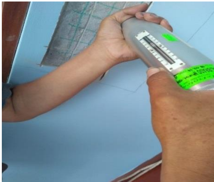
Fotografía 10. Cuadrícula para los rebotes por cada ensayo
