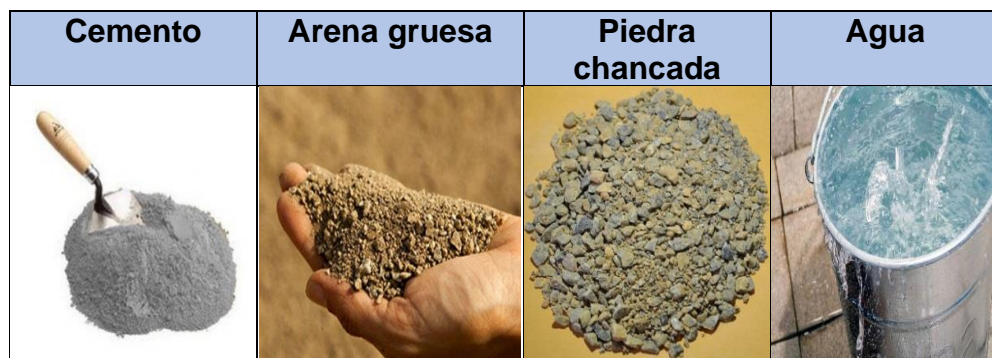
Figura 26. Materiales para el concreto.
