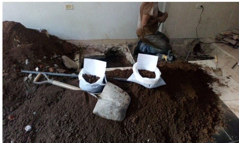
Fotografía 20. Seleccionando la muestra inalterada
