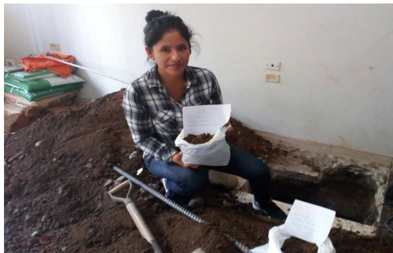
Fotografía 20. Seleccionando la muestra inalterada
