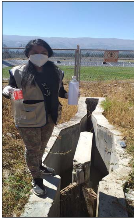
Figura 05: Primera toma de muestra en el Desarenador.
