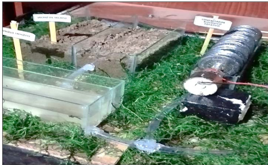
FOTO 10: Planta de tratamiento de aguas residuales con Contactador Biológico.
