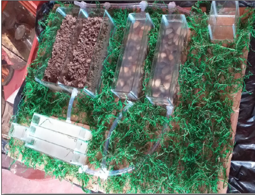
FOTO 07: Elaboración de maqueta de la Planta de tratamiento de aguas residuales con Filtro Biológico.
