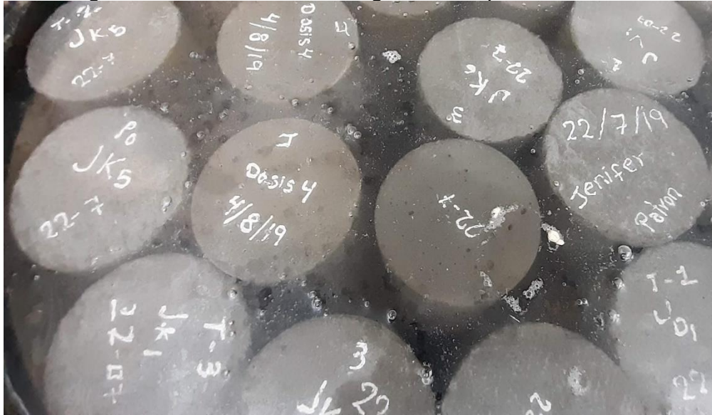
Figura N° 46: Probetas sumergidas en el pozo de curado.
