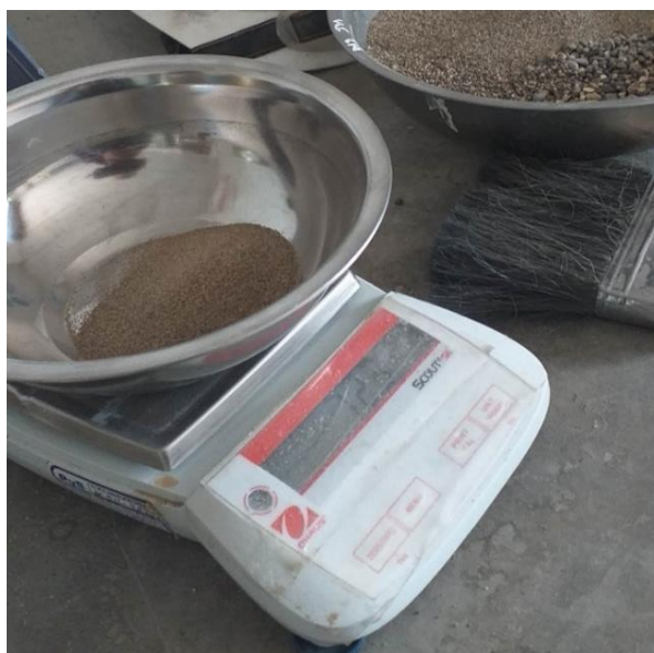
Figura N° 22: Pesaje del material (agregado fino) retenido en uno de los tamices.
