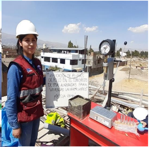
Collage de fotos N° 05: Ensayo del tiempo de fragua mediante el empleo del penetrómetro.
