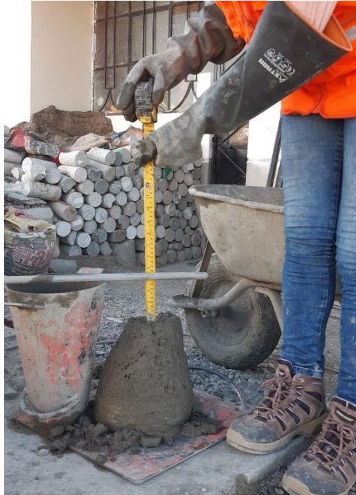
Figura N° 30: Medida del asentamiento de la mezcla.
