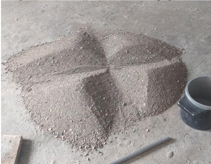
Figura N° 18: Cuarteo de la muestra del agregado fino.
