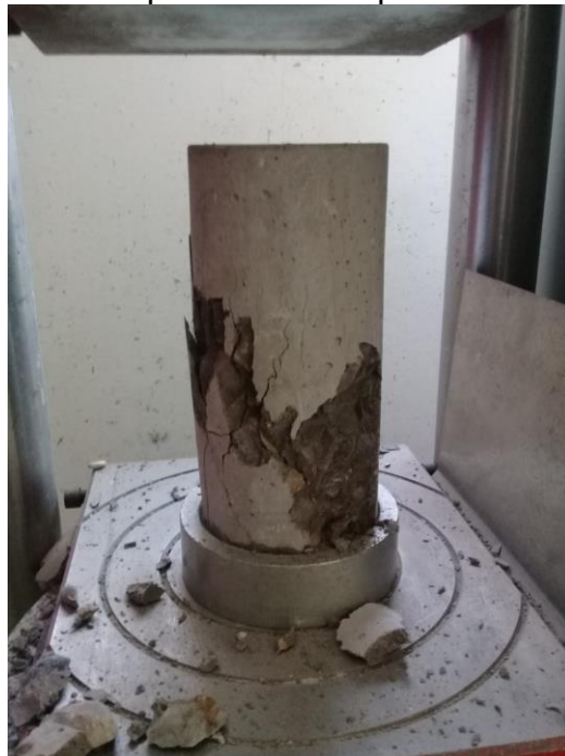
Figura N° 48: Rotura de probetas en la prensa de compresión axial.
