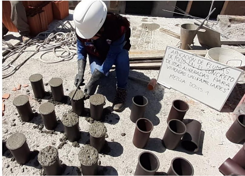
Figura N° 40: Enrasado de las probetas de concreto.
