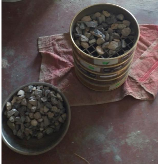
Figura N° 21: Tamizado del agregado grueso.
