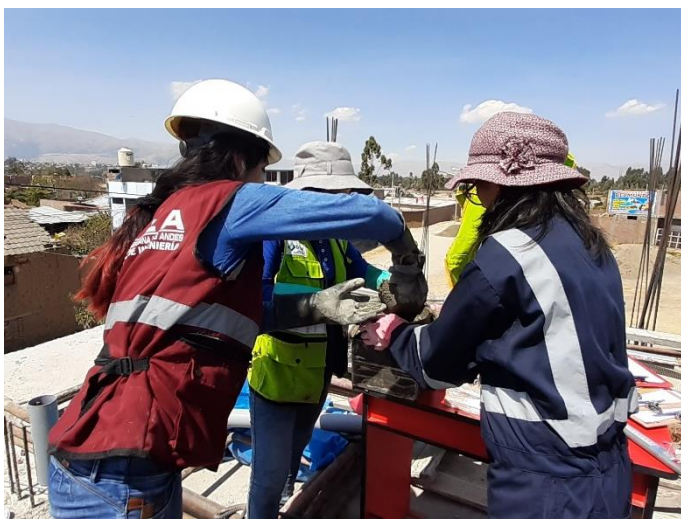
Collage de fotos N° 05: Ensayo del tiempo de fragua mediante el empleo del penetrómetro.
