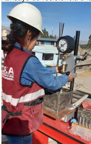
Figura N° 38: Ensayo de resistencia a la penetración.
