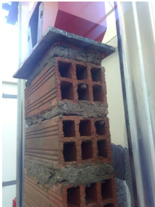
Fotografía 5. Ensayo de compresión axial en pila de ladrillo pandereta con junta de mortero tradicional (cemento, agregado y agua).
