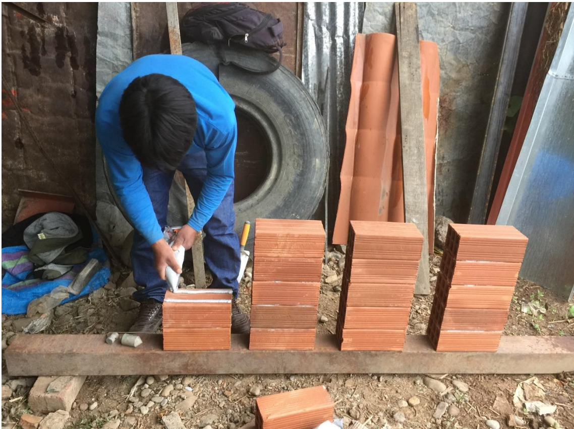
Fotografía 7. Elaboración de pilas de ladrillo pandereta con junta de masa polimérica.
