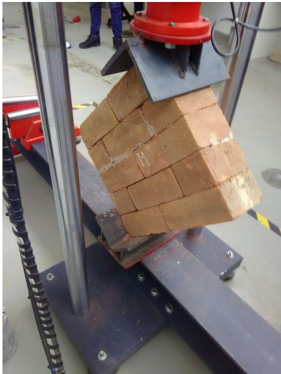
Fotografía 11. Ensayo de compresión diagonal en murete de ladrillo artesanal con junta de masa polimérica.
