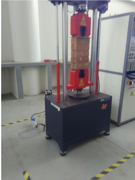
Fotografía 10. Ensayo de compresión axial en pila de ladrillo artesanal con junta de masa polimérica.
