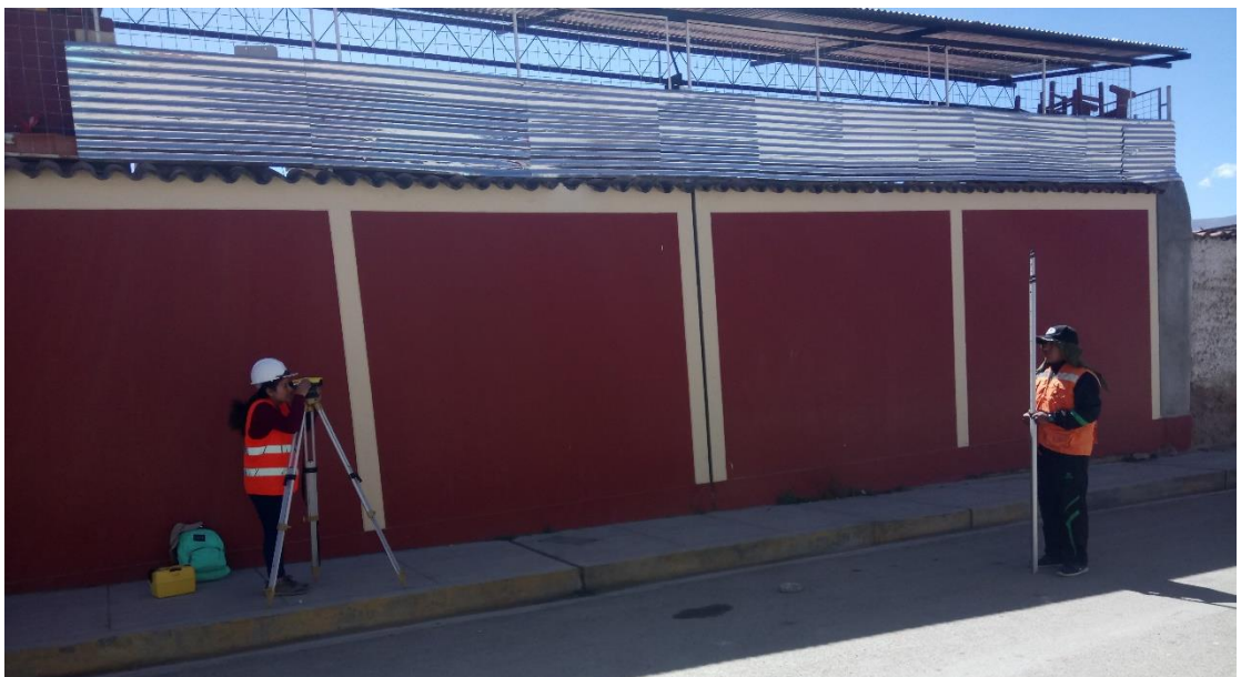
IMAGEN 5: LA IMAGEN MUESTRA LA LECTURA DE LOS PUNTOS MARCADOS, PARA OBTENER EL PERFIL LONGITUDINAL EN EL JR. SANTO DOMINGO.
