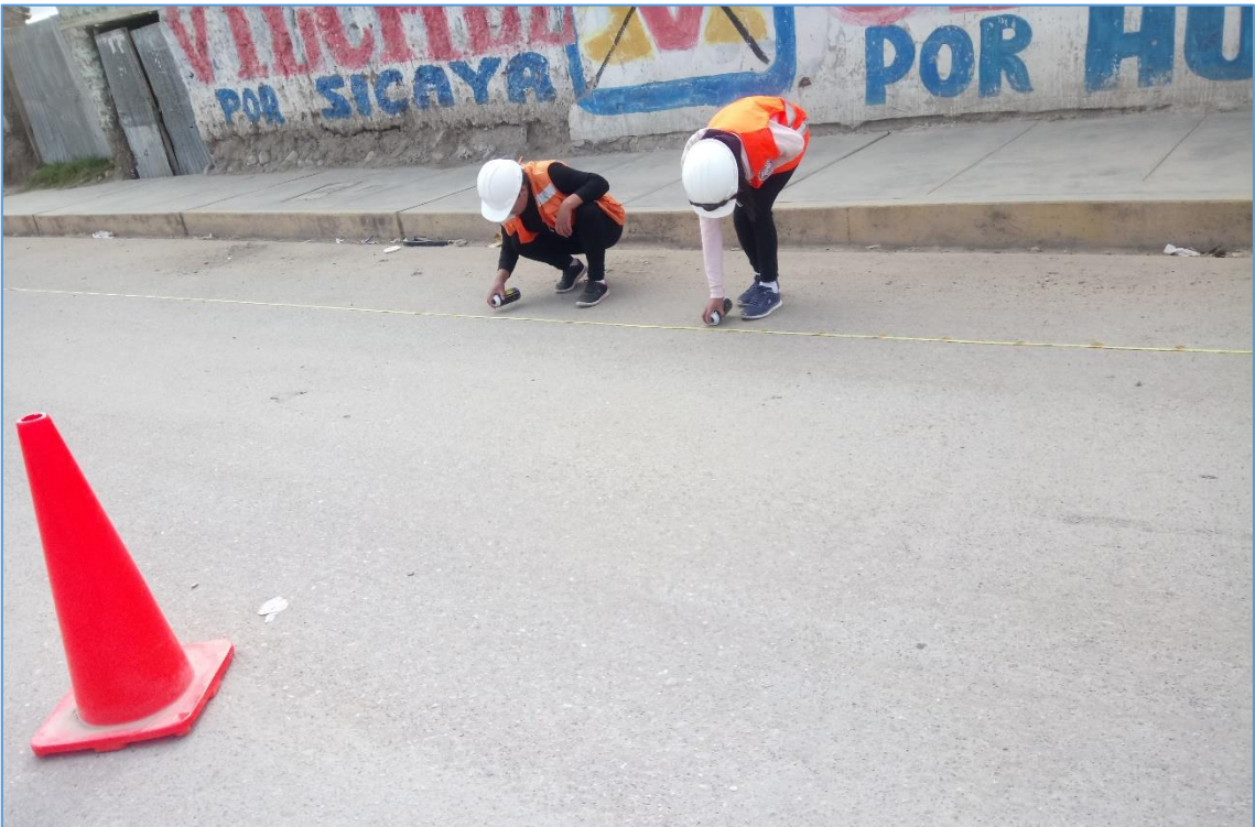
IMAGEN 4: LA IMAGEN MUESTRA EL MARCADO A CADA 25cm, EN LA HUELLA DEL CARRO DEL JR. BALCONCILLO.
