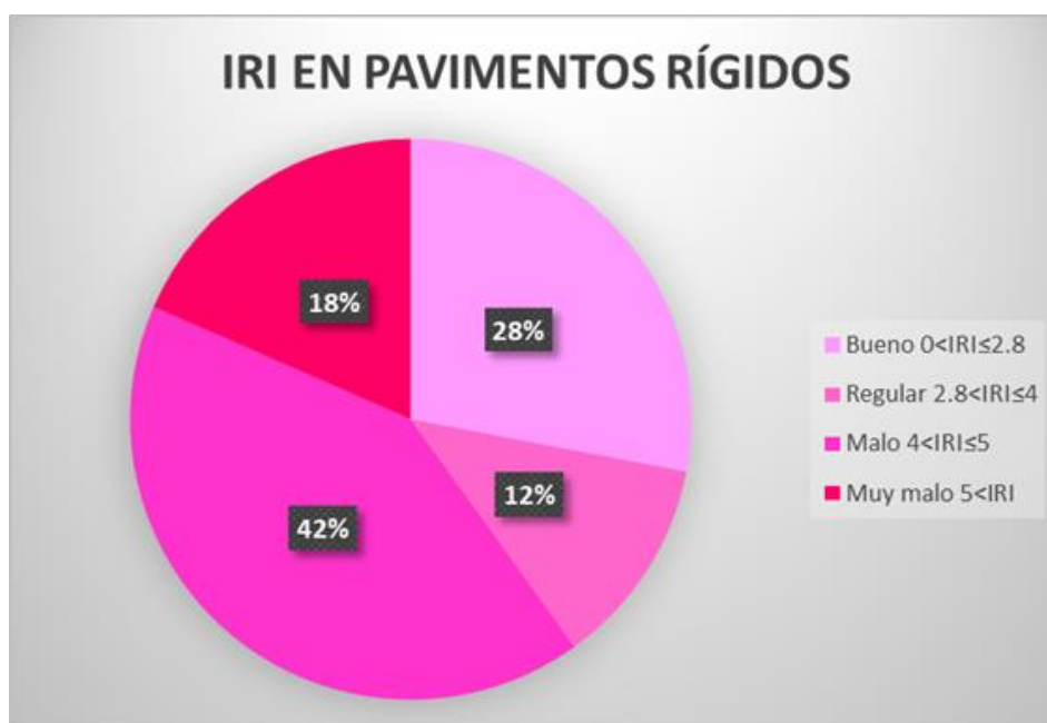
Figura 21: Estado de rugosidad de las vías de pavimento rígido, expresada en porcentaje.
