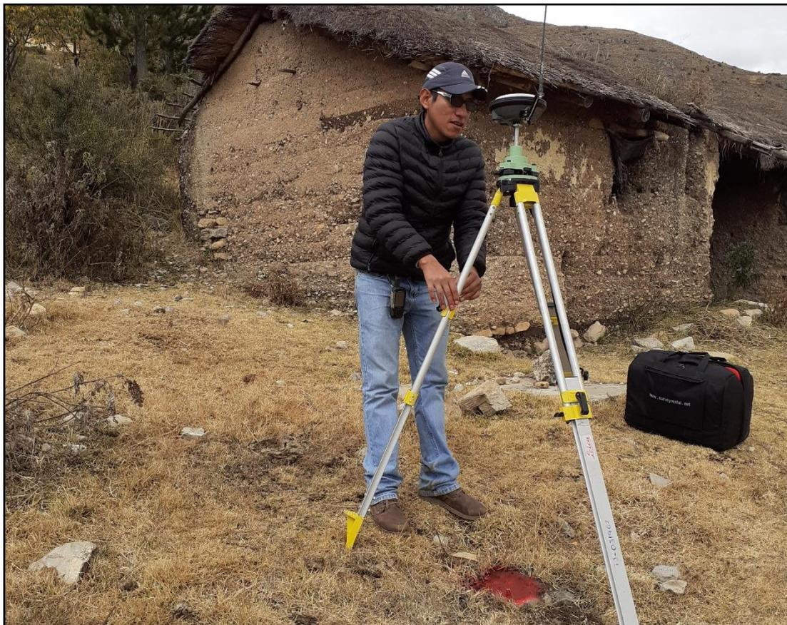
Fotografía N° 12: Colecta de datos con receptor satelital geodésico en el PA-03.
