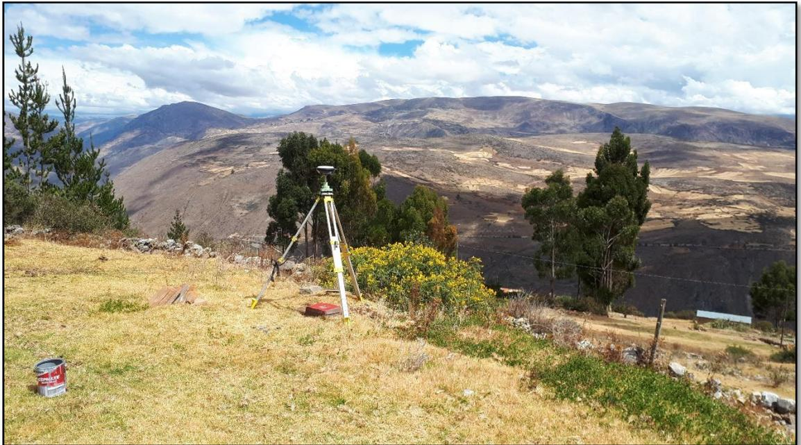
Fotografía N° 10: Colecta de datos con receptor satelital geodésico en el ATA01002.
