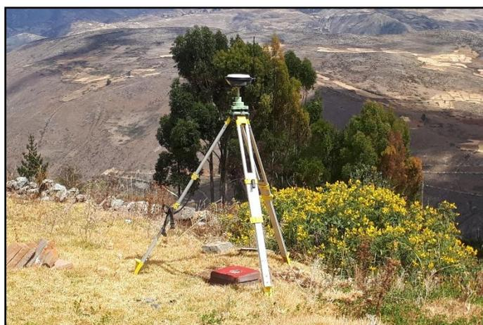
Figura 46, Receptor satelital geodésico de doble frecuencia.
