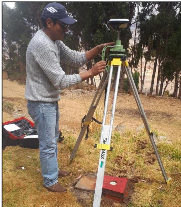
Figura 47, Receptor satelital geodésico mono frecuencia
