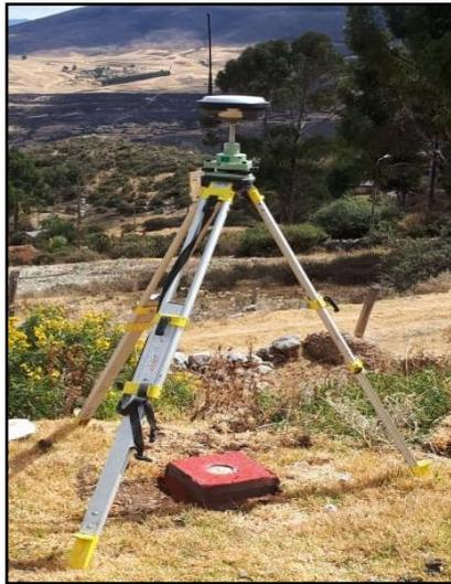
Figura 6, Receptor satelital geodésico doble frecuencia.
