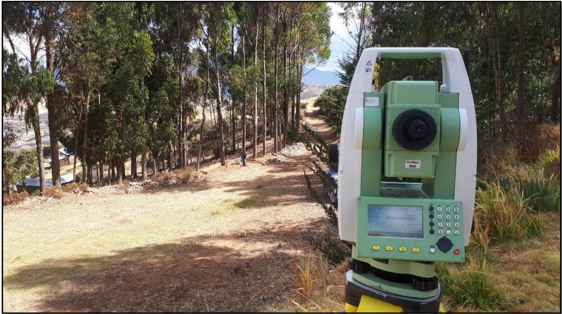
Fotografía N° 14: Levantamiento topográfico de límites de propiedad.
