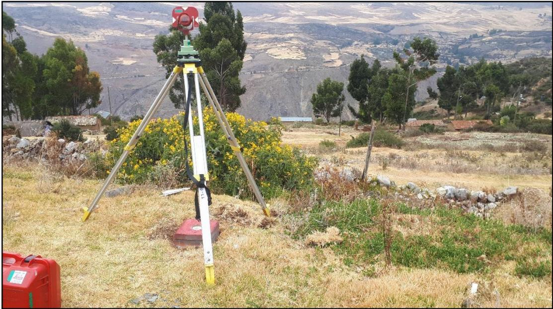
Fotografía N° 13: Poligonal cerrada del Atahualpa con tribash.
