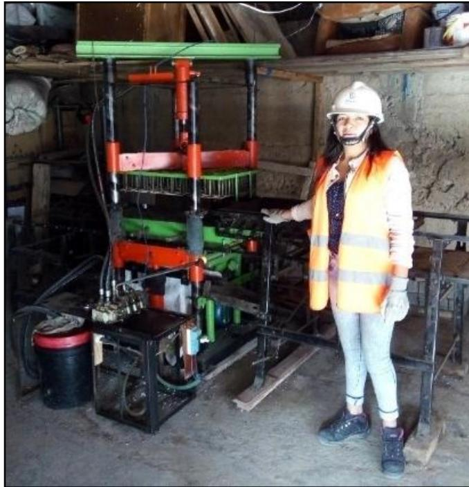
**Figura 20:** Maquina para la elaboración de las unidades de albañilería Fuente: elaboración propia.
