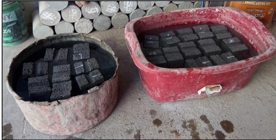
**Figura 36:** Ladrillo sumergido por 24 horas Fuente: elaboración propia.
