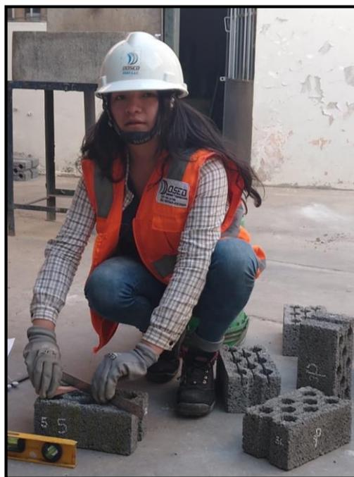
**Fotografía N° 26:** Medición de convexidad de las 4 muestras (patrón, 3%, 5%, 10% PET) de las unidades Fuente: elaboración propia.
