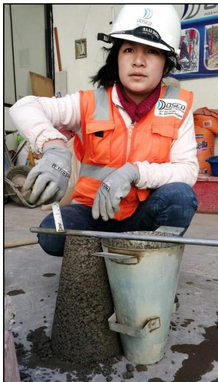
**Figura 24:** Verificación del asentamiento (consistencia seca de la mezcla), poco trabajable Fuente: elaboración propia.
