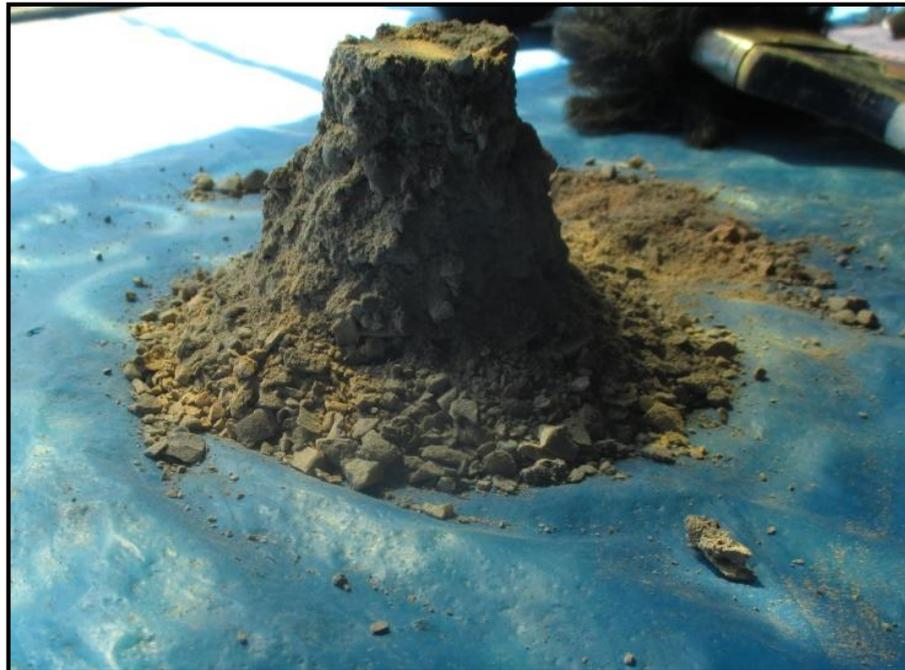
**Fotografía N° 10:** Humedad libre del agregado fino Fuente: elaboración propia.
