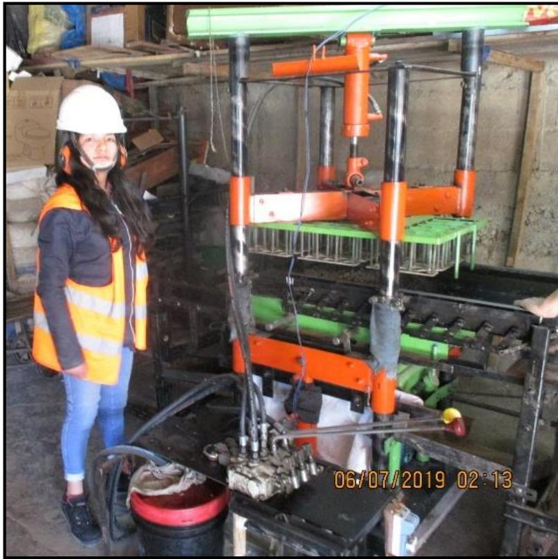
**Fotografía N° 13:** Máquina para la elaboración de las unidades de albañilería
