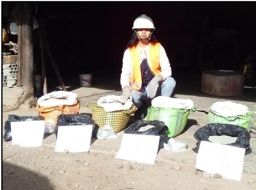
**Fotografía N° 12:** Cantidades de cemento, agregados, PET, para la fabricación
