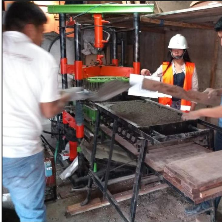
**Figura 25:** Colocación de la mezcla de concreto en la máquina para el moldeo de la unidad de albañilería Fuente: elaboración propia.
