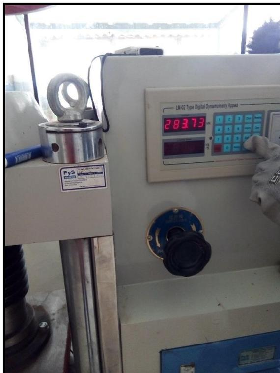
**Fotografía N° 36:** Resultado de la unidad de albañilería con incorporación de 5 % PET Fuente: elaboración propia.
