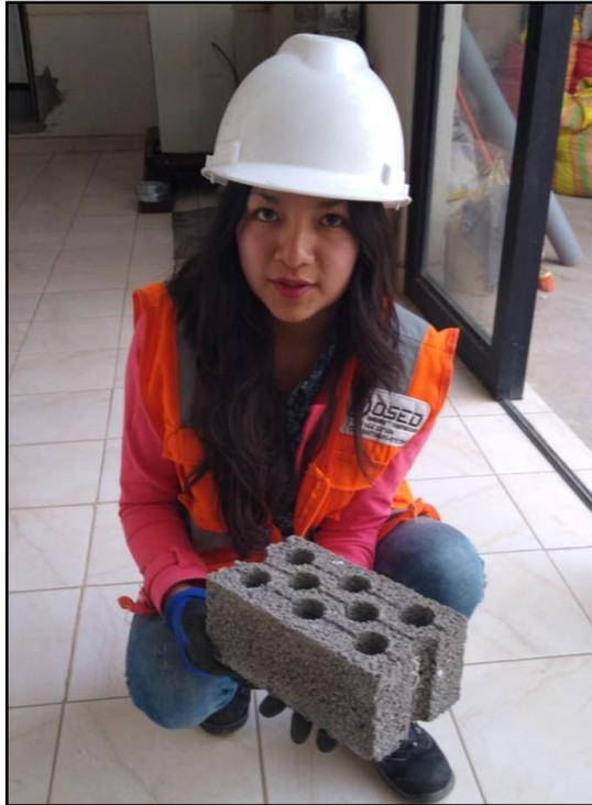
**Figura 27:** Ladrillo de concreto con incorporación de polietileno tereftalato
