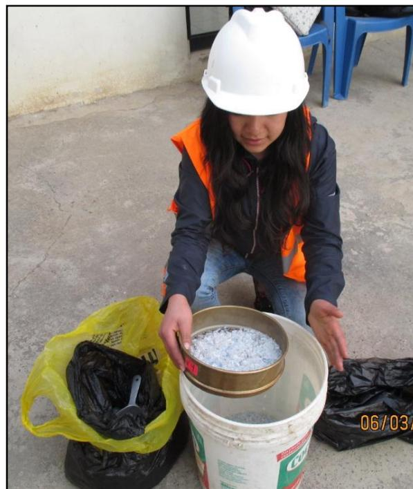
**Figura 17:** Tamizado del polietileno tereftalato,
