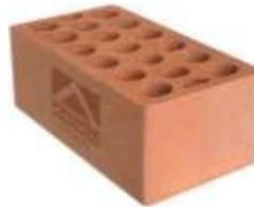
**Figura 3.** Unidad de albañilería hueca Fuente: (Elaboración propia)
