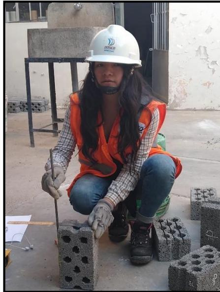
**Fotografía N° 23:** Medición de dimensiones de las 4 muestras (patrón, 3%, 5%, 10% PET) de las unidades Fuente: elaboración propia.
