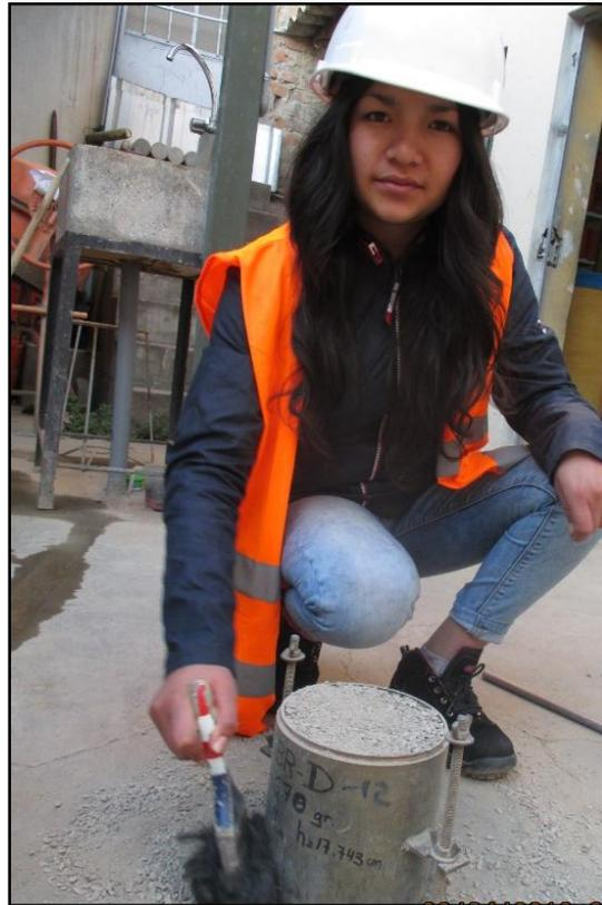
**Figura 12:** Ensayo de peso unitario del agregado Fuente: elaboración propia.
