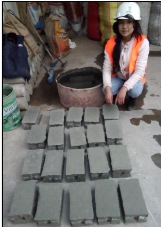
**Fotografía N° 34:** Secado de las unidades refrendadas con yeso-cemento Fuente: elaboración propia.
