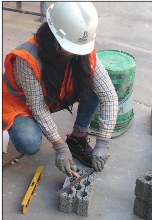
**Figura 31:** Medición de concavidad Fuente: elaboración propia.
