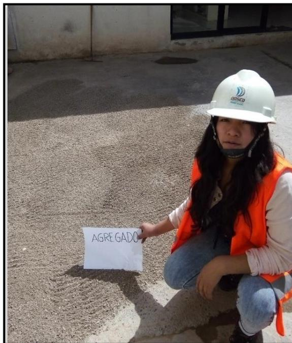
**Fotografía N° 02:** Secado del agregado fino para realizar los ensayos Fuente: elaboración propia.
