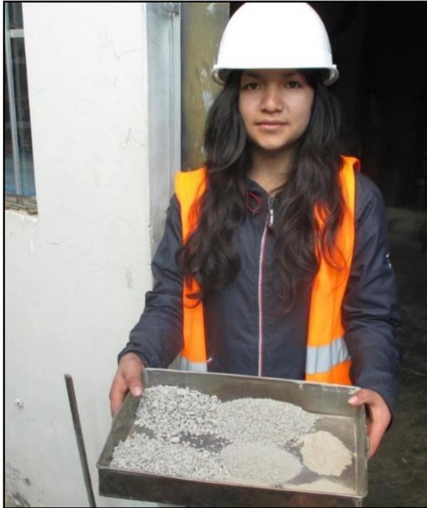
**Figura 8:** Imagen de pesos retenidos en los tamices en el ensayo granulométrico Fuente: elaboración propia.
