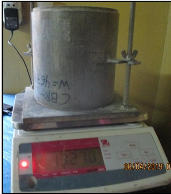
**Fotografía N° 07:** Ensayo de peso unitario seco compactado del agregado fino (peso del recipiente que contiene el agregado) Fuente: elaboración propia.
