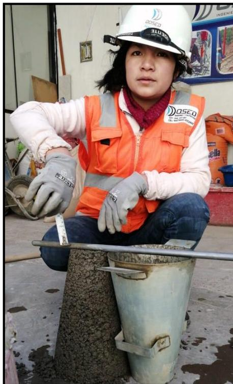
**Fotografía N° 18:** Verificación del asentamiento (consistencia seca de la mezcla) Fuente: elaboración propia.
