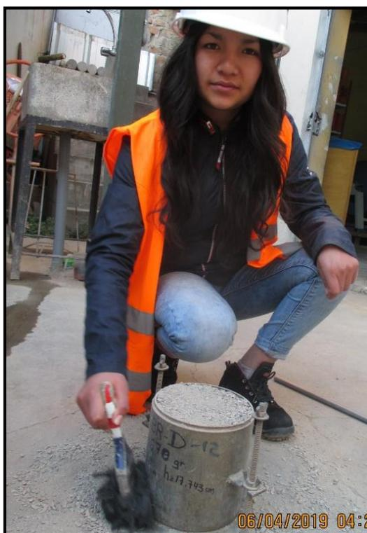
**Fotografía N° 06:** Ensayo de peso unitario seco compactado del agregado fino (nivelación de la superficie del material) Fuente: elaboración propia.
