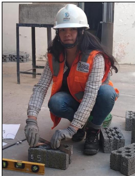
**Figura 33:** Medición de convexidad Fuente: elaboración propia:
