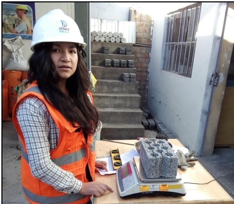
**Fotografía N° 28:** obtención del peso seco de las 4 muestras (patrón, 3%, 5%, 10% PET) de las unidades Fuente: elaboración propia.
