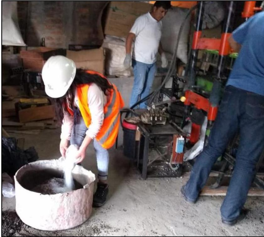
**Figura 23:** Incorporación de polietileno tereftalato y otros materiales en la mezcla Fuente: elaboración propia.
