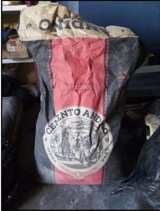
**Fotografía N° 03:** Cemento andino tipo I para la elaboración de las unidades de albañilería Fuente: elaboración propia.
