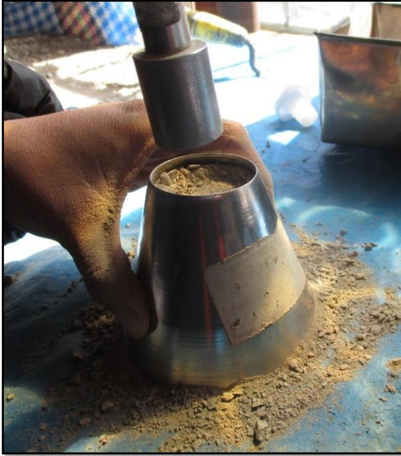
**Fotografía N° 09:** Compactación del material en el molde cónico Fuente: elaboración propia.
