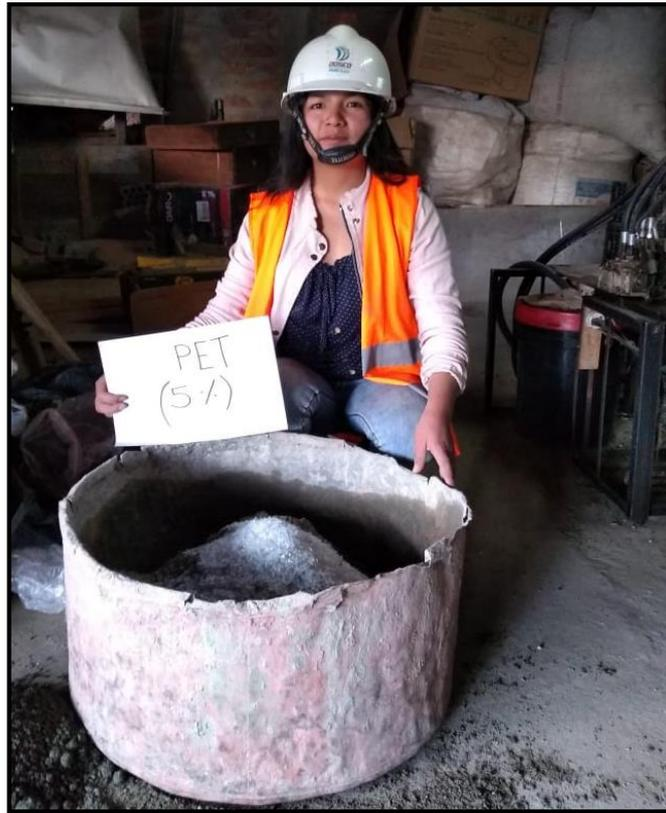
**Fotografía N° 15:** Incorporación de PET en la mezcla Fuente: elaboración propia.
