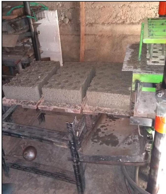
**Figura 26:** Unidades de albañilería elaboradas Fuente: elaboración propia.
