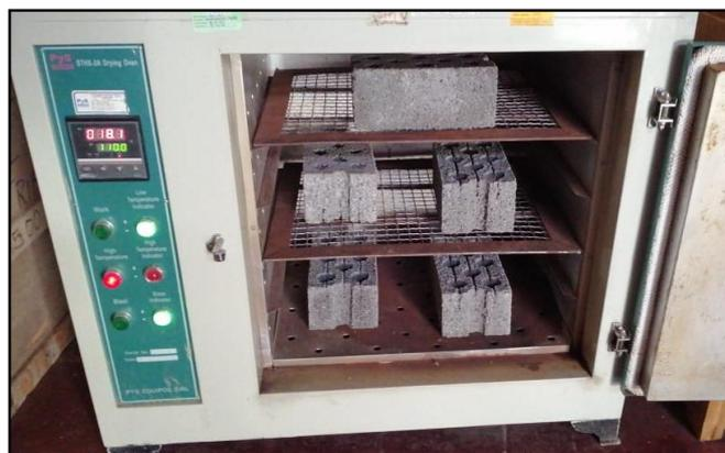
**Figura 35:** Secado del ladrillo en el horno por 24 horas Fuente: elaboración propia.
