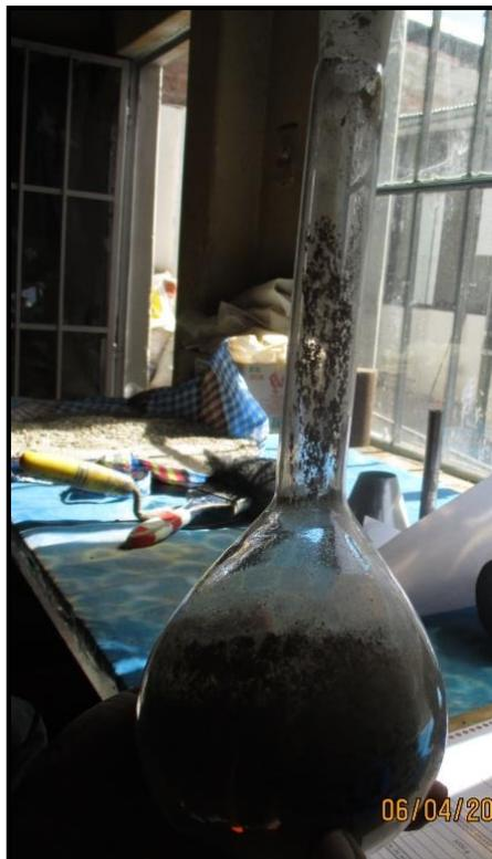
**Fotografía N° 08:** Colocación de la muestra en el picnómetro Fuente: elaboración propia
