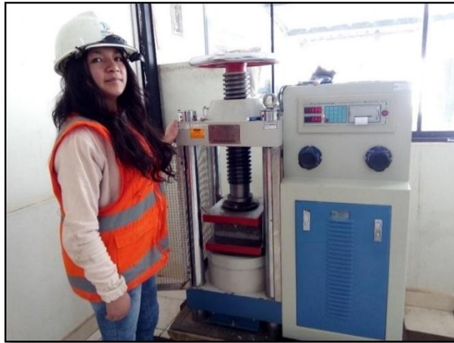
**Figura 41:** Ensayo de resistencia a la compresión
