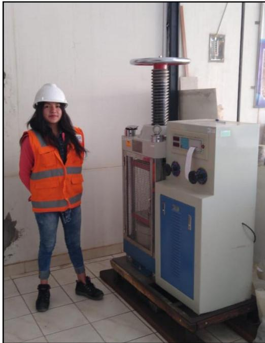
**Figura 38:** Equipo para el ensayo de resistencia a la compresión Fuente: elaboración propia.
