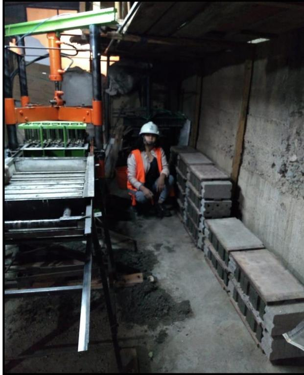
**Fotografía N° 21:** Acomodo de las unidades para su secado, diferenciando el patrón con las que contienen incorporación de PET Fuente: elaboración propia.
