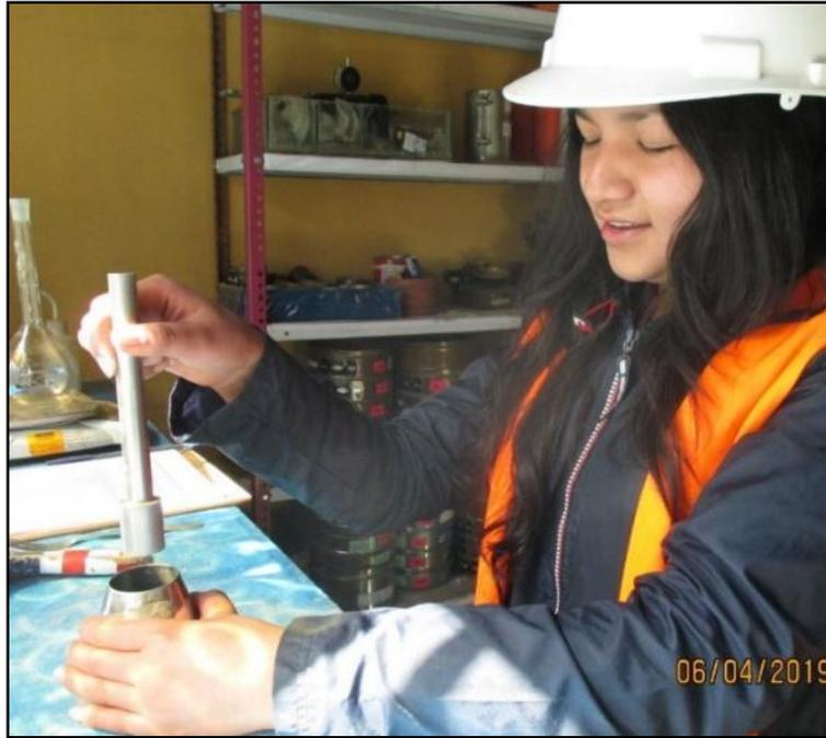
**Figura 14:** Compactación con 25 golpes el agregado en el molde cónico Fuente: elaboración propia.
