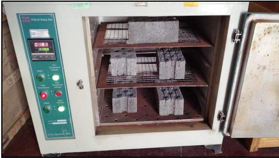
**Fotografía N° 27:** Secado al horno por 24 horas de las 4 muestras (patrón, 3%, 5%, 10% PET) de las unidades Fuente: elaboración propia.
