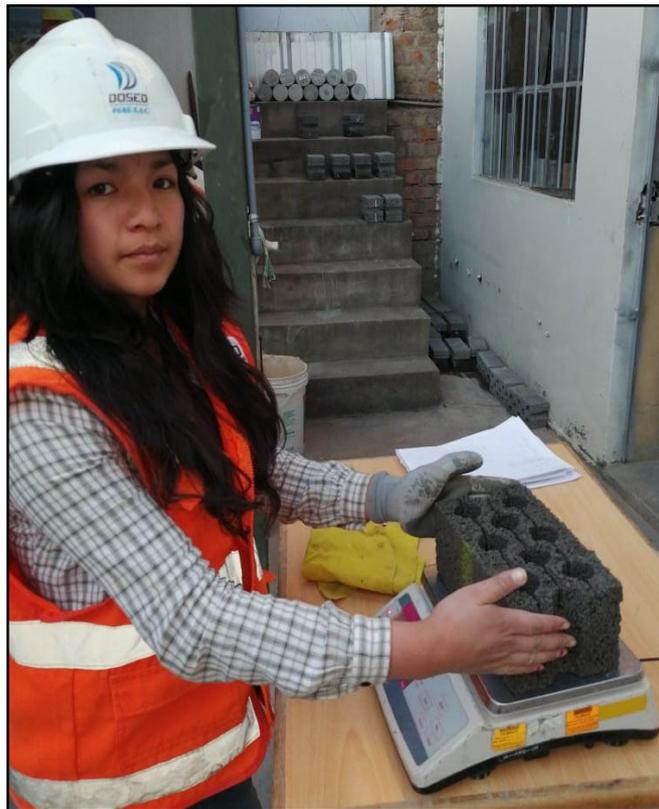
**Figura 37:** Peso del ladrillo sumergido 24 horas Fuente: elaboración propia.
