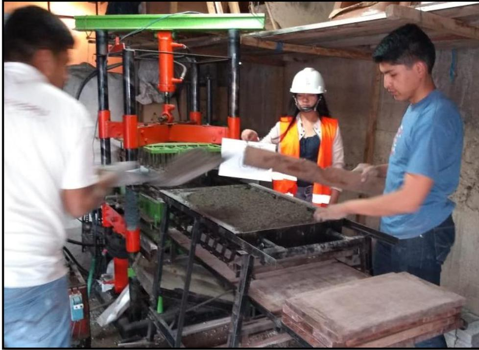
**Fotografía N° 19:** Colocación de la mezcla en la máquina para el vibrado y fabricación de las unidades Fuente: elaboración propia
