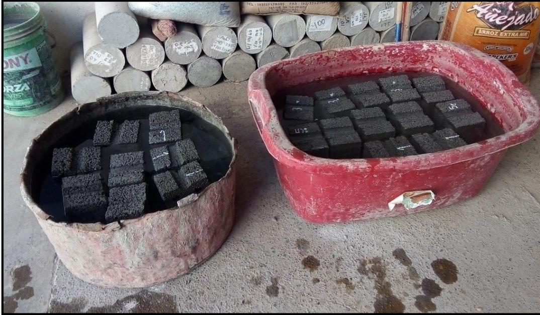
**Fotografía N° 29:** Unidades sumergidas por 24 horas, 4 muestras (patrón, 3%, 5%, 10% PET) Fuente: elaboración propia.
