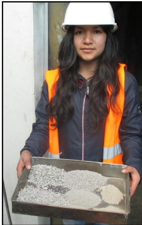
**Fotografía N° 04:** Material retenido en los tamices (ensayo granulométrico del agregado fino) Fuente: elaboración propia.
