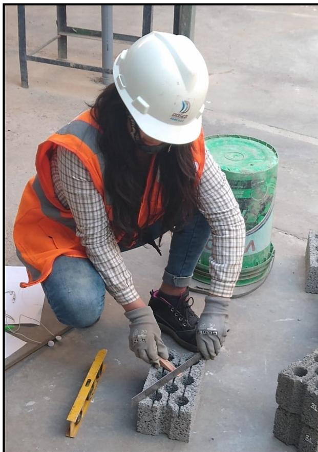
**Fotografía N° 25:** Medición de concavidad (cara superior) de las 4 muestras (patrón, 3%, 5%, 10% PET) de las unidades Fuente: elaboración propia.
