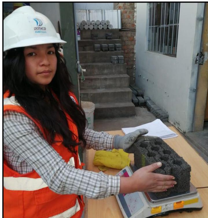
**Fotografía N° 32:** obtención del peso húmedo de las 4 muestras (patrón, 3%, 5%, 10% PET) de las unidades Fuente: elaboración propia.
