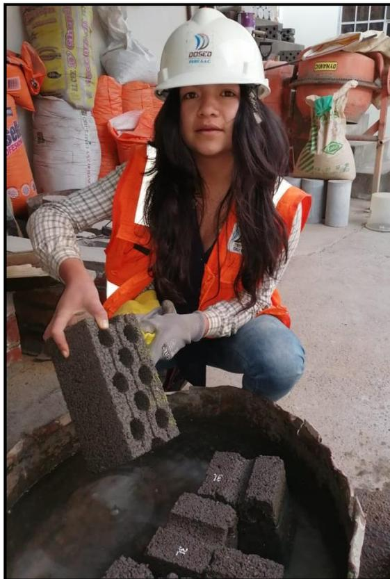
**Fotografía N° 30:** Retiro de las unidades sumergidas por 24 horas, 4 muestras (patrón, 3%, 5%, 10% PET) Fuente: elaboración propia.
