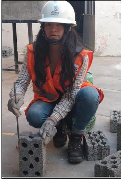
**Figura 29:** Medición de longitud, alto, ancho de la unidad de albañilería
