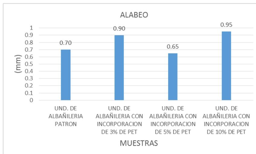
**Figura 42:** Resultado del ensayo de alabeo de las muestras de las unidades de albañilería
