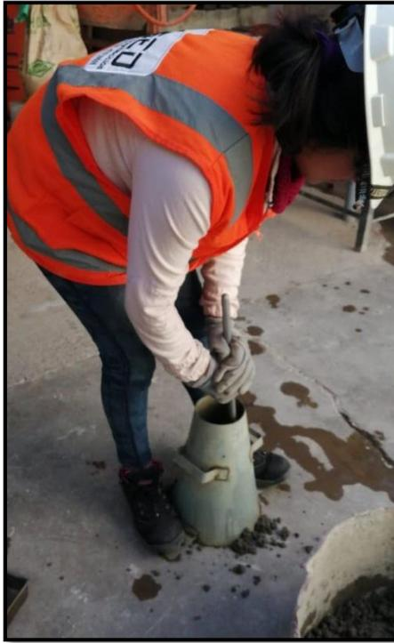
**Fotografía N° 17:** Prueba de control de consistencia de la mezcla Fuente: elaboración propia.
