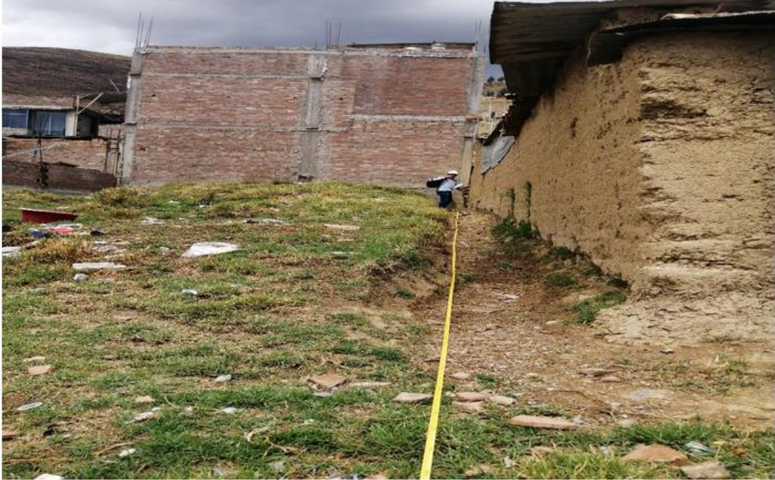
Fotografía 09: Medición del área de las viviendas para el estudio de vulnerabilidad sísmica – Asociación los Libertadores – Huancayo Fuente: Propia.
