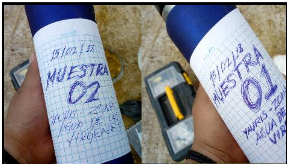
Figura 12: recolección y almacenamiento de la muestra inalterada en recipientes termo resistentes para su envío al laboratorio de los lodos residuales minerales
