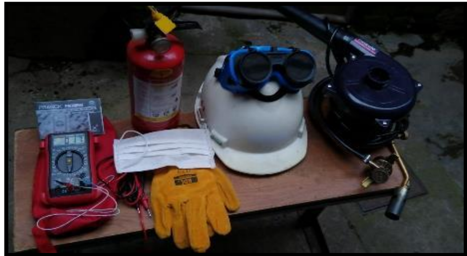
Figura 17: equipos de control y equipos de seguridad empleados para la elaboración del ensayo rudimentario de Pirometría al cual se someterán las muestras.
