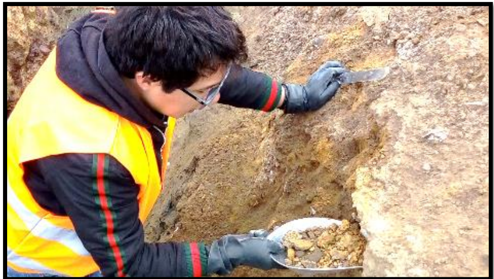
Figura 10: recolección de muestra alterada del lodo residual mineral, previa limpieza de materiales orgánicos de la superficie.
