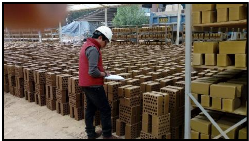
Figura 14: evaluación física visual de ladrillos refractarios de alúmina, las muestras fabricadas están apiladas en la estantería para evitar el alabeo por presión vertical.
