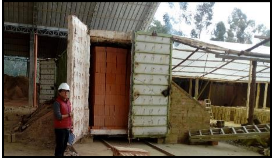
Figura 13: identificación de uno de los hornos de fabricación industrial tecnificado - Industria Cerámica Laroka E.I.R.L; aquí posteriormente se realizará la fabricación de nuestros ladrillos refractarios de alúmina.
