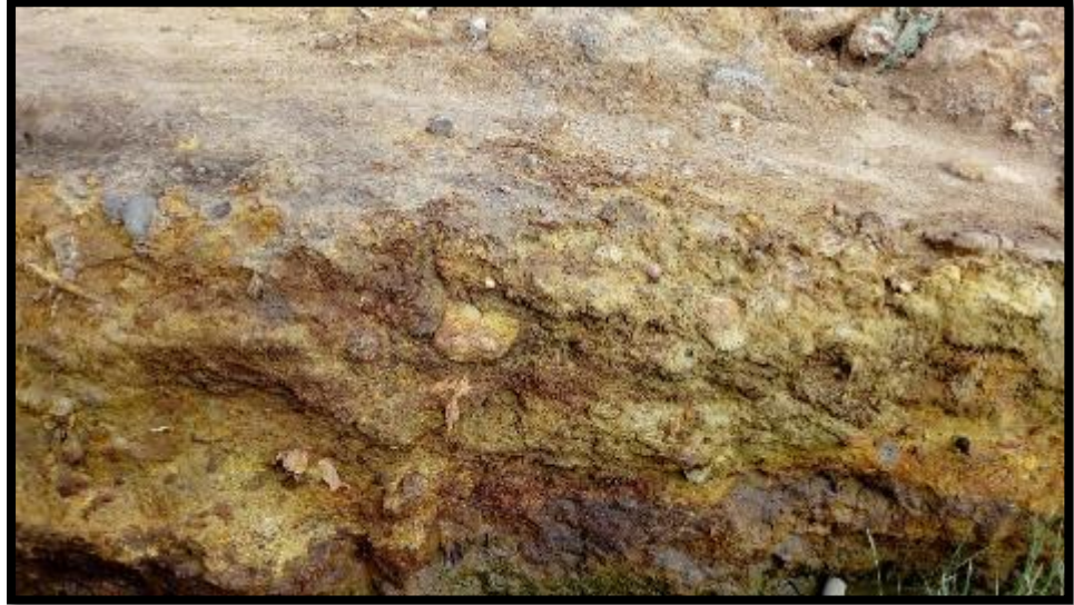
Figura 9: identificación del espesor de estratos de aproximadamente 1 m; además la identificación de coloración de óxidos.
