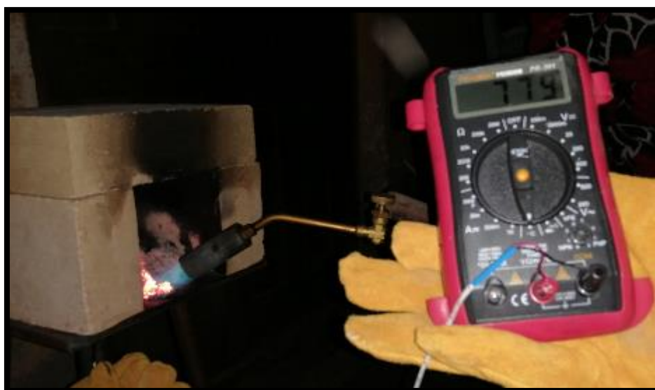
Figura 19: visualización del multímetro digital, donde se verifica la temperatura en grados centígrados (°C) interior de las muestras, punto de muestro en la parte inferior del horno, en plancha de acero.
