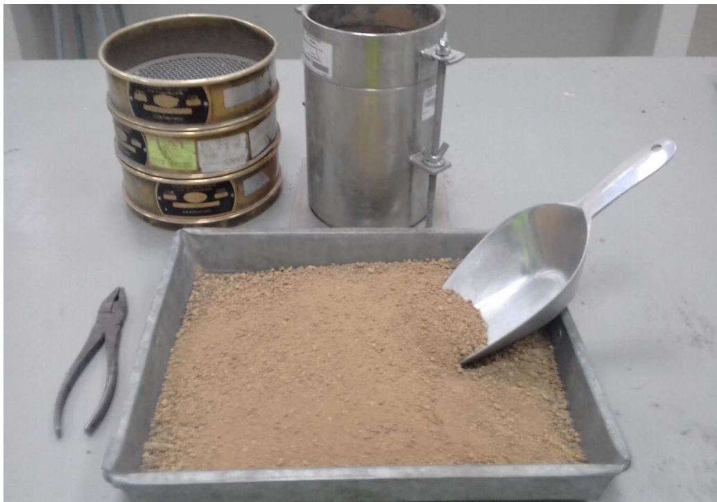
FOTO N°18: Muestra y materiales para realizar el ensayo de CBR.
