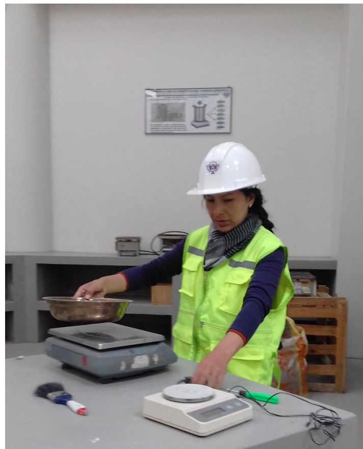
FOTO N°06: Pesando muestras para determinar la granulometría del suelo.
