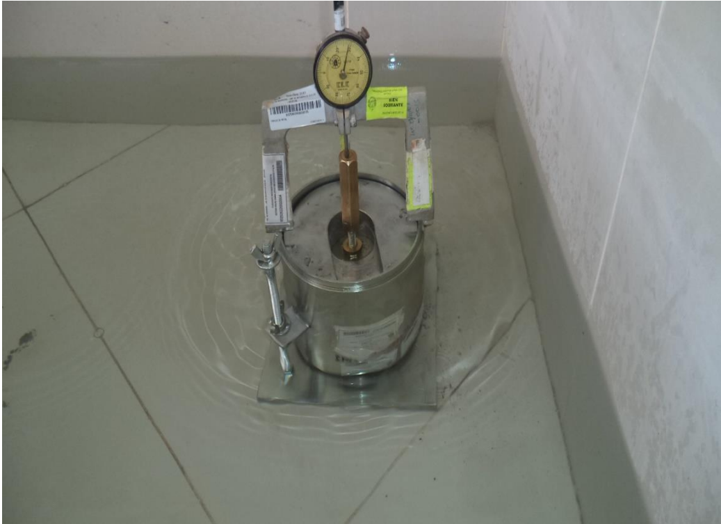
FOTO N°19: Determinando la expansividad del suelo.
