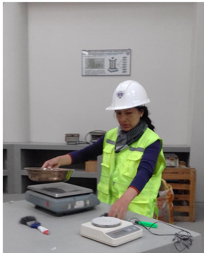
FOTO N°16: Pesando muestras para determinar la granulometría del suelo.
