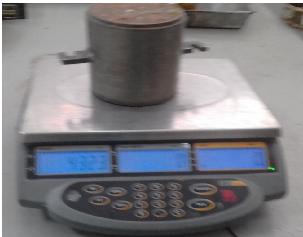
FOTO N°08: Pesando muestra compactada más molde.
