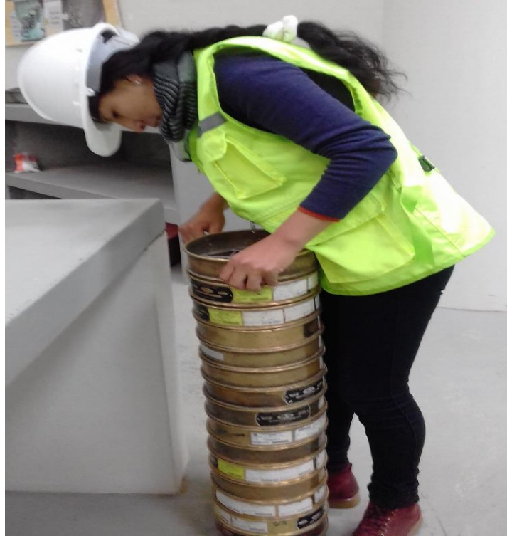
FOTO N°05: Pesando la muestra retenida por cada tamiz.
