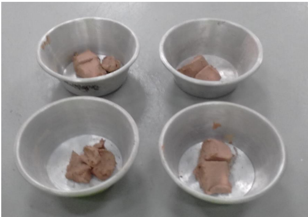
FOTO N°02: Muestras húmeda más tara, para determinar el límite líquido del suelo.
