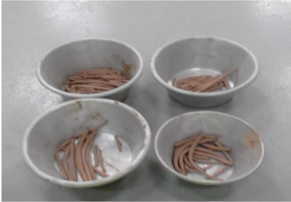
FOTO N°03: Muestras seca más tara, para determinar el límite plástico de la muestra.
