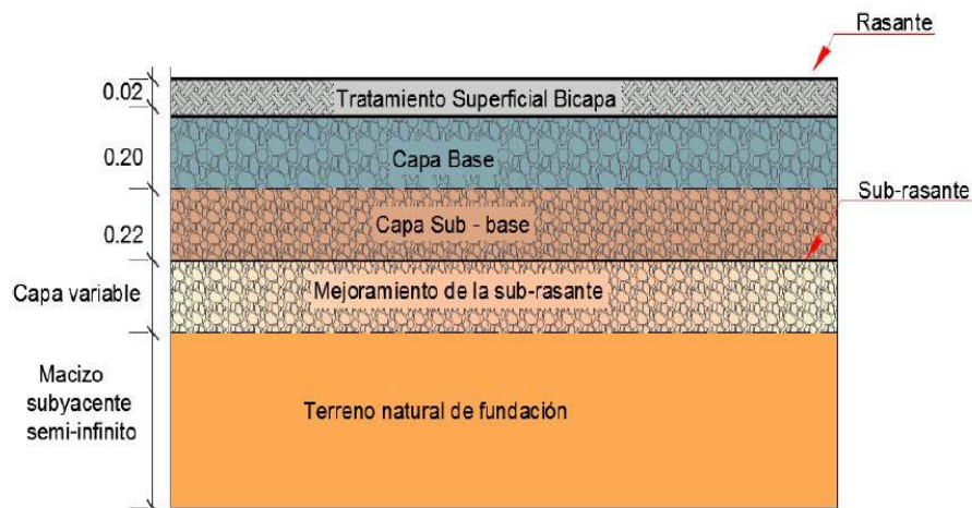
Figura 5: Sección transversal - pavimento flexible.
