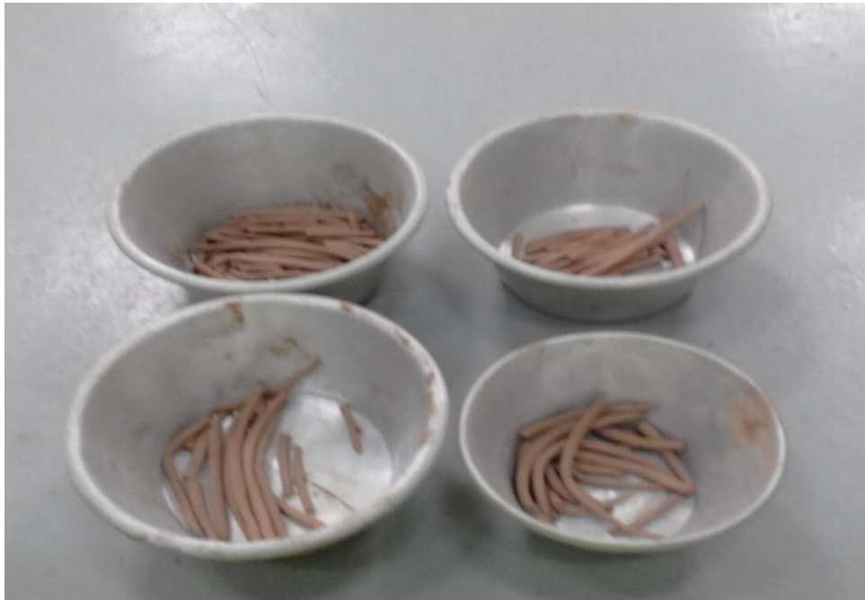
FOTO N°13: Muestras seca más tara, para determinar el límite plástico de la muestra.
