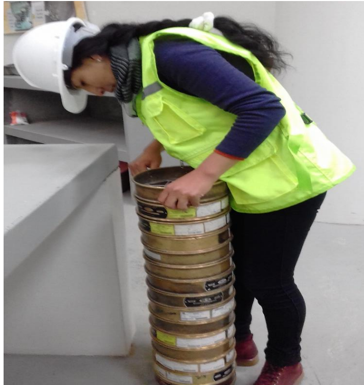
FOTO N°15: Pesando la muestra retenida por cada tamiz.
