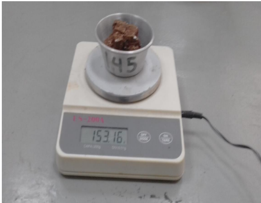
FOTO N°09: Peso de muestra más tara, para determinar el contenido óptimo de humedad
