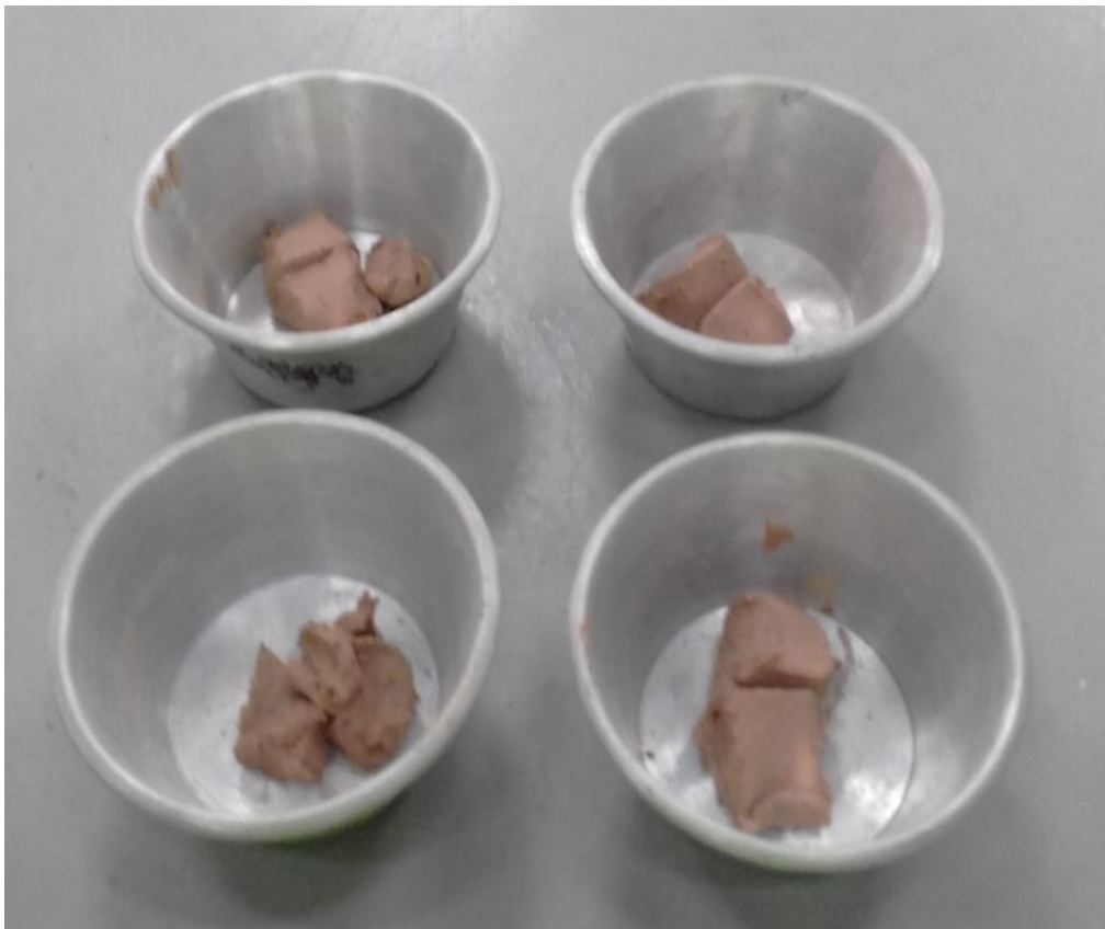
FOTO N°12: Muestras húmeda más tara, para determinar el límite líquido del suelo.
