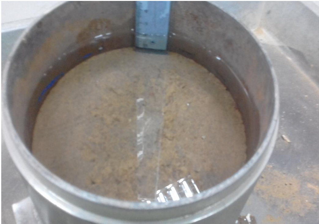
FOTO N°22: Evaluando la permeabilidad del suelo.
