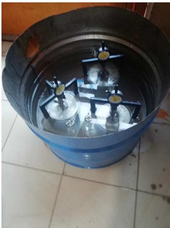
FOTO N°21: Realizando el ensayo de CBR.
