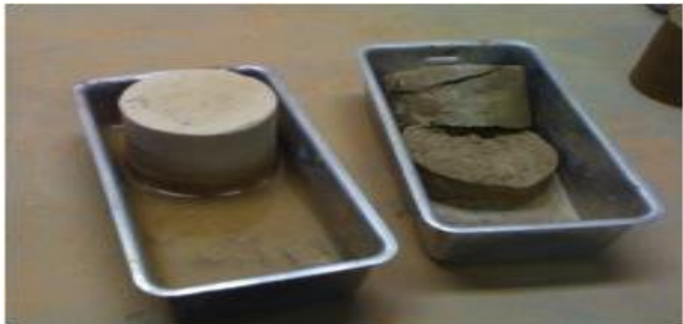
Figura 4: Absorción por capilaridad con y sin aditivo Organosilanos.
