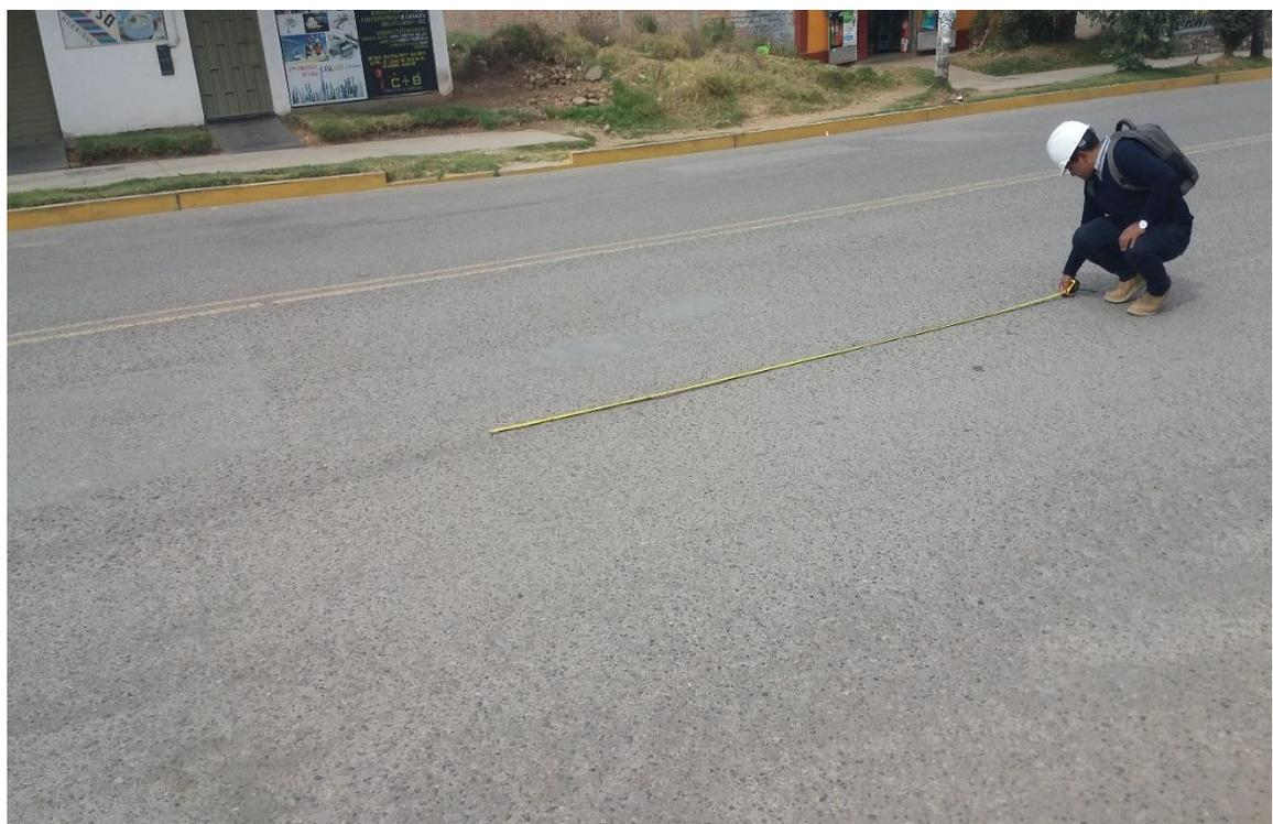
**IMAGEN N° 14. Se observa la falla de fisura longitudinal con un nivel de severidad medio**
