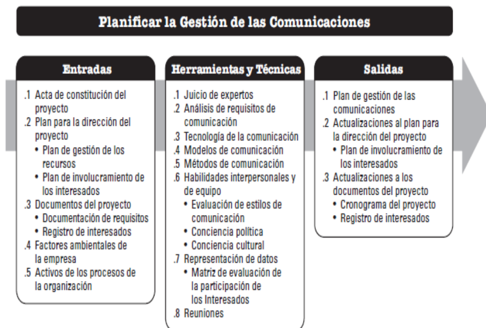
Gráfico 10-2. Planificar la Gestión de las Comunicaciones: Entradas, Herramientas y Técnicas, y Salidas
