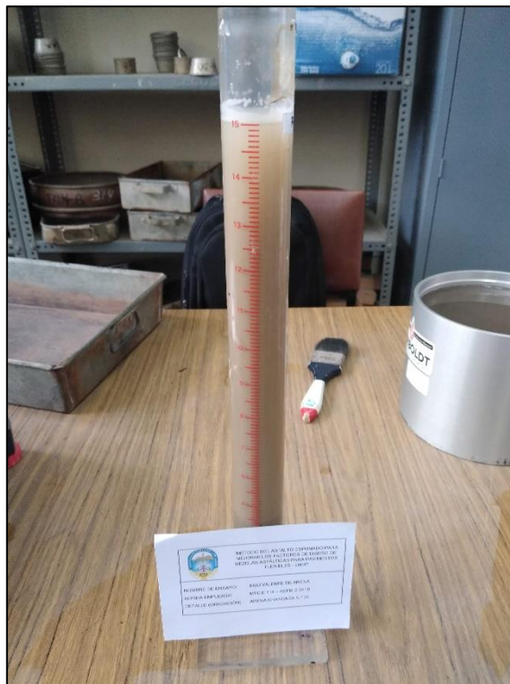
Fotografía 22: Equivalente de arena
