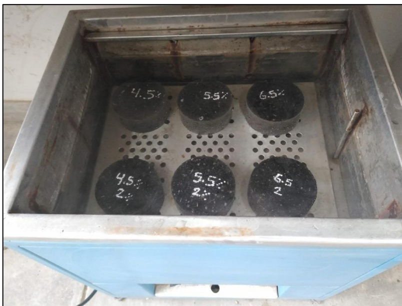
Fotografía 44: Colocación de briquetas en baño de agua a 60 °C
