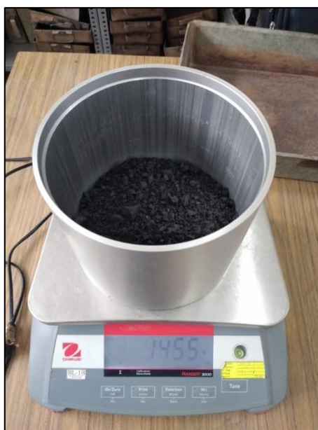
Fotografía 47: Pesado de mezcla asfáltica - Rice
