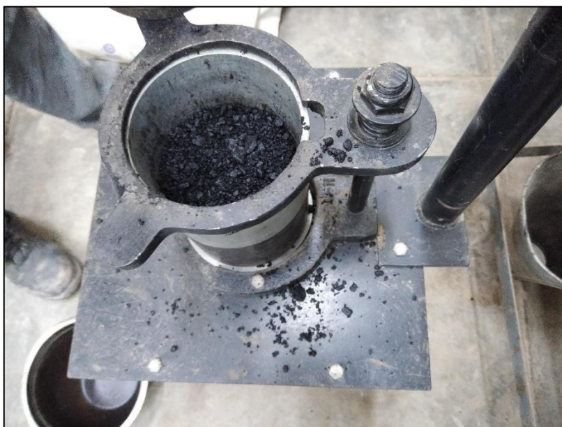
Fotografía 33: Chuseado de mezcla asfáltica en el molde ensamblado
