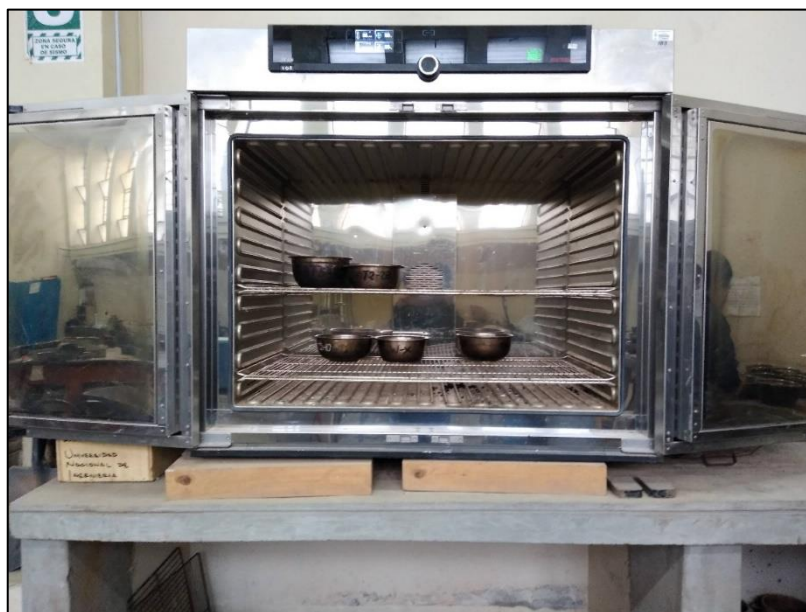
Fotografía 24: Calentamiento de los agregados en el horno
