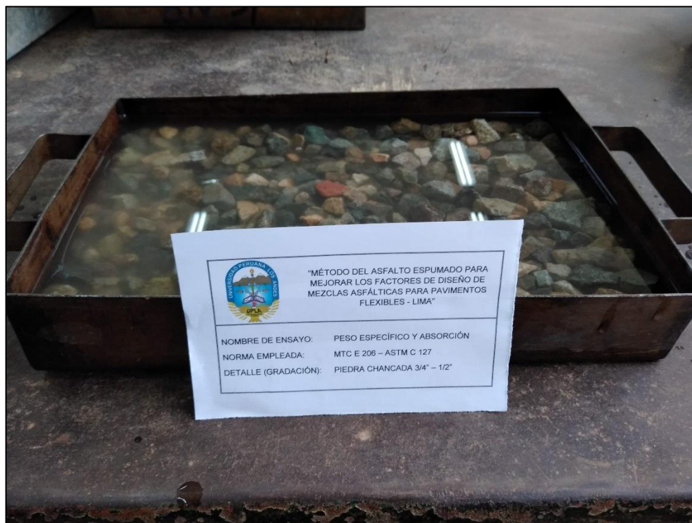
Fotografía 14: Ensayo de peso específico y absorción de agregados gruesos
