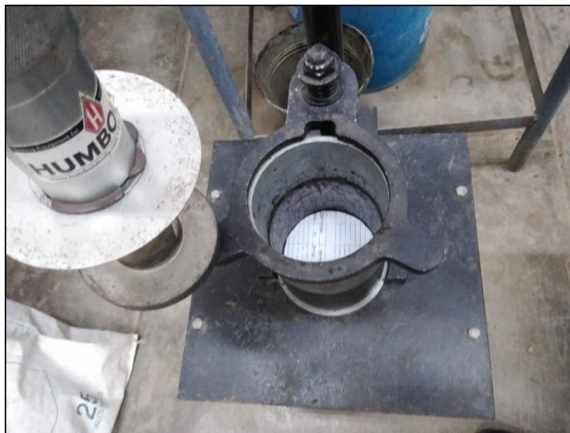
Fotografía 31: Preparación del martillo de compactación Marshall
