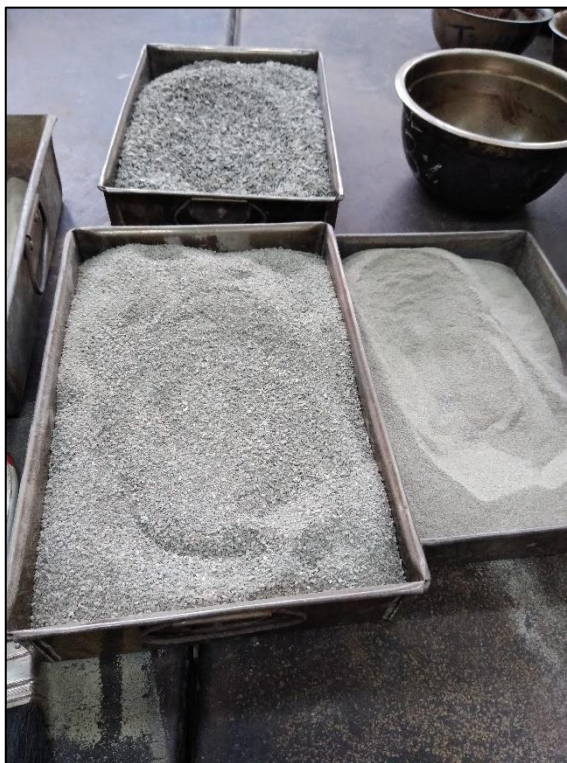
Fotografía 12: Ensayo de granulometría del agregado fino
