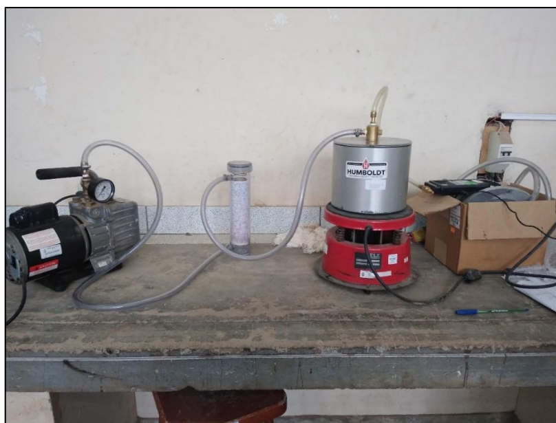
Fotografía 49: Remoción del aire atrapado a 30 mm de Hg
