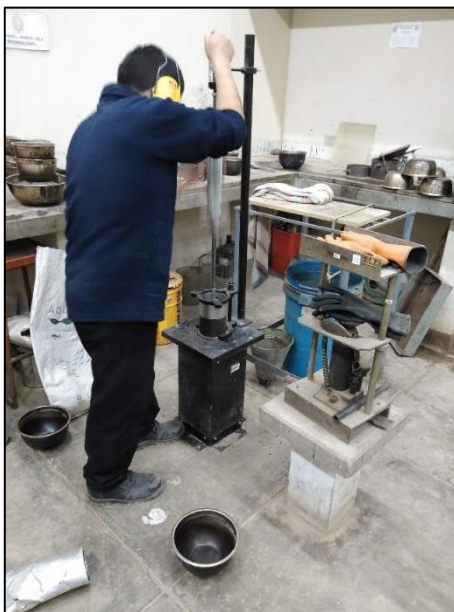
Fotografía 35: Proceso de compactación de los especímenes
