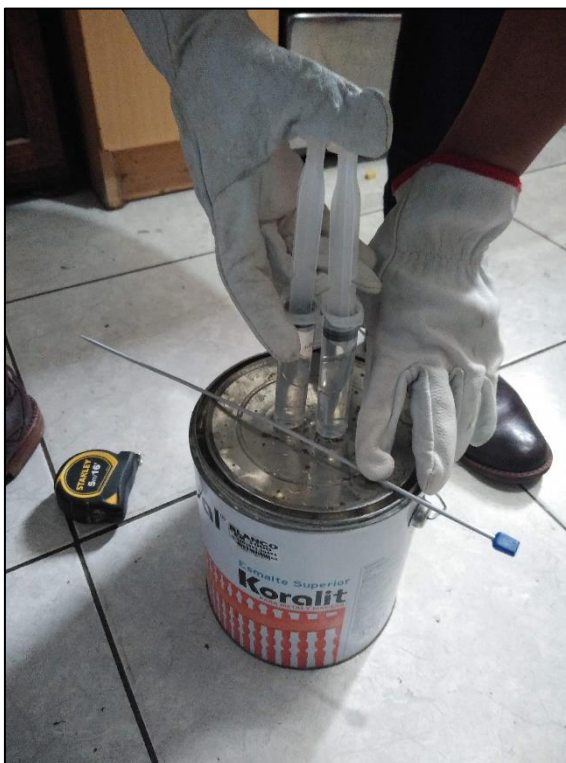
Fotografía 5: Inyección de agua fría al asfalto caliente
