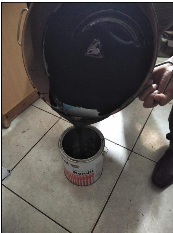
Fotografía 4: Cemento asfáltico caliente a 130 °C
