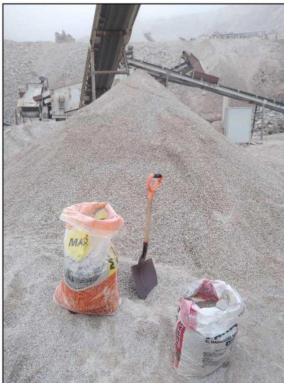
Fotografía 3: Acopio de agregado fino - cantera La Gloria
