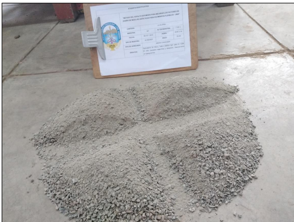
Fotografía 9: Selección de muestra representativa del agregado fino
