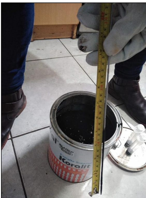
Fotografía 7: Medida del volumen de máxima expansión
