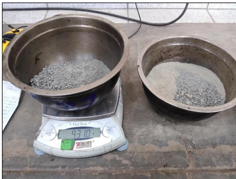
Fotografía 25: Dosificación de agregados
