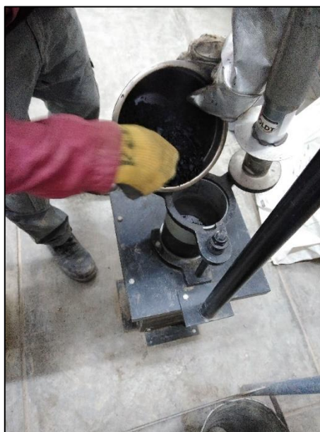
Fotografía 32: Introducción de la mezcla asfáltica en el molde ensamblado
