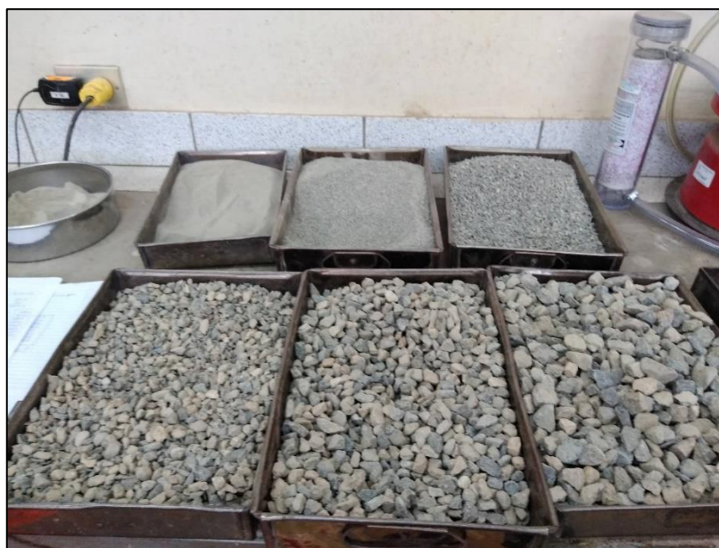
Fotografía 23: Fraccionamiento del agregado grueso y agregado fino
