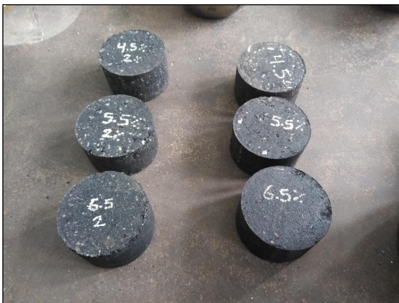
Fotografía 38: Desmolde y extracción de los especímenes
