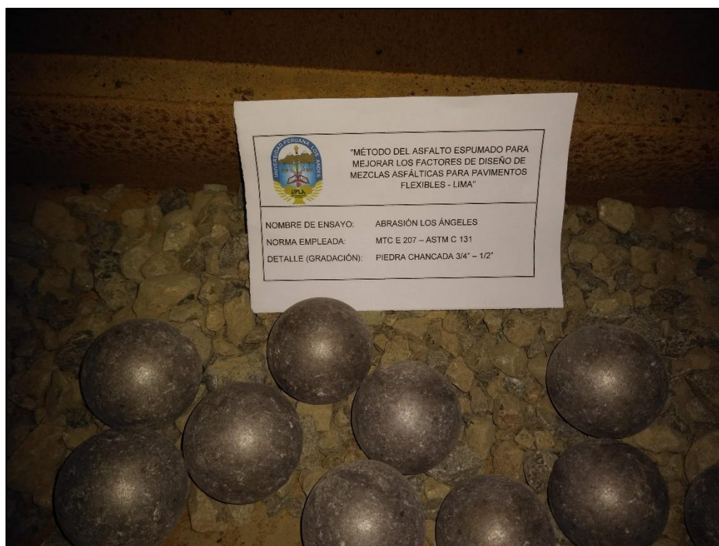
Fotografía 17: Abrasión en la máquina de Los Ángeles
