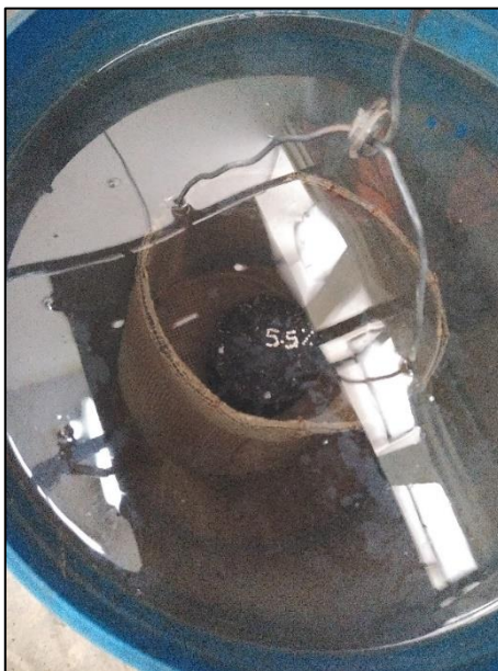
Fotografía 43: Peso de la briqueta superficialmente saturado en el agua
