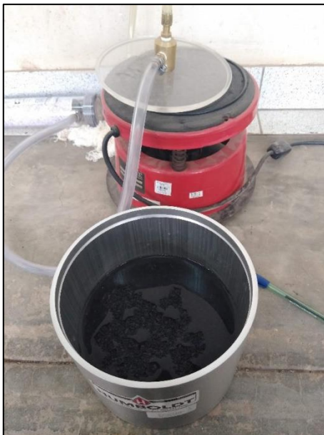
Fotografía 48: Adición de agua a la mezcla - Rice
