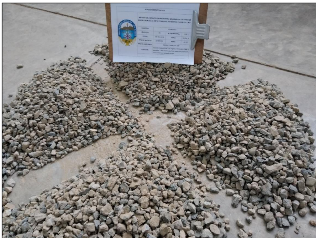
Fotografía 8: Selección de muestra representativa del agregado grueso
