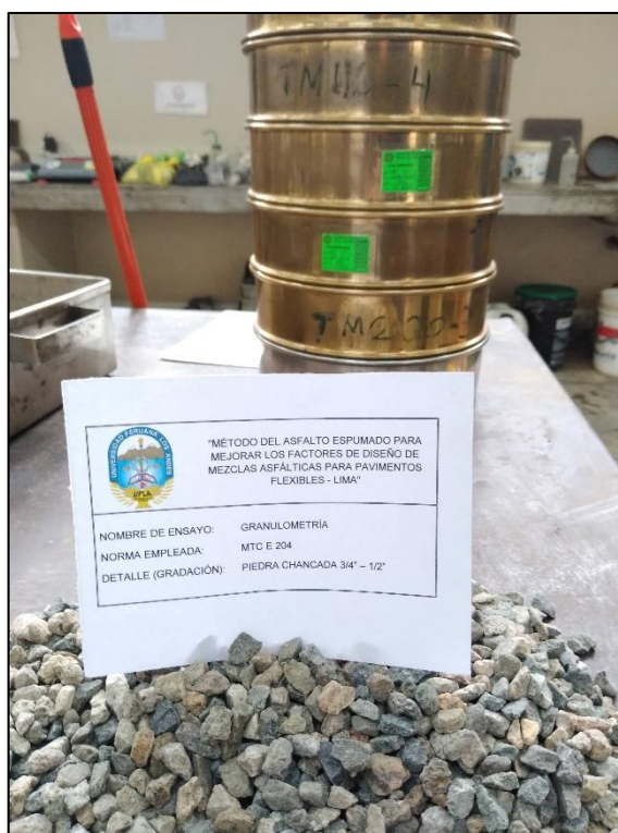
Fotografía 11: Ensayo de granulometría del agregado grueso
