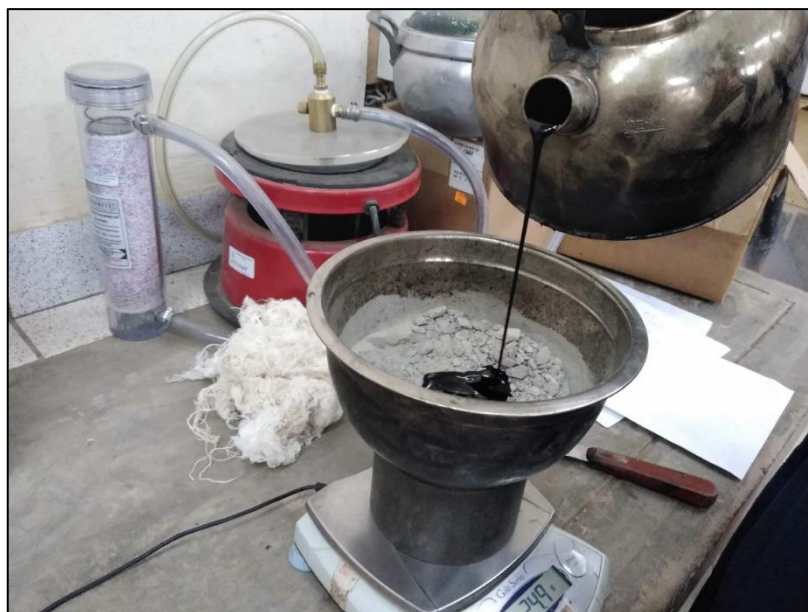
Fotografía 27: Dosificación de cemento asfáltico
