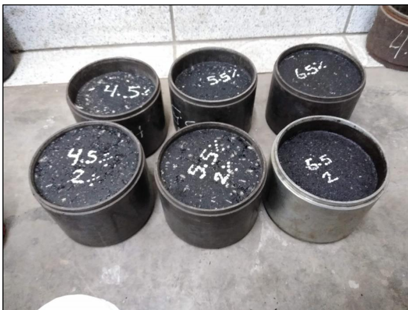
Fotografía 37: Elaboración de briquetas finalizado
