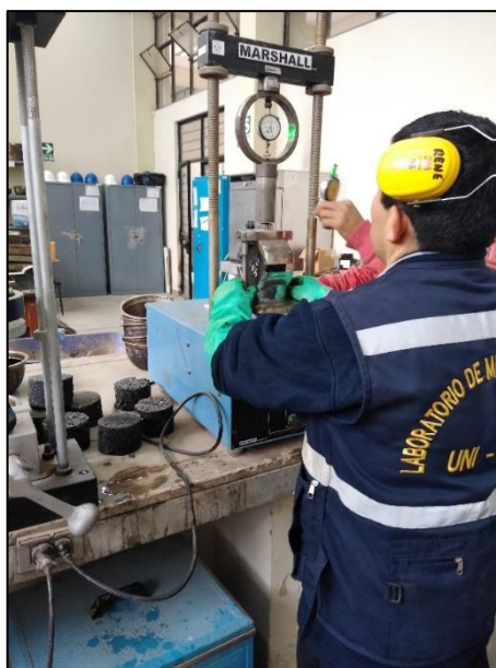
Fotografía 45: Medición de Estabilidad y Flujo en la Máquina Marshall
