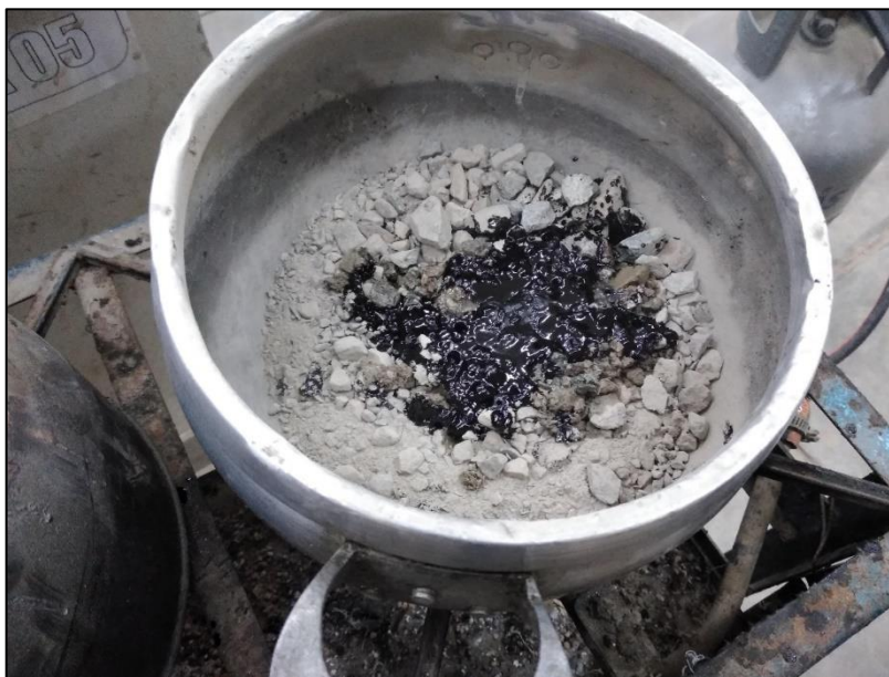
Fotografía 29: Proceso de espumación del cemento asfáltico
