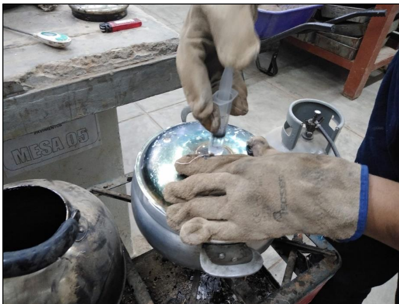
Fotografía 28: Inyección de agua fría en el asfalto caliente
