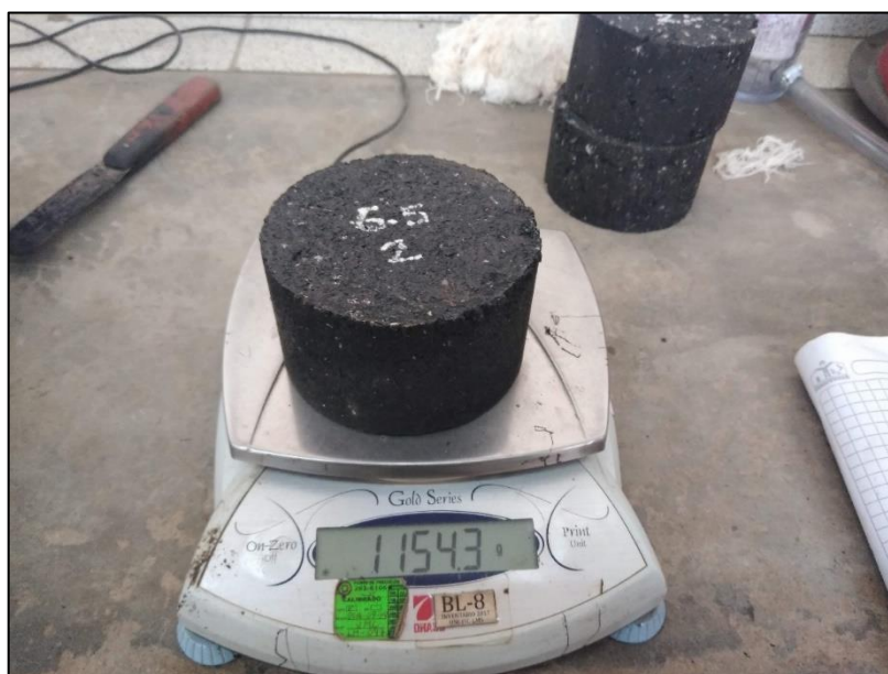
Fotografía 40: Peso de la briqueta en el aire
