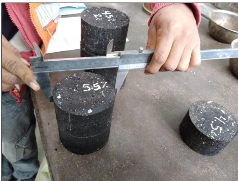
Fotografía 39: Medición de las dimensiones de cada briqueta
