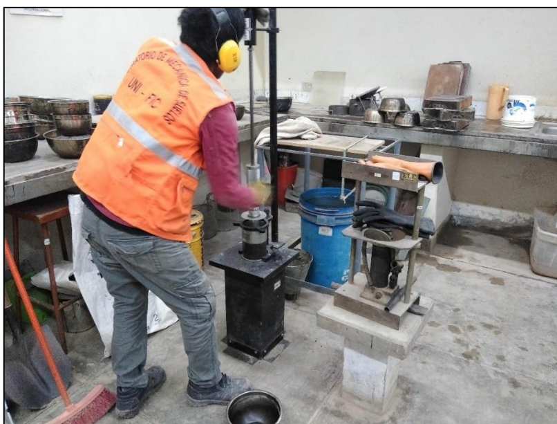
Fotografía 34: Compactación de los especímenes a 75 golpes
