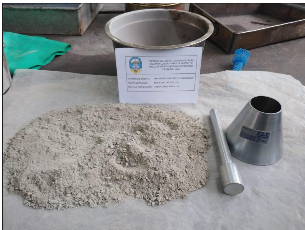
Fotografía 13: Ensayo de gravedad específica y absorción de agregados finos
