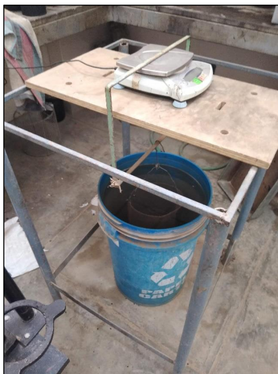
Fotografía 15: Equipos para el peso específico y absorción de agregados gruesos
