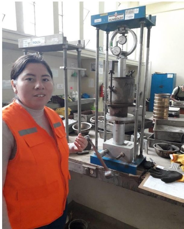
Foto N°06: Realizando el ensayo California Bearing Ratio (C.B.R.) Fuente: Propia
