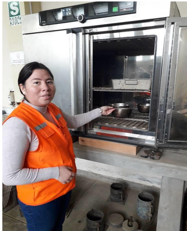
Foto N°04: Poniendo la muestra en el horno y determinar el peso específico Fuente: Propia
