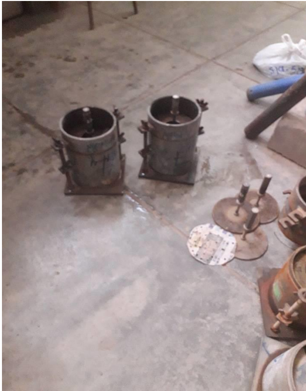
Foto N°05: Realizando el Ensayo Próctor Modificado Fuente: Propia
