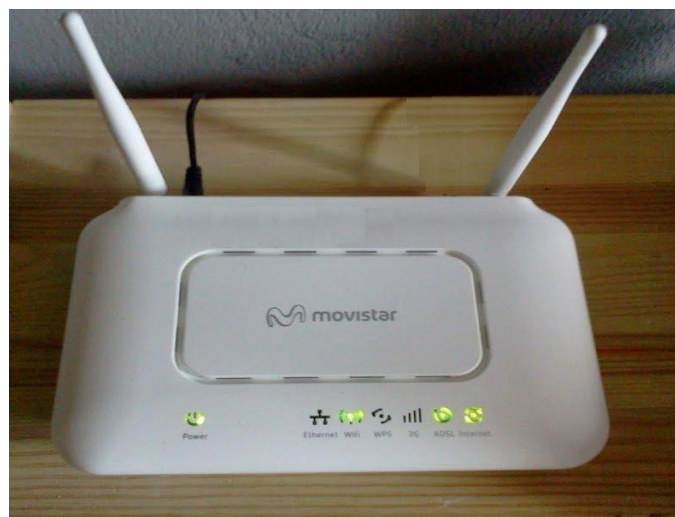
Figura 17. Modem ADSL, Equipo Modelo proporcionado por proveedor Movistar
