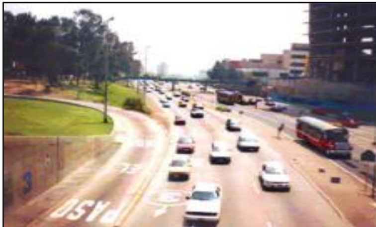
Figura 14: Condiciones de operación de los niveles de servicio, Nivel de Servicio D. Fuente: Manual de Diseño Geométrico de Vías Urbanas - 2005 del Instituto de la Construcción y Gerencia ICG.
