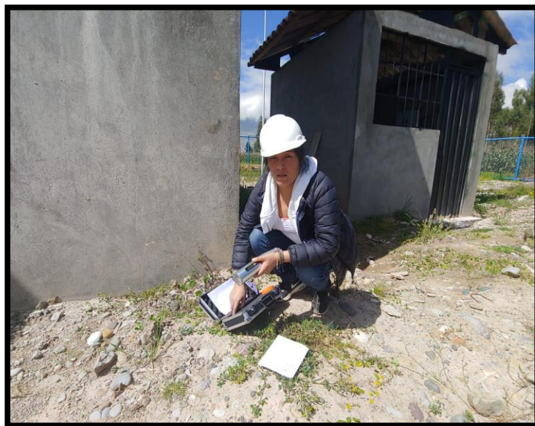
Fotografía 5.- Calculo de resistencia con el Esclerómetro
