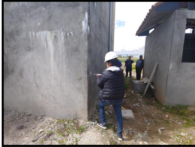
Fotografía 6.- Cálculo de la resistencia en el PTAR N°02
