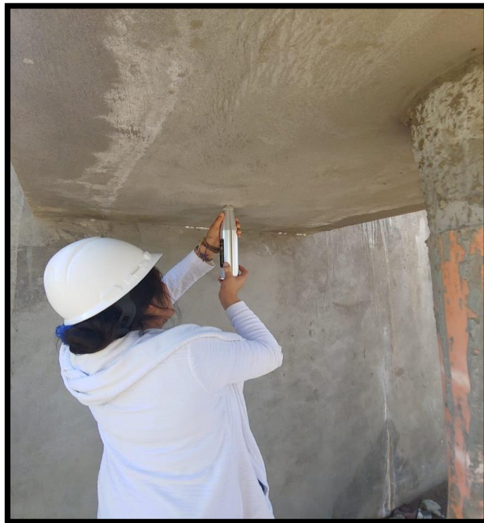
Fotografía 10.- Calculo de la resistencia en el Filtro Biológico del PTAR N°02
