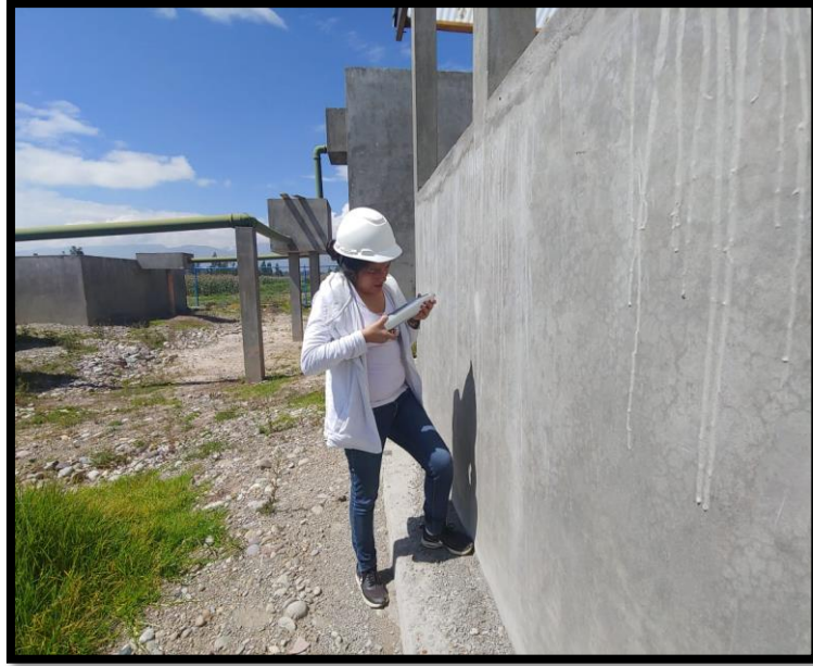
Fotografía 8.- Lectura del ensayo del esclerómetro en el lecho de secado
