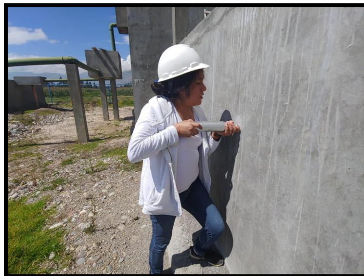
Fotografía 7.- Calculo de la resistencia en el lecho de Secado
