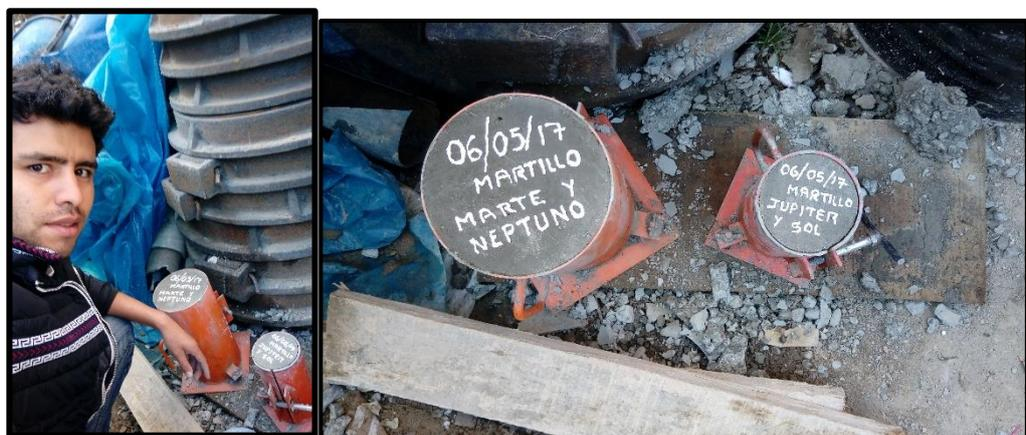
sumergido en el agua durante 18 a 24 horas como lo menciona la norma ASTM C31.
