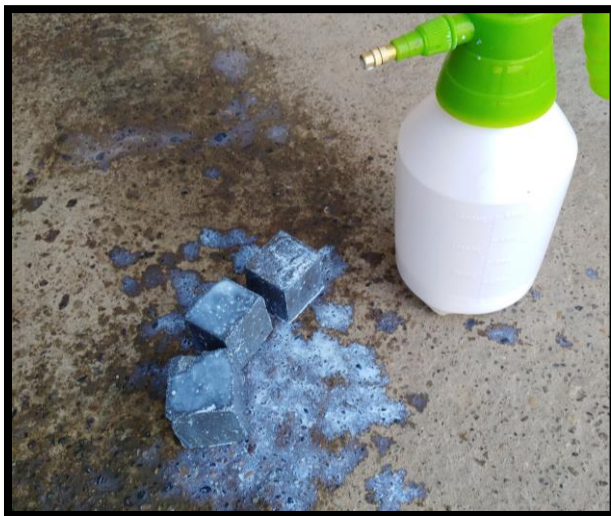
Figura N° 24 Los cubos de mortero con medidas de 5cm en sus 3 caras fueron curadas con el aditivo súper Chema curador
