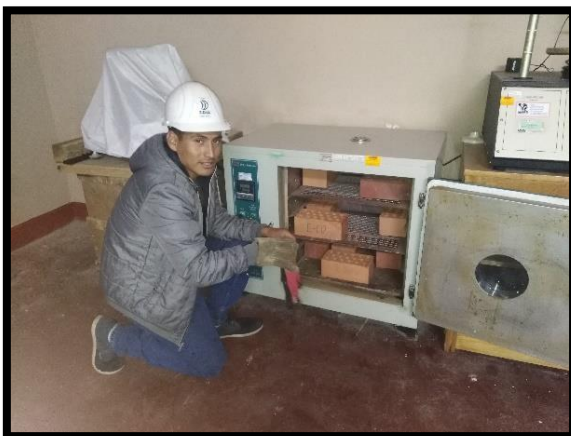
Figura N° 03 Pasado las 24 horas se procedió al enfriar por un periodo de 4 horas.
