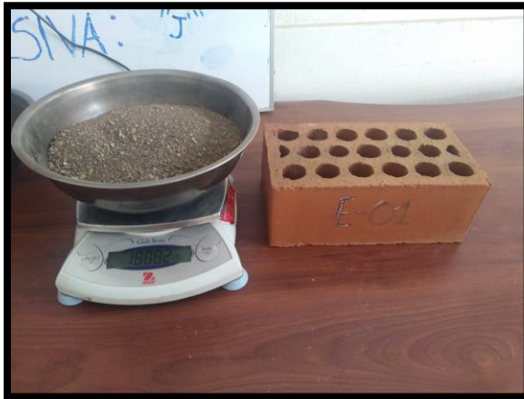
Figura N° 14 Se procedió a pesar la arena contenida en las perforaciones de la unidad de albañilería. Para luego ser registradas en la hoja de apuntes.
