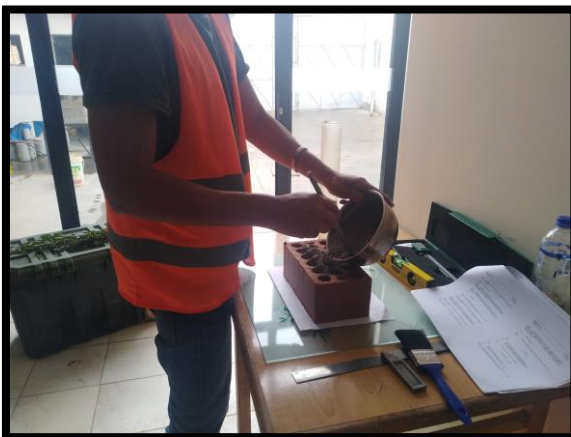
Figura N° 12 Para el ensayo de porcentaje de vacíos se rellenó con arena los huecos de cada unidad de albañilería y luego pesadas individualmente.
