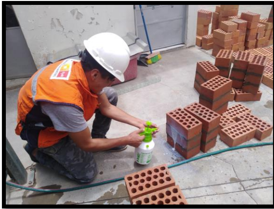
Figura N° 22 Se seccionaron 8 pilas para ser curadas con el aditivo súper chema curador.
