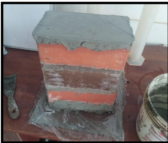
Figura N° 27 El refrentado se realizó con yeso y cemento con una proporción de 1:1 24 horas antes de ser ensayadas a compresión axial.
