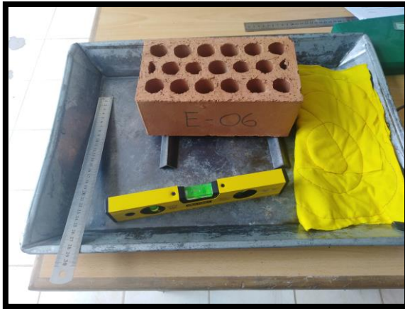
Figura N° 10 Para el ensayo de succión se utilizaron una bandeja, un nivel de mano, una regla metálica y un trapo para el secado.
