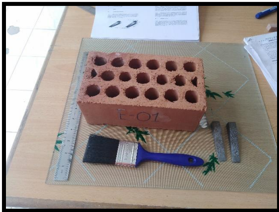
Figura N° 05 En esta imagen podemos apreciar los aparatos utilizados para el ensayo de medida de alabeo los cuales son:
