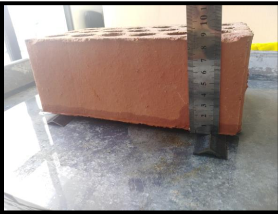
Figura N° 11 Con una regla metálica se controló que el agua este por encima de las balas de soporte a una distancia de 1 cm.
