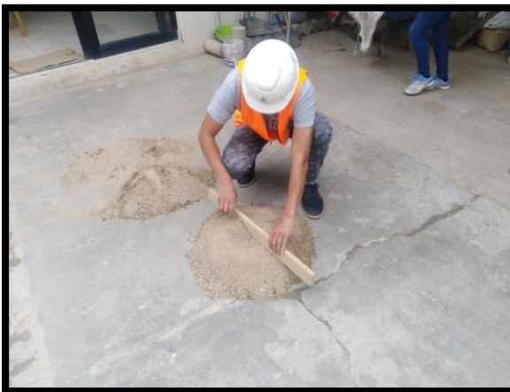
Figura N° 15 En esta figura procedimos hacer el cuarteo del agregado grueso para el ensayo de granulometría. Este material fue extraído de la cantera de Pilcomayo.
