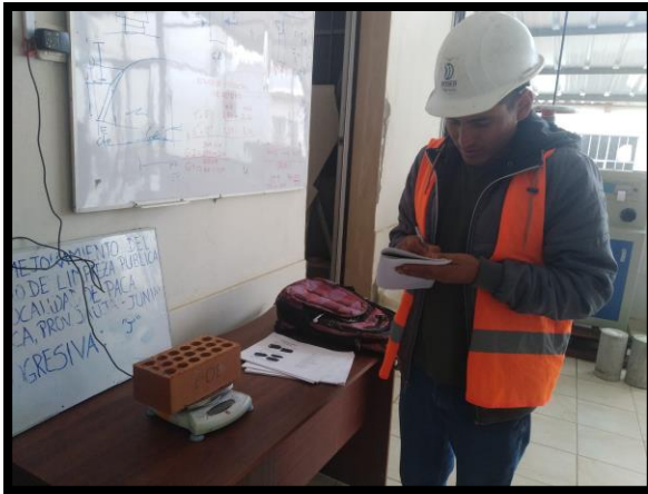
Figura N° 07 Las unidades de albañilería fueron pesadas individualmente y registradas en la hoja de apuntes.
