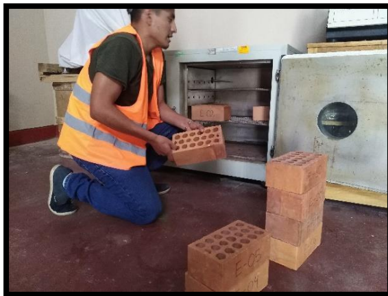
Figura N° 02 Las unidades representativas de llevaron al horno para su respectivo secado por 24 horas a una temperatura de 110 °C
