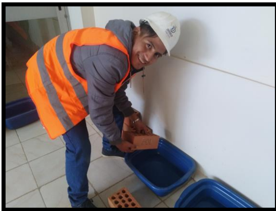
Figura N° 08 Para el ensayo de absorción los especímenes fueron parcialmente sumergidas en agua limpia por 24 horas.
