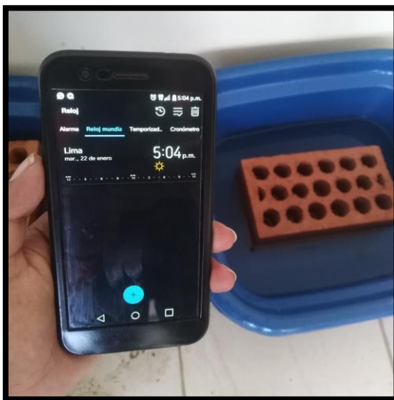
Figura N° 09 Pasado las 24 horas los ladrillos fueron retirados de su respectiva bandeja y secadas con un trapo para luego ser pesadas individualmente.
