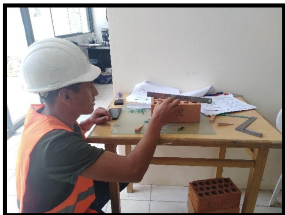
Figura N° 06 En este ensayo se identificaron y midieron las superficies cóncavas y convexas ayudados de una regla metálica con superficie plana.
