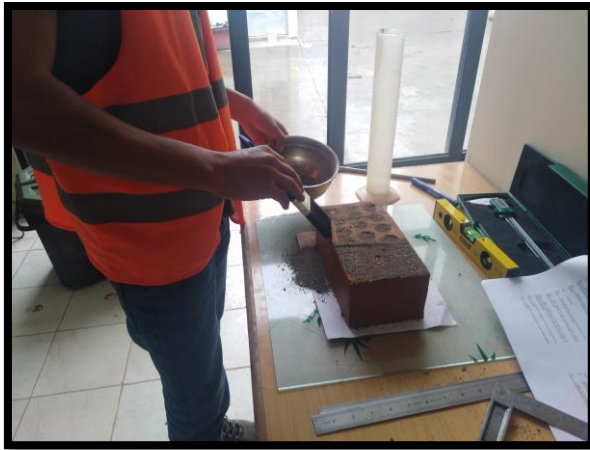
Figura N° 13 Después del llenado con arena, se procedió a limpiar la superficie con una brocha con el fin de eliminar el exceso de arena.
