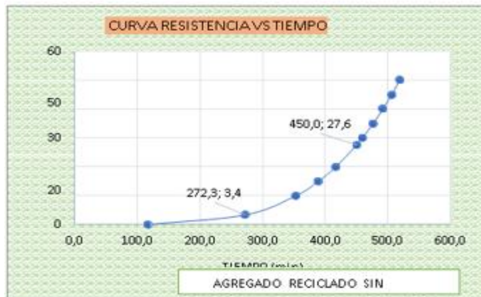
Figura 12. Tiempo de fraguado del concreto con f'c : 210 kg/cm 2 con agregado reciclado sin aditivo.
