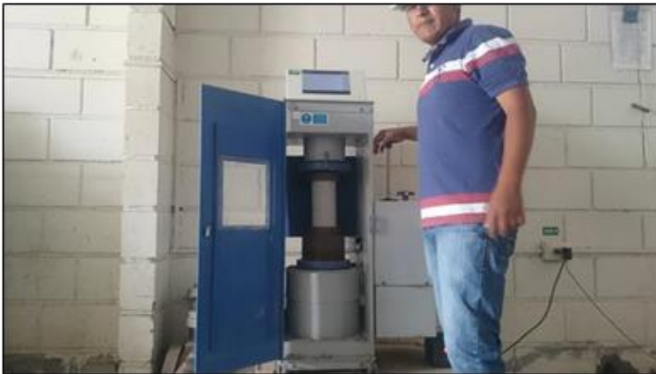
Fotografía 16. Evaluación de la resistencia a la compresión del concreto.
