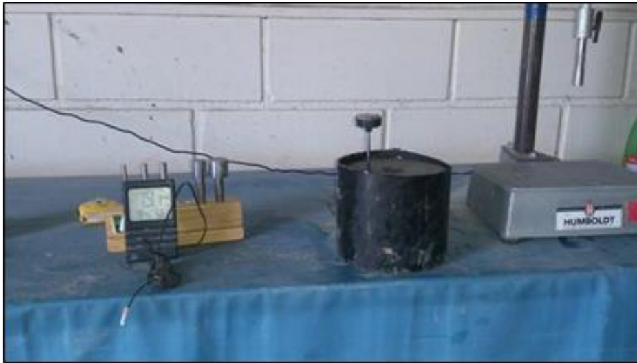
Fotografía 15. Evaluación del tiempo de fragua del concreto.
