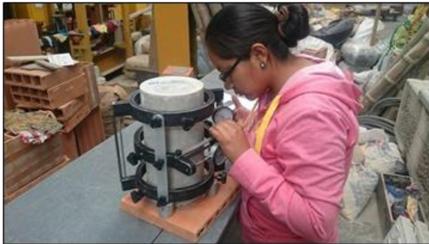
Fotografía 18. Estimación de la elasticidad del concreto.
