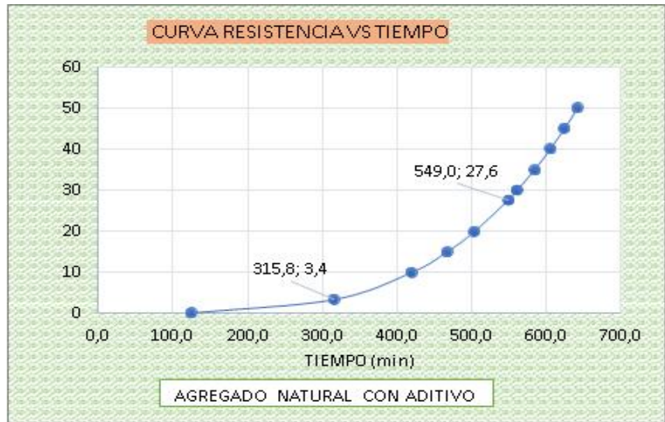
Figura 11. Tiempo de fraguado del concreto con f'c : 210 kg/cm 2 con agregado natural con aditivo.
