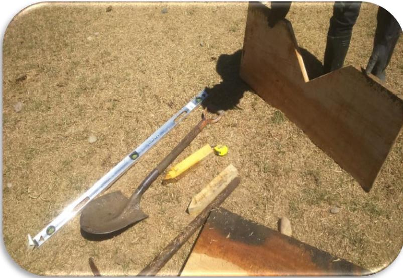
MATERIALES UTILIZADOS PARA DETERMINAR EL CAUDAL DEL AGUA RESIDUAL, USANDO EL MÉTODO DE VERTEDERO TRIANGULAR, ENTRE ELLAS VERTEDERO, NIVEL, ESTACA, FLEXOMETRO, LAMPA, PICO, YESO, GUANTES, TAPA BOCA, BOTAS DE JEBE, CASCO.
