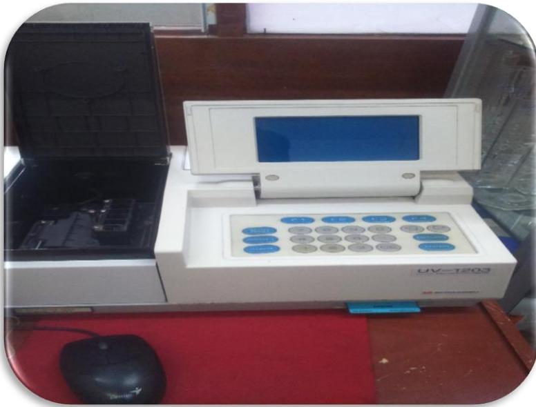
SE UTILIZO EL ESPECTROFOTÓMETRO PARA LEER LA CONCENTRACIÓN DE LA DQO EN LOS LABORATORIOS DEL A UNCP.
