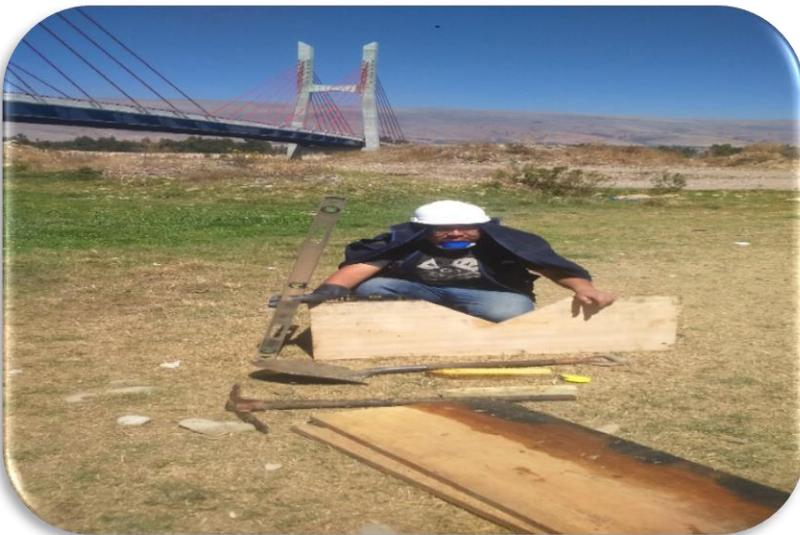
SE OBSERVA LOS MATERIALES PARA EL CALCULO DEL CAUDAL CON EL VERTEDERO TRIANGULAR CON MEDIDAS DE MADERA DE 1M (LARGO) \* 0.60 M (ALTO), CON UNA ABERTURA DE 90°
