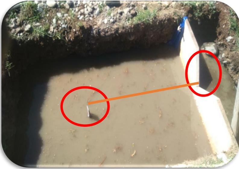
SE COLOCA A 1 METRO DE DISTANCIA DEL VERTEDERO TRIANGULAR A LA BASE DE LA ABERTURA DEL TRIÁNGULO QUE ESTA BIEN NIVELADO.
