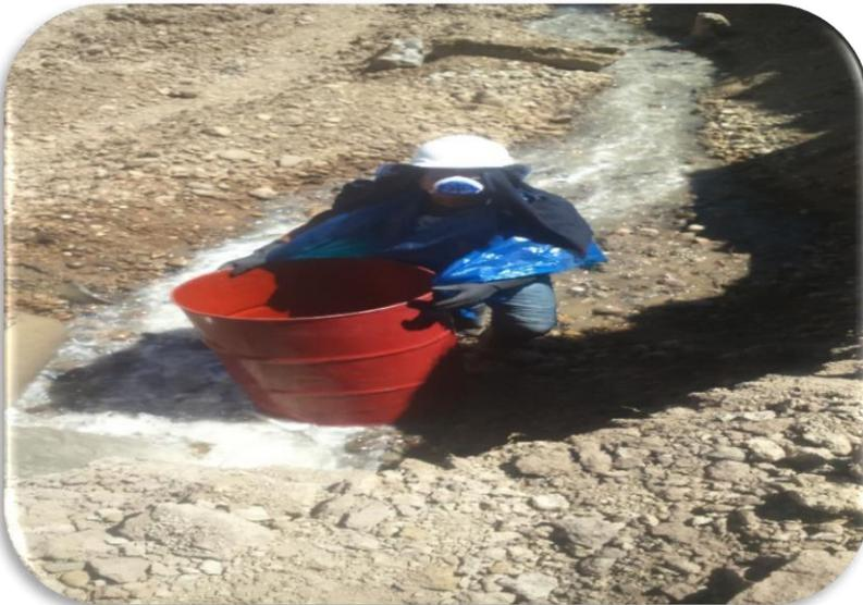
NOS UBICAMOS EN EL PUNTO PARA DETERMINAR EL CAUDAL, APOYADOS CON EL CILINDRO Y LOS RESPECTIVOS MATERIALES.
