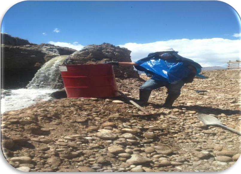
SE UTILIZO UN SEGUNDO ÉETODO PARA DETERMINAR EL CAUDAL, EL AFORO SE UTILIZARON UN CILINDRO, CRONOMETRO, GUANTES, MASCARILLA, CASCO, BOTAS, LIBRETA DE APUENTES. TODO EN EL ANEXO DE AUQUIMARCA EN EL BARRIO LA PAMPA.
