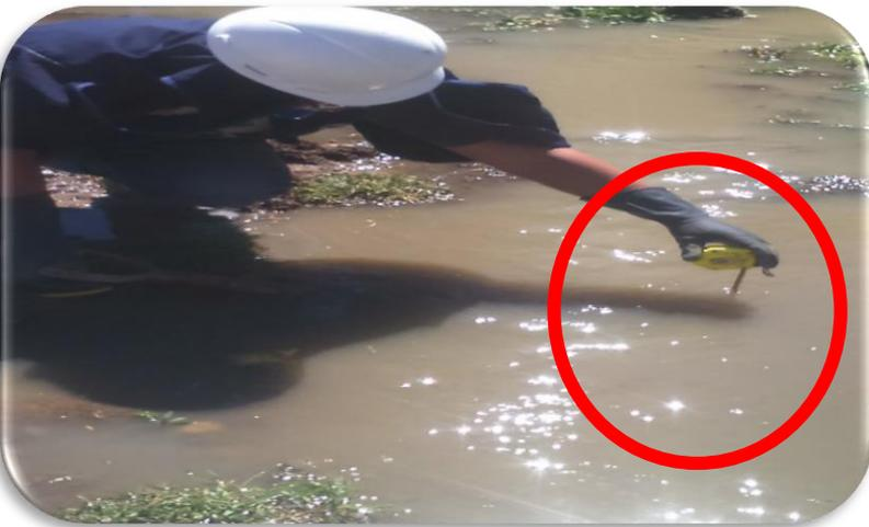
LUEGO DE QUE ESTA CORRECTAMENTE NIVELADO EN VERTEDERO TRIANGULAR, PROCEDIMOS A DESVIAR EL AGUA RESIDUAL Y SE TOMO LAS MEDIDAS CUANDO SUBIO EL AGUA POR LA ABERTURA DEL VERTEDRO Y SE MANTUVO CONSTANTE.
